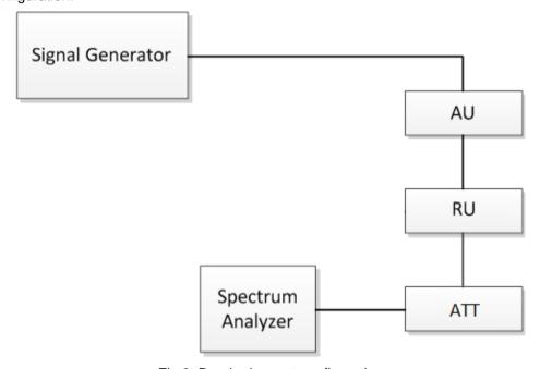
Fig.3. Band edge test configuration
