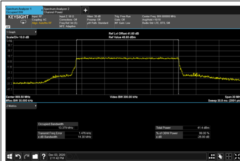
Figure 379: QPSK 15MHz B.W.; 869.5MHz Output 4G
