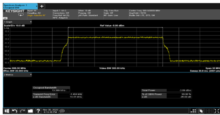
Figure 340: 64QAM 15MHz B.W.; 869.5MHz Input 4G
