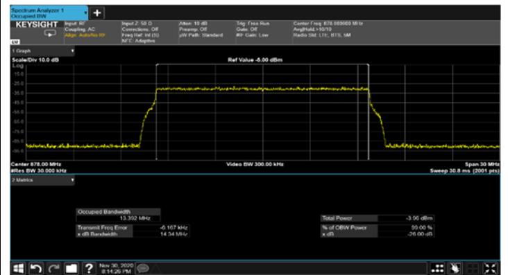
Figure 341: 64QAM 15MHz B.W.; 878.0MHz Input 4G
