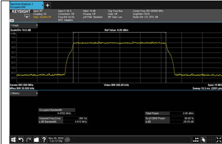
Figure 345: QPSK 5MHz B.W.; 891.5MHz Input 4G
