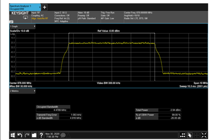
Figure 344: QPSK 5MHz B.W.; 878.0MHz Input 4G
