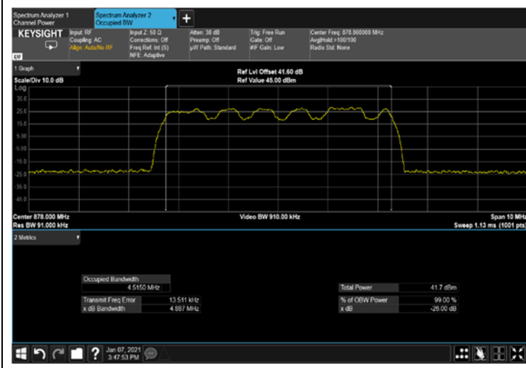
Figure 306: QPSK 5MHz B.W.; 891.5MHz, 15kHz OUTPUT
