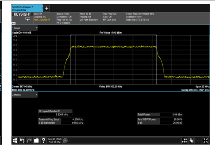
Figure 346: QPSK 10MHz B.W.; 867.0MHz Input 4G
