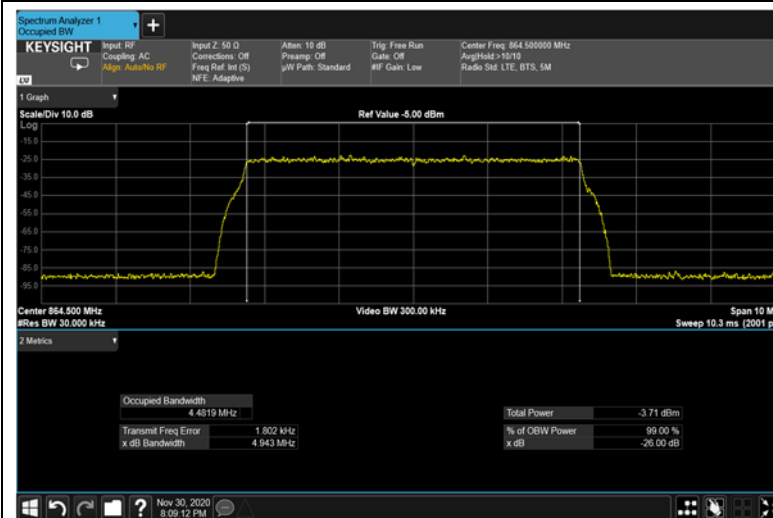
Figure 334: 64QAM 5MHz B.W.; 864.5MHz Input 4G
