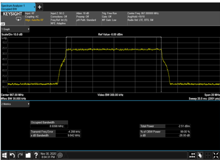
Figure 328: 16QAM 10MHz B.W.; 867.0MHz Input 4G
