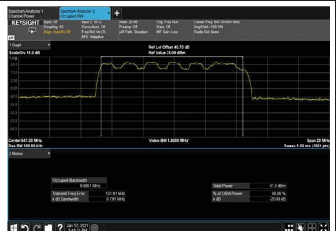
Figure 443: QPSK 10MHz B.W; 647.0MHz, 30kHz Output
