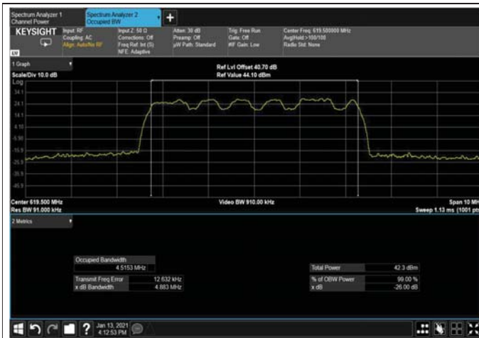
Figure 432: QPSK 5MHz B.W; 619.5MHz, 15kHz Output
