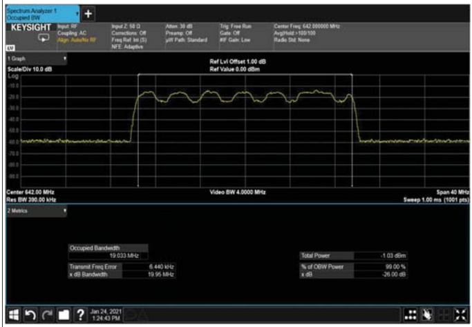
Figure 358: QPSK 20MHz B.W; 642.0MHz, 15kHz Input
