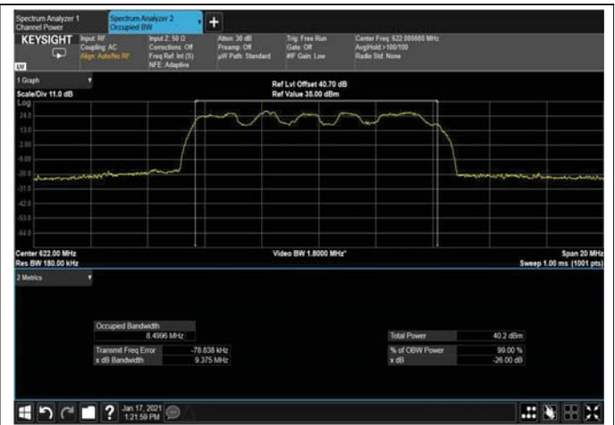
Figure 439: QPSK 10MHz B.W; 622.0MHz, 30kHz Output
