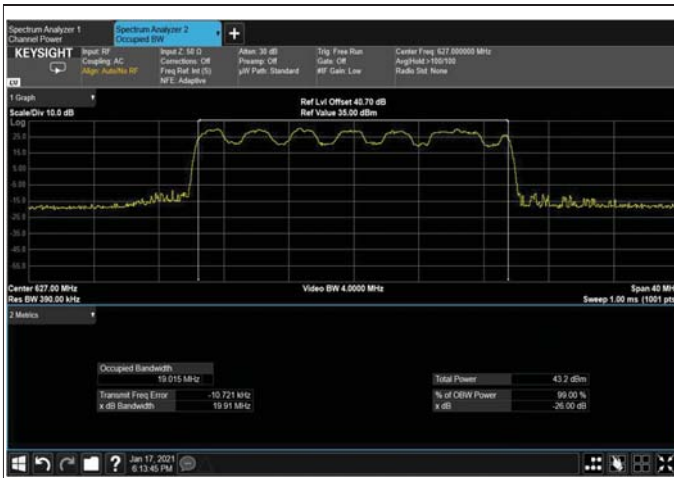
Figure 450: QPSK 20MHz B.W; 627.0MHz, 15kHz Output
