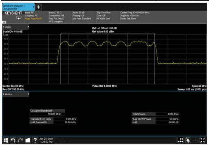
Figure 356: QPSK 20MHz B.W; 634.5MHz, 15kHz Input
