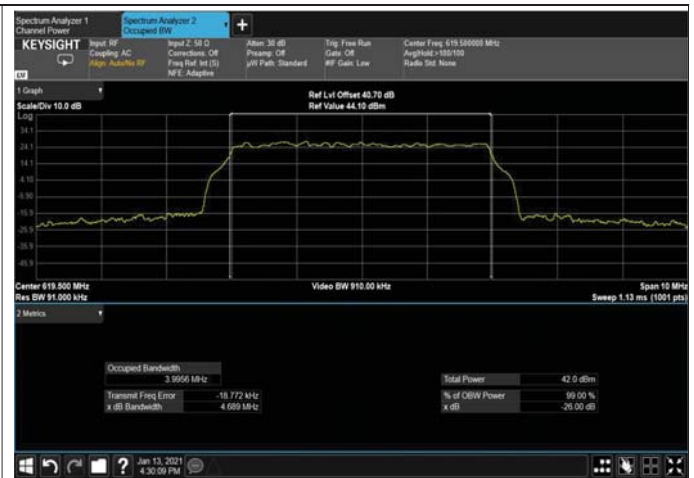
Figure 385: 64QAM 5MHz B.W; 619.5MHz, 30kHz Output
