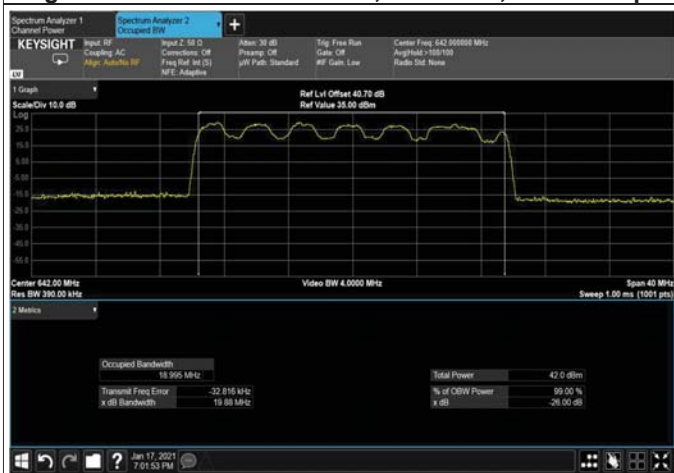
Figure 454: QPSK 20MHz B.W; 642.0MHz, 15kHz Output
