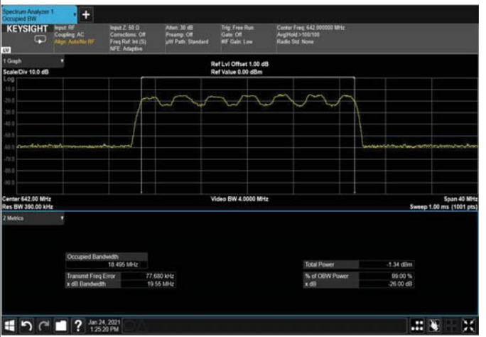
Figure 359: QPSK 20MHz B.W; 642.0MHz, 30kHz Input
