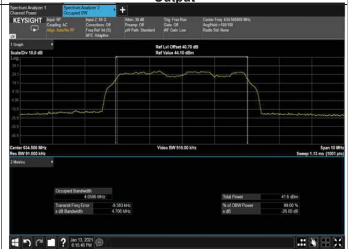
Figure 363: 16QAM 5MHz B.W; 634.5MHz, 30kHz Output
