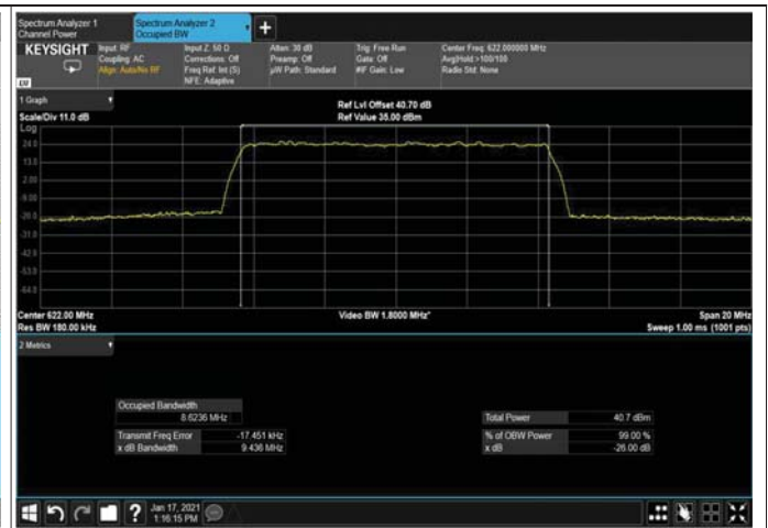
Figure 391: 64QAM 10MHz B.W; 622.0MHz, 30kHz Output
