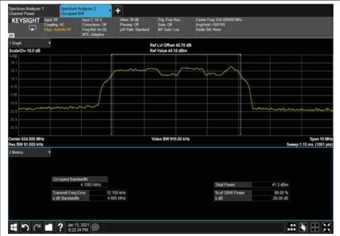
Figure 435: QPSK 5MHz B.W; 634.5MHz, 30kHz Output
