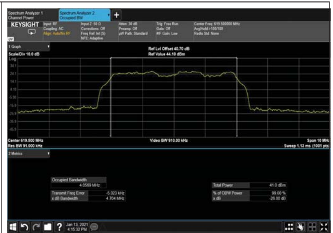
Figure 361: 16QAM 5MHz B.W; 619.5MHz, 30kHz Output
