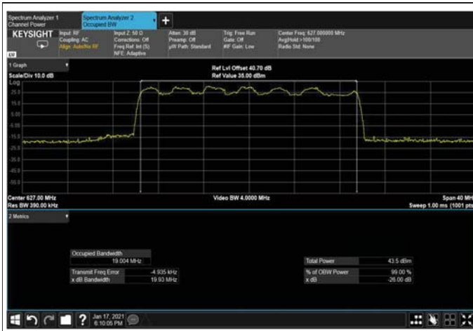
Figure 378: 16QAM 20MHz B.W; 627.0MHz, 15kHz Output
