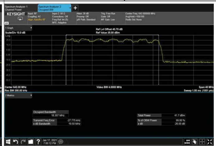
Figure 383: 16QAM 20MHz B.W; 642.0MHz, 30kHz Output
