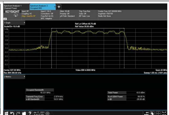
Figure 379: 16QAM 20MHz B.W; 627.0MHz, 30kHz Output
