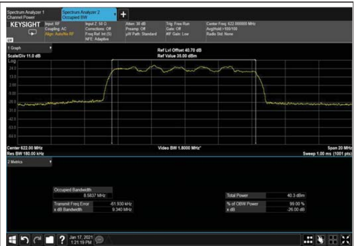
Figure 367: 16QAM 10MHz B.W; 622.0MHz, 30kHz Output
