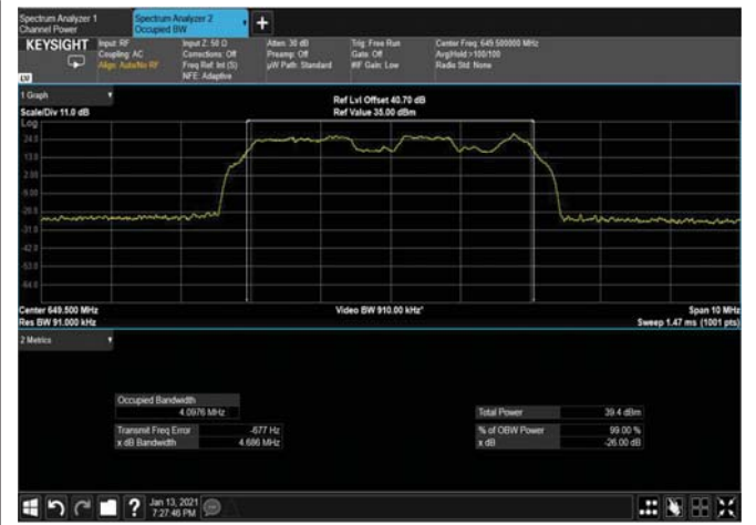
Figure 437: QPSK 5MHz B.W; 649.5MHz, 30kHz Output
