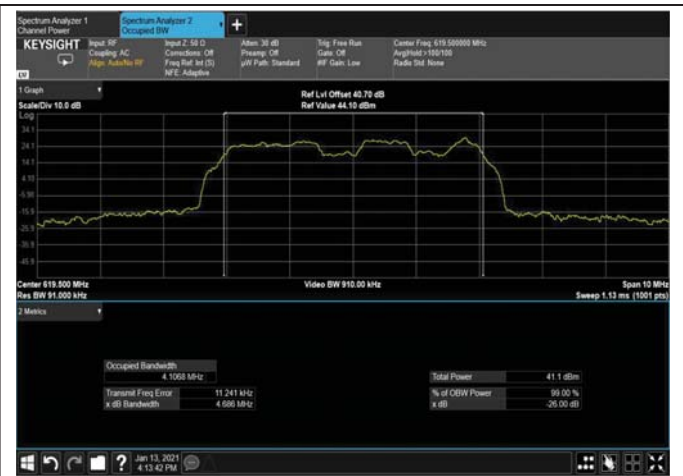
Figure 433: QPSK 5MHz B.W; 619.5MHz, 30kHz Output
