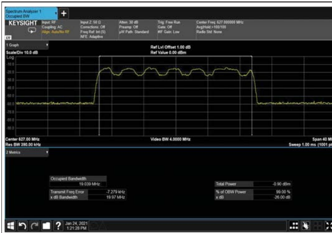
Figure 354: QPSK 20MHz B.W; 627.0MHz, 15kHz Input
