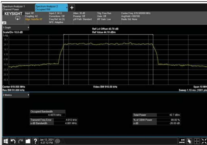
Figure 384: 64QAM 5MHz B.W; 619.5MHz, 15kHz Output
