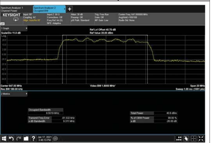
Figure 371: 16QAM 10MHz B.W; 647MHz, 30kHz Output
