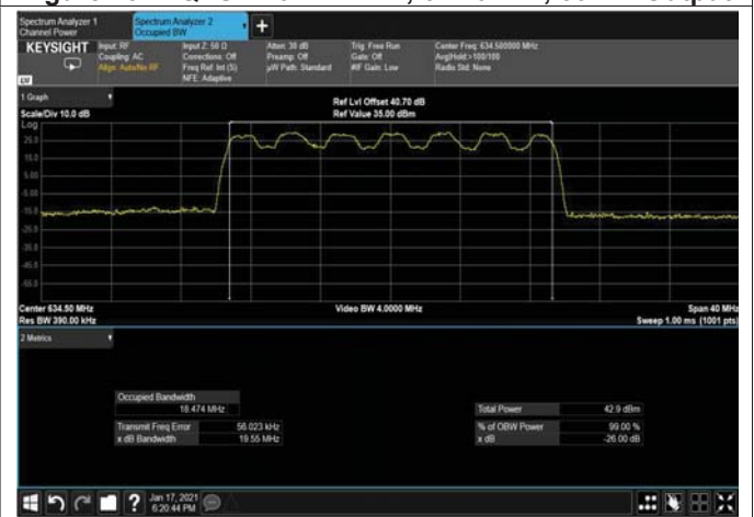
Figure 453: QPSK 20MHz B.W; 634.5MHz, 30kHz Output
