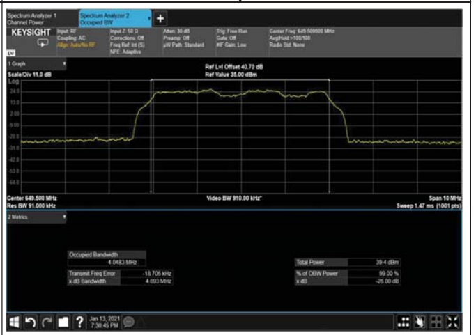
Figure 365: 16QAM 5MHz B.W; 649.5MHz, 30kHz Output
