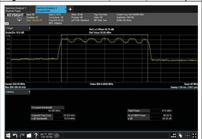
Figure 455: QPSK 20MHz B.W; 642.0MHz, 30kHz Output
