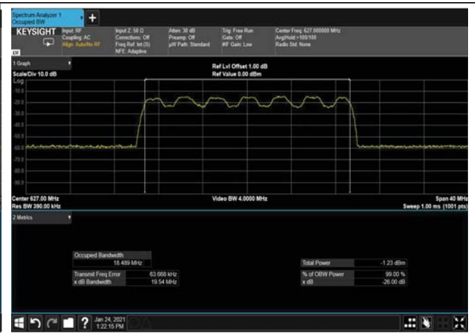
Figure 355: QPSK 20MHz B.W; 627.0MHz, 30kHz Input
