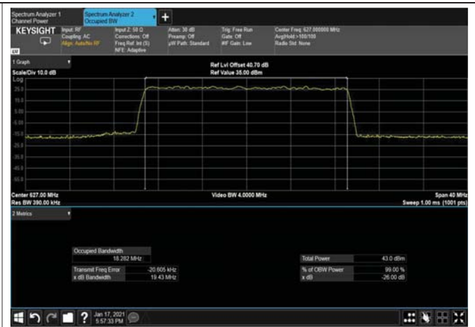
Figure 403: 64QAM 20MHz B.W; 627.0MHz, 30kHz Output
