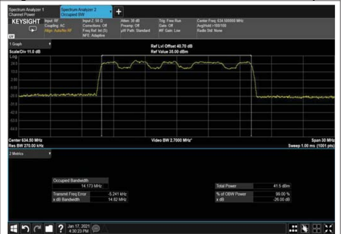
Figure 441: QPSK 10MHz B.W; 634.5MHz, 30kHz Output
