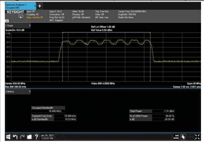
Figure 357: QPSK 20MHz B.W; 634.5MHz, 30kHz Input
