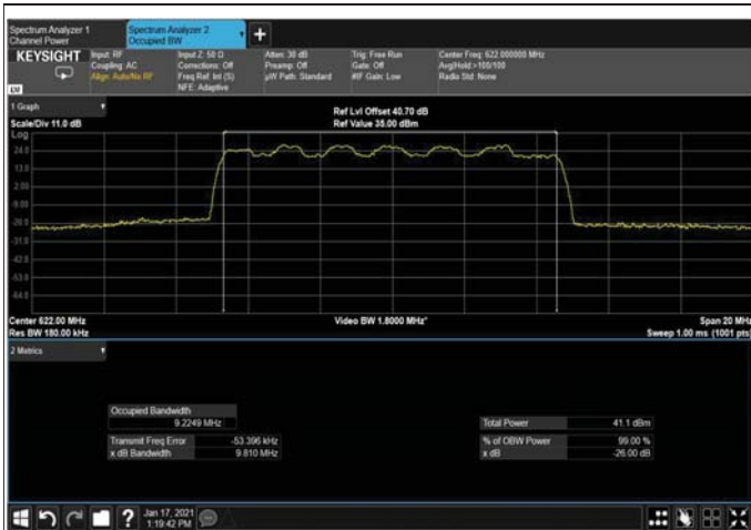
Figure 366: 16QAM 10MHz B.W; 622.0MHz, 15kHz Output
