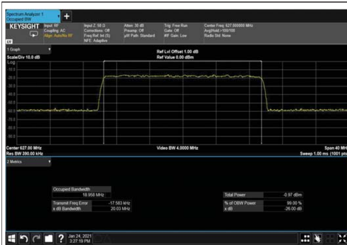
Figure 330: 256QAM 20MHz B.W; 627.0MHz, 15kHz Input
