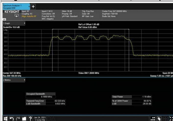
Figure 346: QPSK 10MHz B.W; 647.0MHz, 15kHz Input
