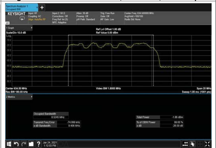
Figure 345: QPSK 10MHz B.W; 634.5MHz, 30kHz Input
