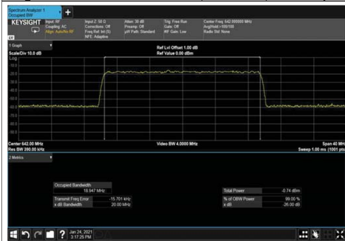
Figure 310: 64QAM 20MHz B.W; 642.0MHz, 15kHz Input
