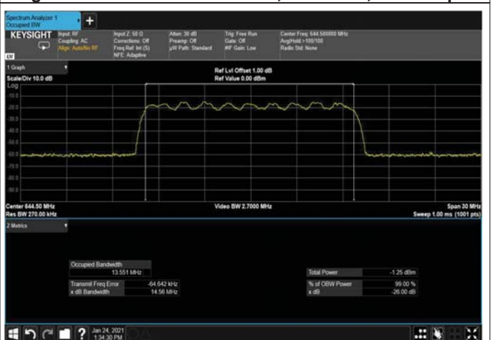
Figure 281: 16QAM 15MHz B.W; 644.5MHz, 30kHz Input
