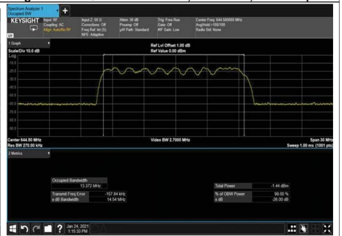
Figure 353: QPSK 15MHz B.W; 644.5MHz, 30kHz Input
