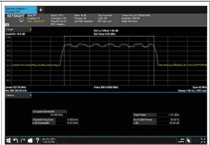
Figure 283: 16QAM 20MHz B.W; 627.0MHz, 30kHz Input
