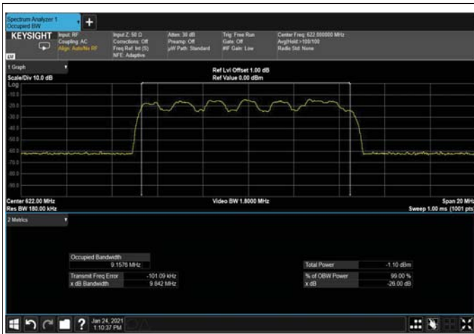
Figure 342: QPSK 10MHz B.W; 622.0MHz, 15kHz Input
