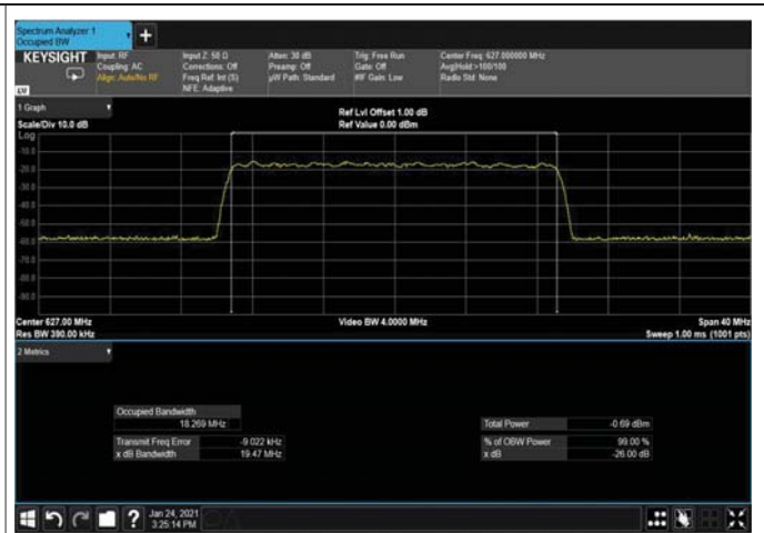
Figure 331: 256QAM 20MHz B.W; 627.0MHz, 30kHz Input
