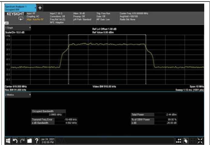
Figure 289: 64QAM 5MHz B.W; 619.5MHz, 30kHz Input
