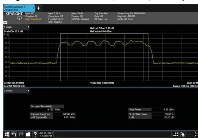
Figure 344: QPSK 10MHz B.W; 634.5MHz, 15kHz Input
