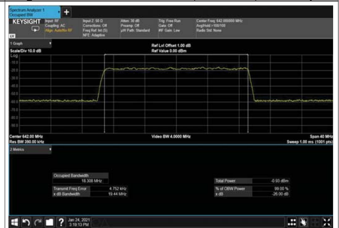
Figure 311: 64QAM 20MHz B.W; 642.0MHz, 30kHz Input
