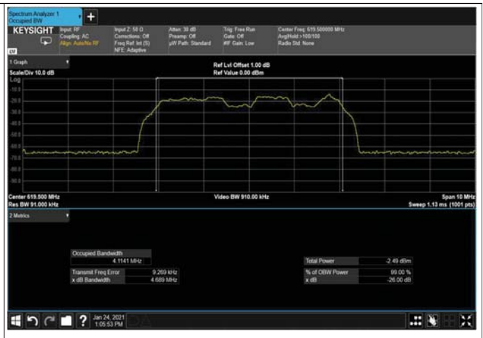
Figure 337: QPSK 5MHz B.W; 619.5MHz, 30kHz Input
