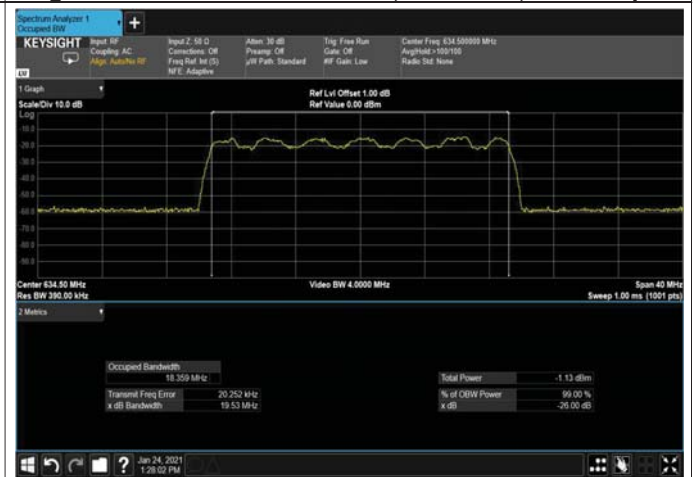
Figure 285: 16QAM 20MHz B.W; 634.5MHz, 30kHz Input
