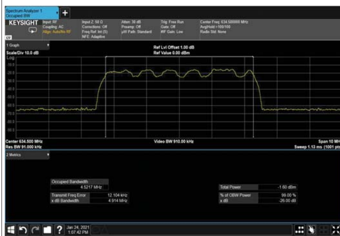
Figure 338: QPSK 5MHz B.W; 634.5MHz, 15kHz Input
