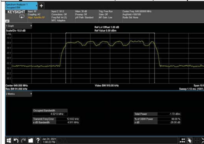
Figure 340: QPSK 5MHz B.W; 649.5MHz, 15kHz Input
