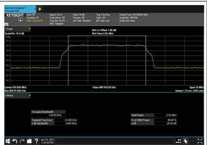
Figure 313: 256QAM 5MHz B.W; 619.5MHz, 30kHz Input
