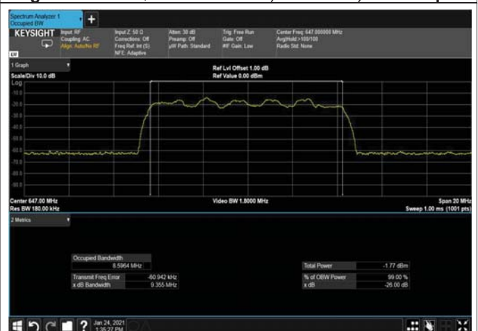
Figure 275: 16QAM 10MHz B.W; 647.0MHz, 30kHz Input
