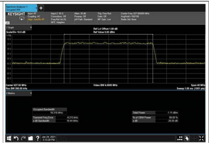
Figure 307: 64QAM 20MHz B.W; 627.0MHz, 30kHz Input
