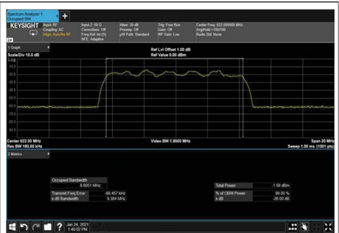
Figure 271: 16QAM 10MHz B.W; 622.0MHz, 30kHz Input
