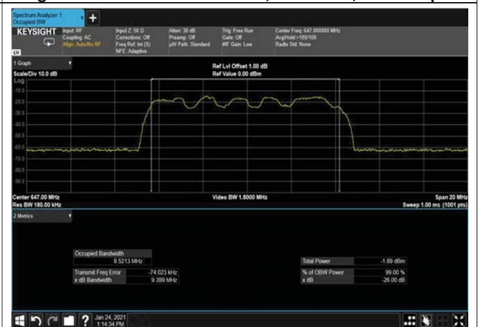
Figure 347: QPSK 10MHz B.W; 647.0MHz, 30kHz Input
