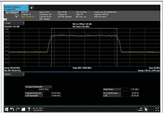
Figure 295: 64QAM 10MHz B.W; 622.0MHz, 30kHz Input
