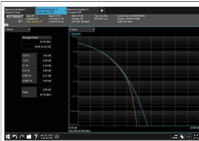
Figure 240: QPSK 5MHz B.W; 619.5MHz, 15kHz
