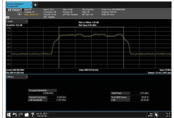
Figure 269: 16QAM 5MHz B.W; 649.5MHz, 30kHz Input
