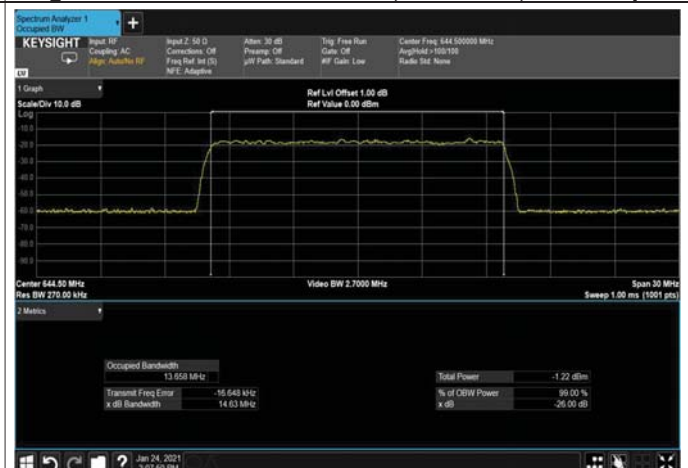
Figure 305: 64QAM 15MHz B.W; 644.5MHz, 30kHz Input
