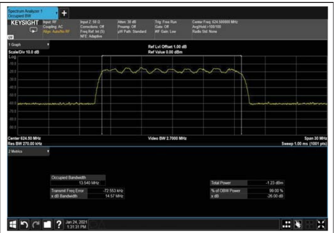
Figure 277: 16QAM 15MHz B.W; 624.5MHz, 30kHz Input
