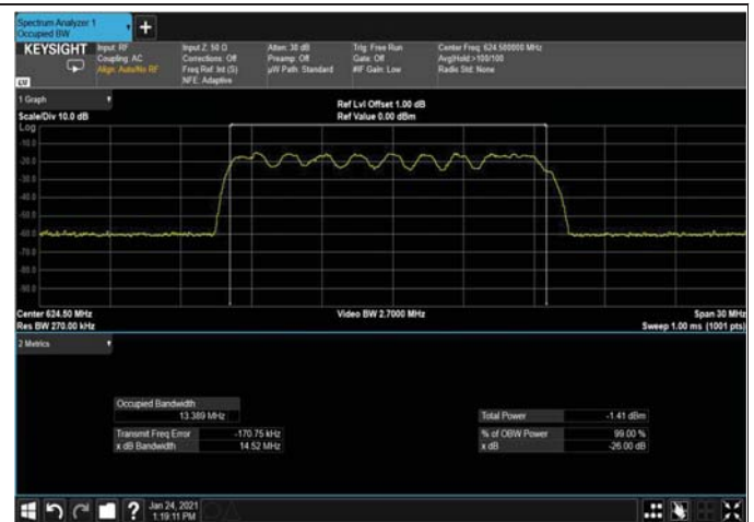
Figure 349: QPSK 15MHz B.W; 624.5MHz, 30kHz Input
