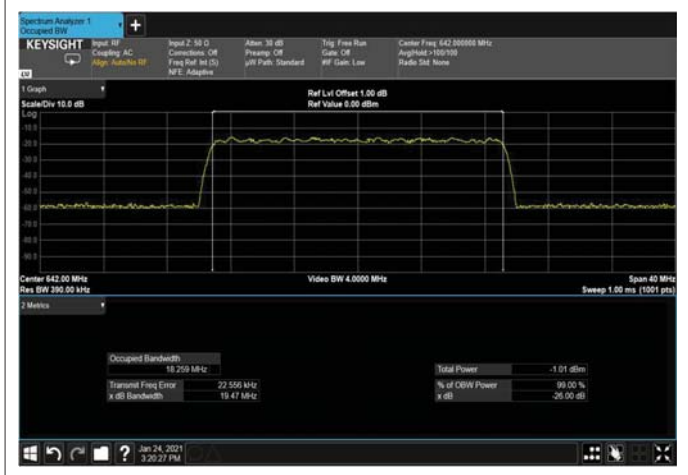
Figure 335: 256QAM 20MHz B.W; 642.0MHz, 30kHz Input
