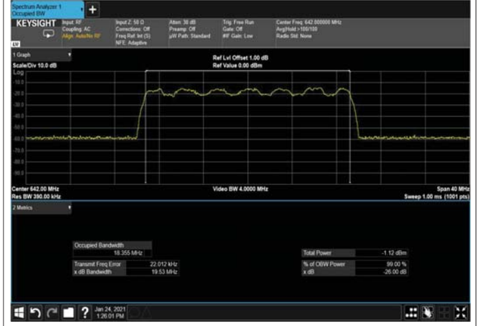
Figure 287: 16QAM 20MHz B.W; 642.0MHz, 30kHz Input
