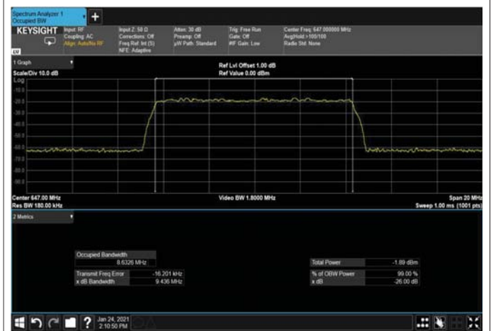
Figure 299: 64QAM 10MHz B.W; 647.0MHz, 30kHz Input
