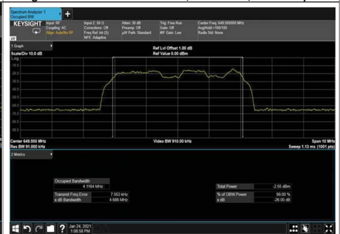
Figure 341: QPSK 5MHz B.W; 649.5MHz, 30kHz Input
