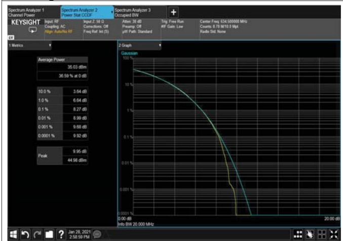
Figure 242: QPSK 5MHz B.W; 634.5MHz, 15kHz
