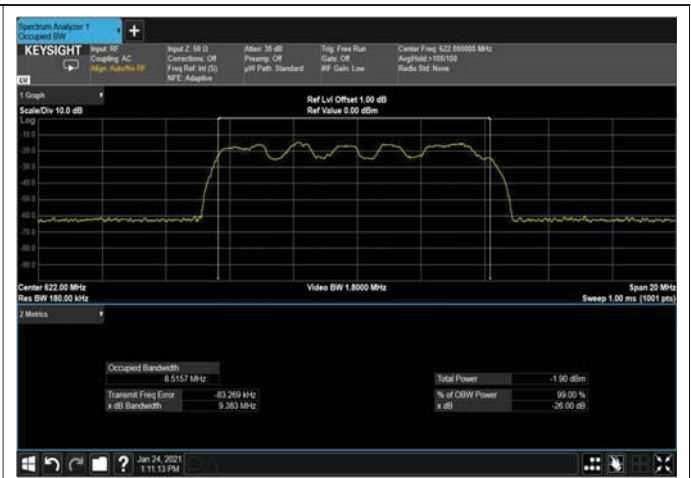
Figure 343: QPSK 10MHz B.W; 622.0MHz, 30kHz Input
