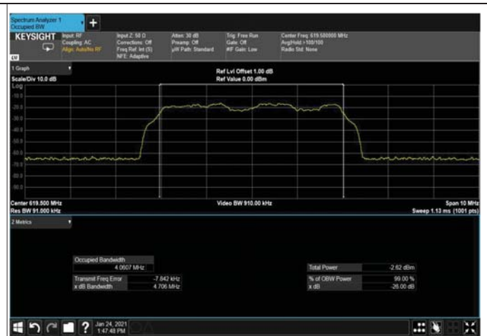
Figure 265: 16QAM 5MHz B.W; 619.5MHz, 30kHz Input
