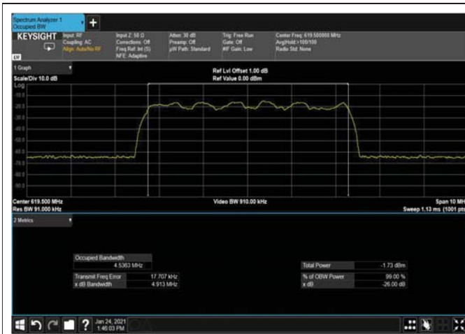
Figure 264: 16QAM 5MHz B.W; 619.5MHz, 15kHz Input
