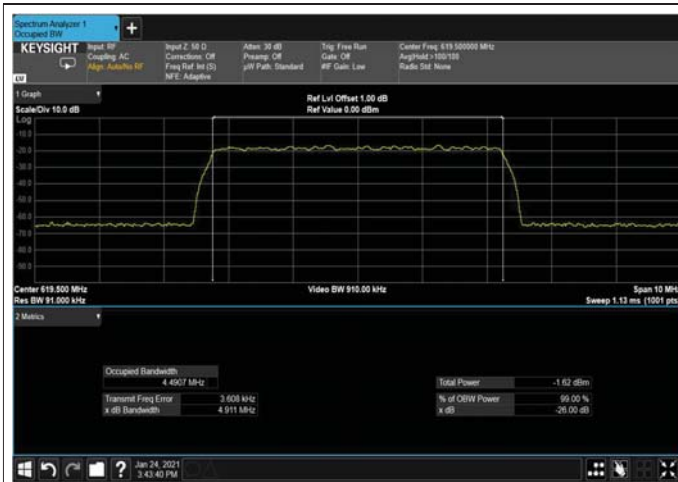
Figure 312: 256QAM 5MHz B.W; 619.5MHz, 15kHz Input
