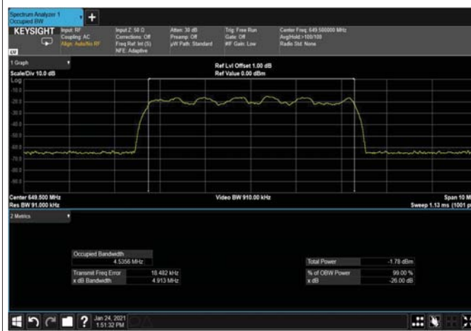
Figure 268: 16QAM 5MHz B.W; 649.5MHz, 15kHz Input
