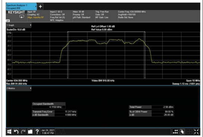
Figure 339: QPSK 5MHz B.W; 634.5MHz, 30kHz Input
