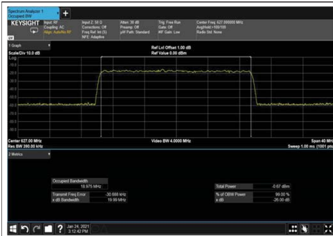
Figure 306: 64QAM 20MHz B.W; 627.0MHz, 15kHz Input
