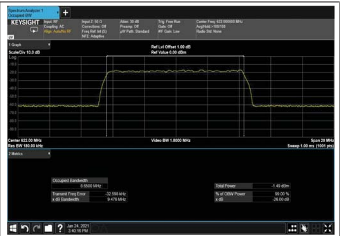
Figure 319: 256QAM 10MHz B.W; 622.0MHz, 30kHz Input
