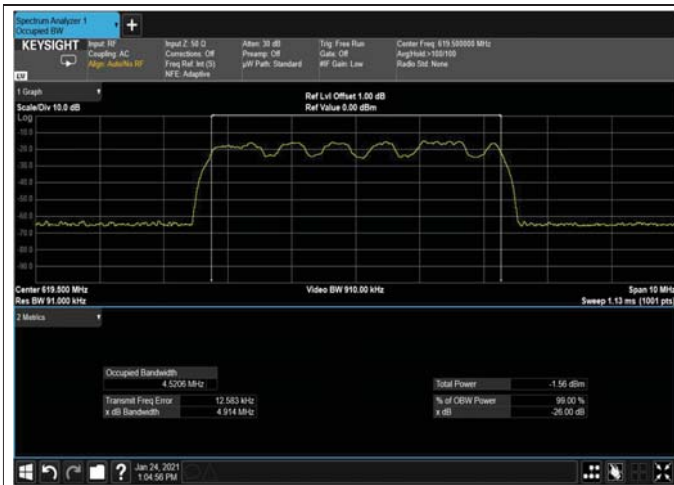
Figure 336: QPSK 5MHz B.W; 619.5MHz, 15kHz Input
