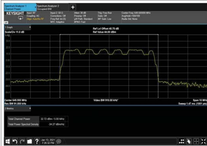
Figure 84: QPSK 5MHz B.W; 649.5MHz, 15kHz
