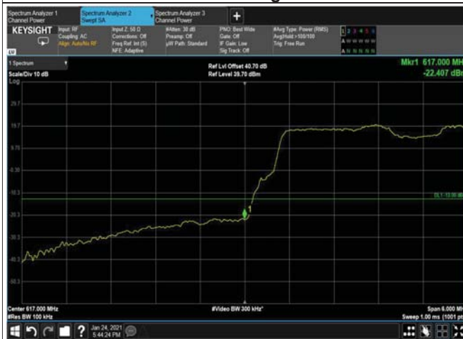
Figure 106: 16QAM 5MHz B.W.; 619.5MHz, 30kHz Lower Edge
