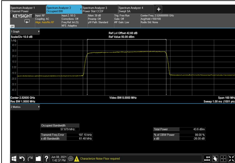
Figure 176: output 256QAM 60MHz B.W.; 2526.0MHz, 30kHz
