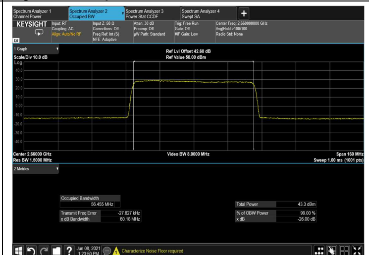
Figure 196: output QPSK 60MHz B.W.; 2660.0MHz, 60kHz
