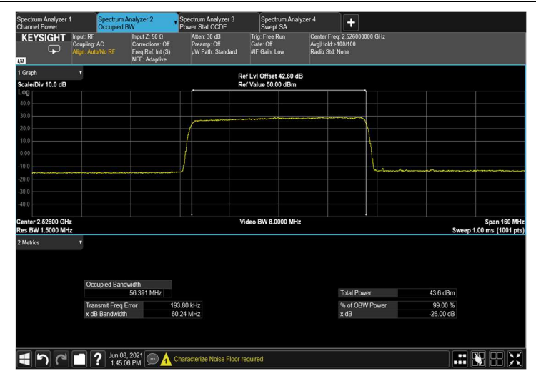
Figure 177: output 256QAM 60MHz B.W.; 2526.0MHz, 60kHz
