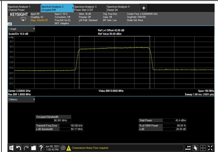
Figure 192: output QPSK 60MHz B.W.; 2526.0MHz, 60kHz
