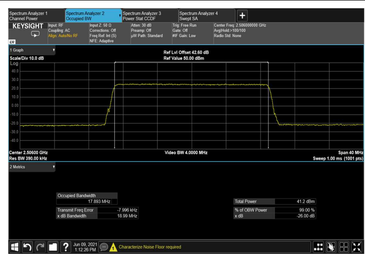
Figure 200: 64QAM 20MHz B.W.; 2506.0MHz OUTPUT
