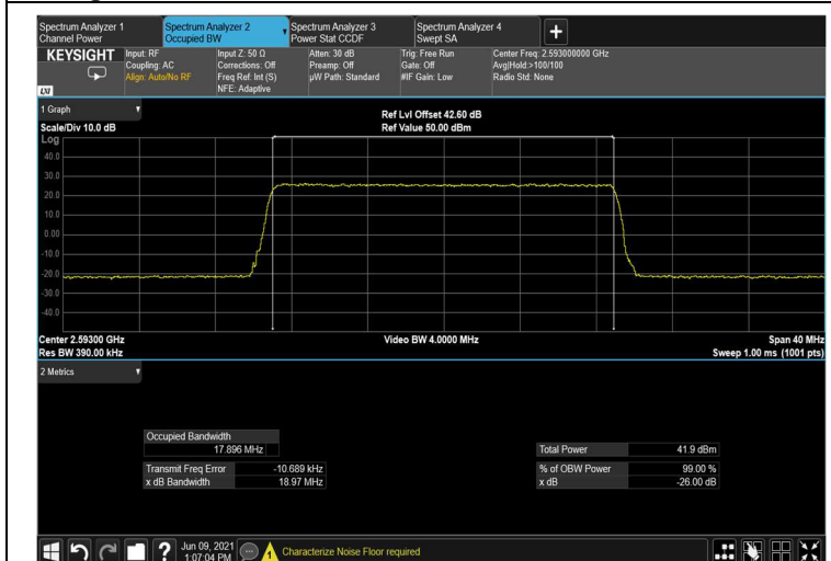
Figure 201: 64QAM 20MHz B.W.; 2593.0MHz OUTPUT
