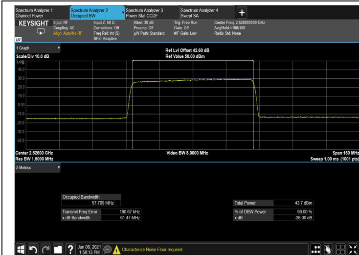
Figure 191: output QPSK 60MHz B.W.; 2526.0MHz, 30kHz
