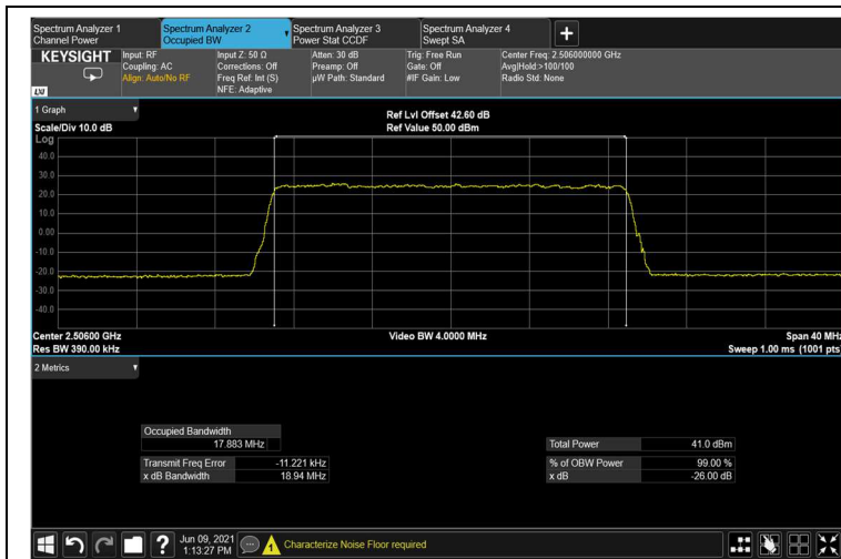
Figure 197: 16QAM 20MHz B.W.; 2506.0MHz OUTPUT
