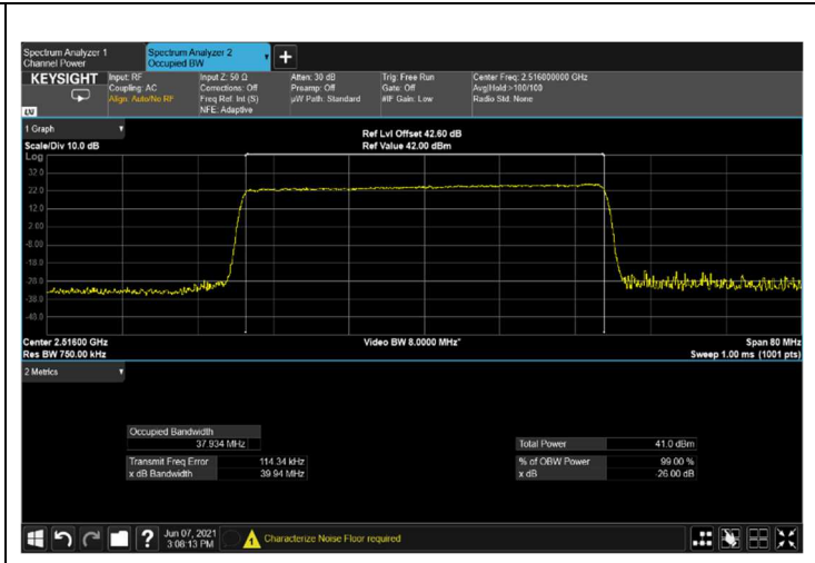
Figure 168: output 256QAM 40MHz B.W.; 2516.0MHz, 30kHz
