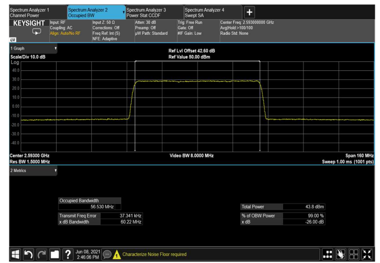
Figure 179: output 256QAM 60MHz B.W.; 2593.0MHz, 60kHz
