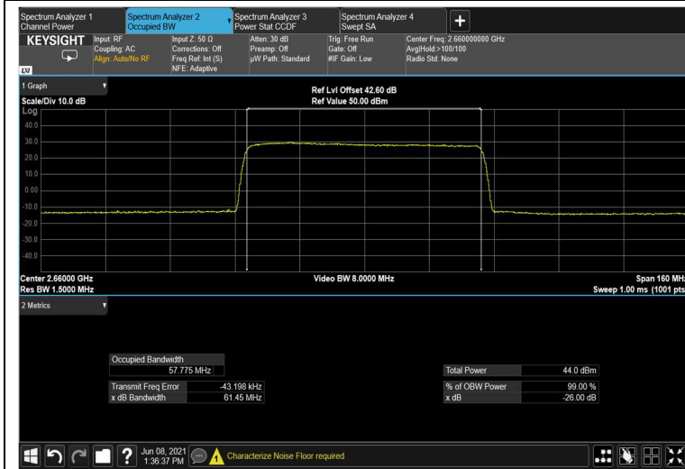
Figure 180: output 256QAM 60MHz B.W.; 2660.0MHz, 30kHz
