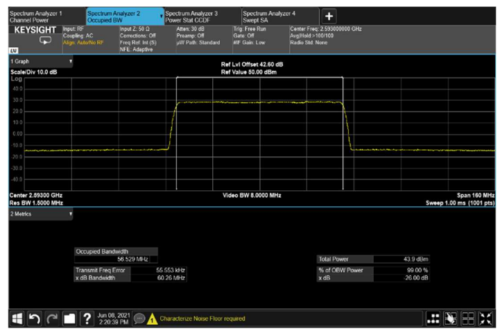
Figure 164: output 64QAM 60MHz B.W.; 2593.0MHz, 60kHz
