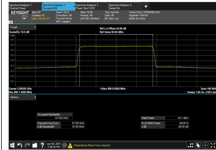
Figure 178: output 256QAM 60MHz B.W.; 2593.0MHz, 30kHz
