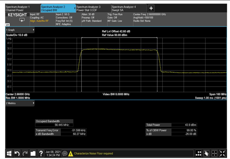
Figure 181: output 256QAM 60MHz B.W.; 2660.0MHz, 60kHz
