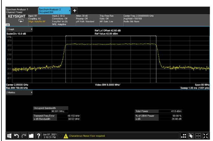
Figure 172: output 256QAM 40MHz B.W.; 2593.0MHz, 60kHz
