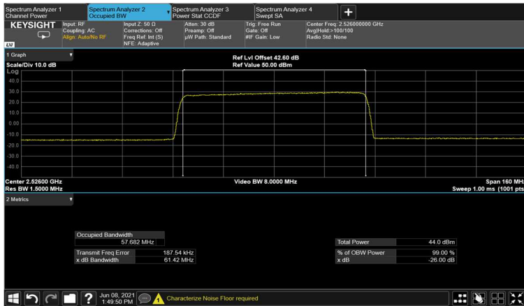
Figure 161: output 64QAM 60MHz B.W.; 2526.0MHz, 30kHz
