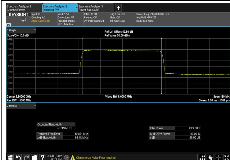
Figure 195: output QPSK 60MHz B.W.; 2660.0MHz, 30kHz
