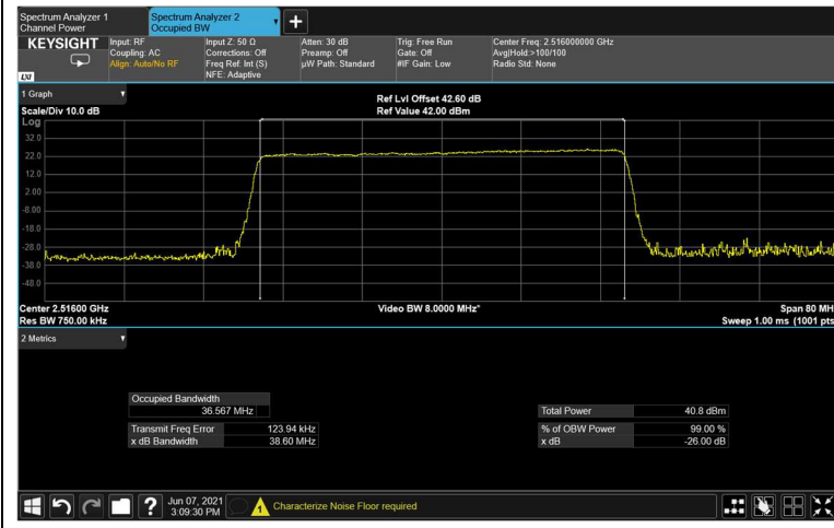
Figure 169: output 256QAM 40MHz B.W.; 2516.0MHz, 60kHz
