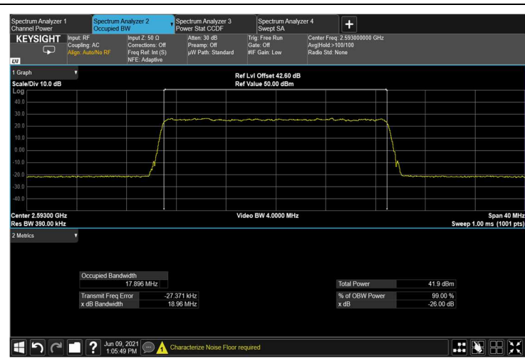
Figure 198: 16QAM 20MHz B.W.; 2593.0MHz OUTPUT
