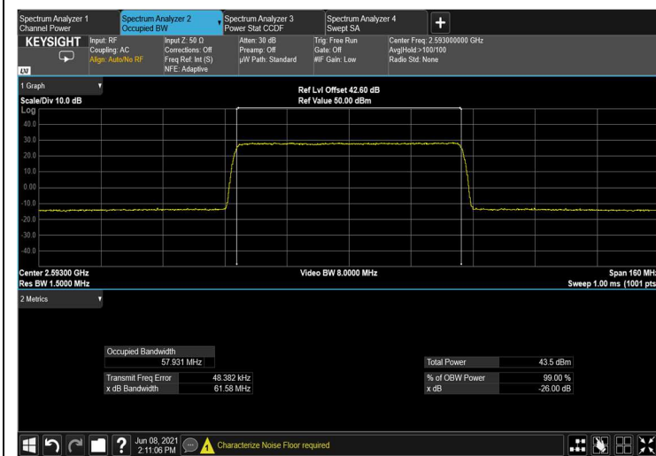
Figure 193: output QPSK 60MHz B.W.; 2593.0MHz, 30kHz
