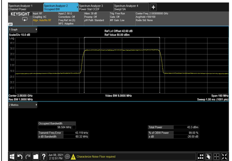
Figure 194: output QPSK 60MHz B.W.; 2593.0MHz, 60kHz
