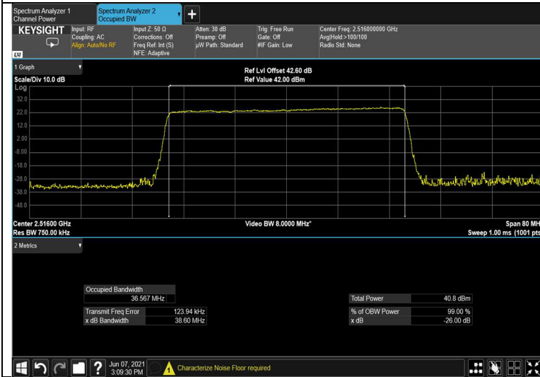
Figure 109: input 256QAM 40MHz B.W.; 2516.0MHz, 60kHz
