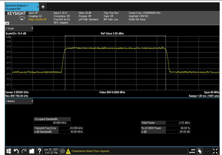
Figure 125: input QPSK 40MHz B.W.; 2593.0MHz, 15kHz
