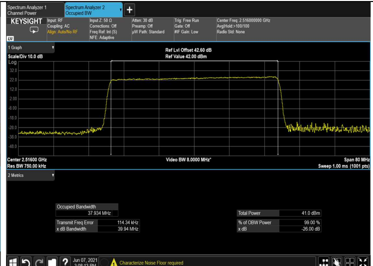
Figure 108: input 256QAM 40MHz B.W.; 2516.0MHz, 30kHz
