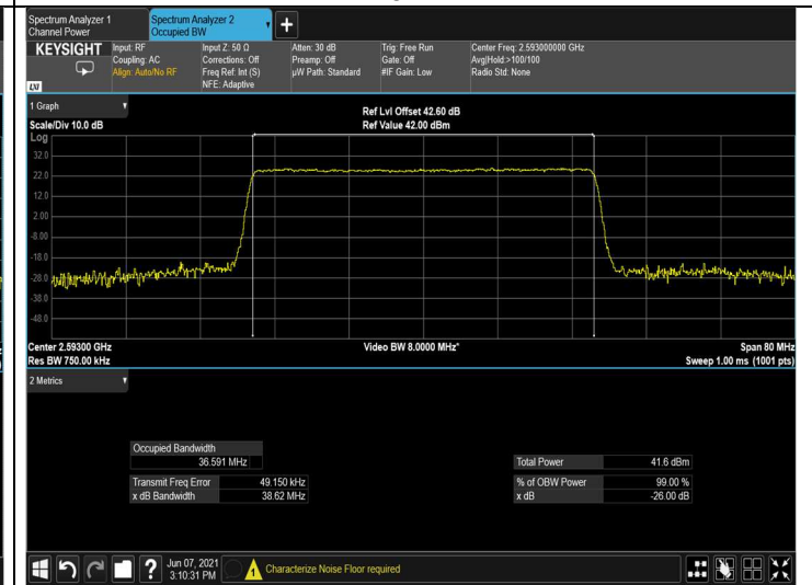
Figure 112: input 256QAM 40MHz B.W.; 2593.0MHz, 60kHz
