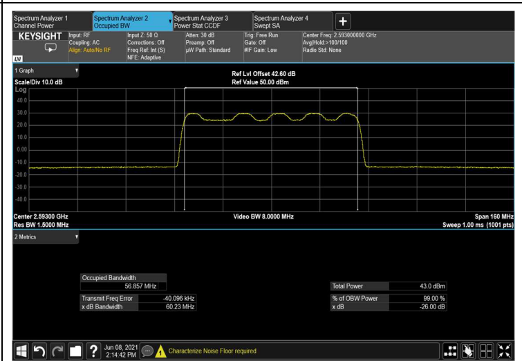
Figure 149: output 16QAM 60MHz B.W.; 2593.0MHz, 60kHz
