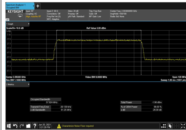
Figure 118: input 256QAM 60MHz B.W.; 2593.0MHz, 30kHz
