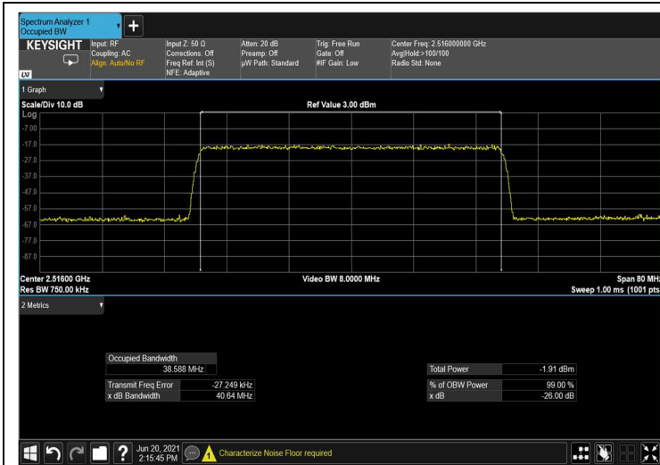
Figure 122: input QPSK 40MHz B.W.; 2516.0MHz, 15kHz
