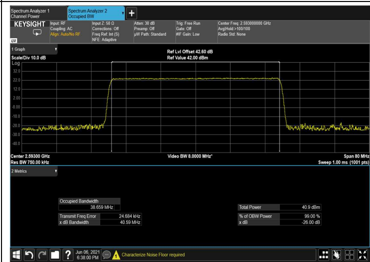
Figure 155: output 64QAM 40MHz B.W.; 2593.0MHz, 15kHz
