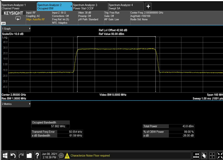
Figure 103: input 64QAM 60MHz B.W.; 2593.0MHz, 30kHz
