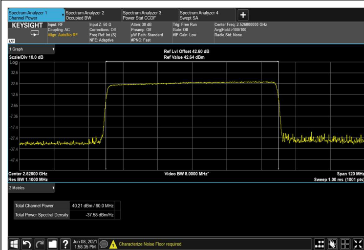
Figure 62: QPSK 60MHz B.W.; 2526.0MHz, 30kHz
