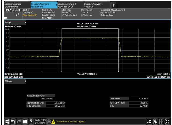
Figure 104: input 64QAM 60MHz B.W.; 2593.0MHz, 60kHz
