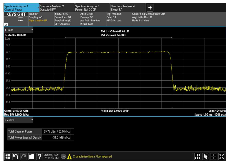
Figure 65: QPSK 60MHz B.W.; 2593.0MHz, 60kHz
