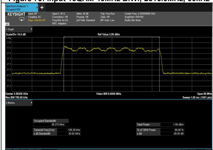
Figure 81: input 16QAM 40MHz B.W.; 2593.0MHz, 30kHz
