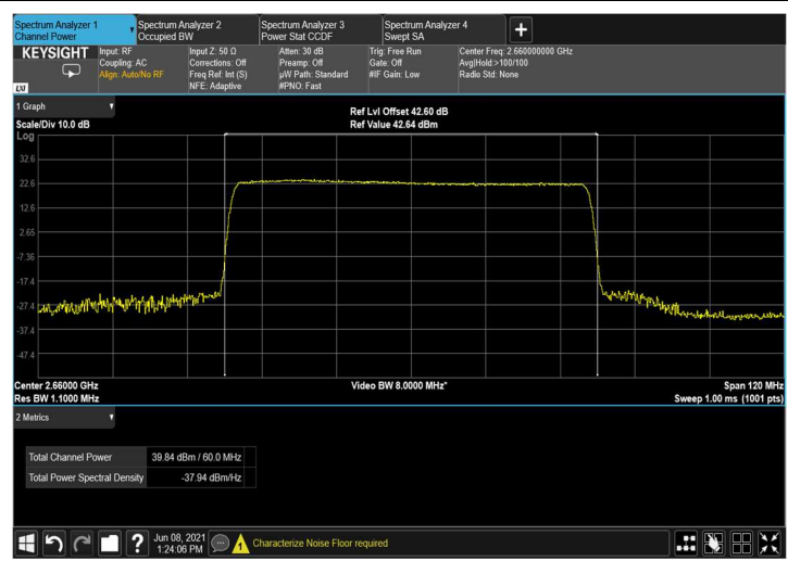
Figure 67: QPSK 60MHz B.W.; 2660.0MHz, 60kHz
