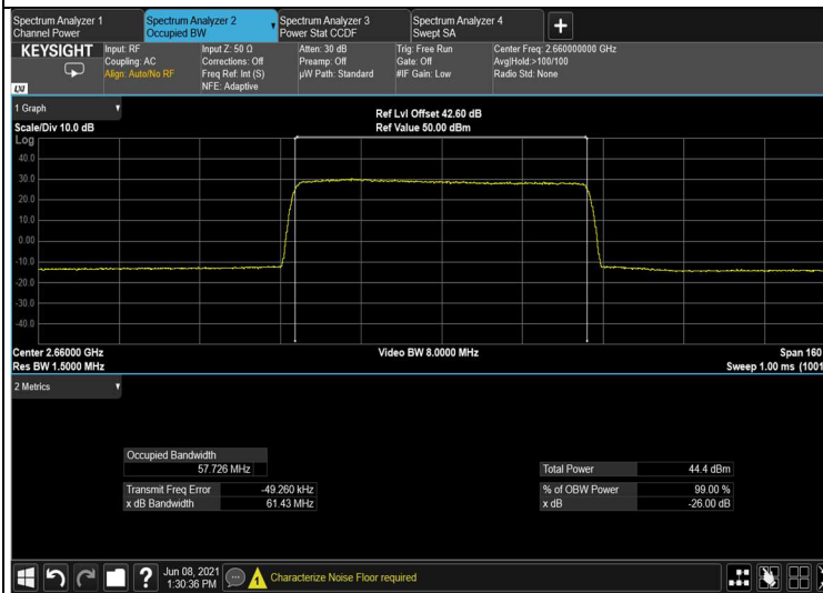
Figure 105: input 64QAM 60MHz B.W.; 2660.0MHz, 30kHz
