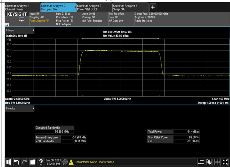
Figure 106: input 64QAM 60MHz B.W.; 2660.0MHz, 60kHz
