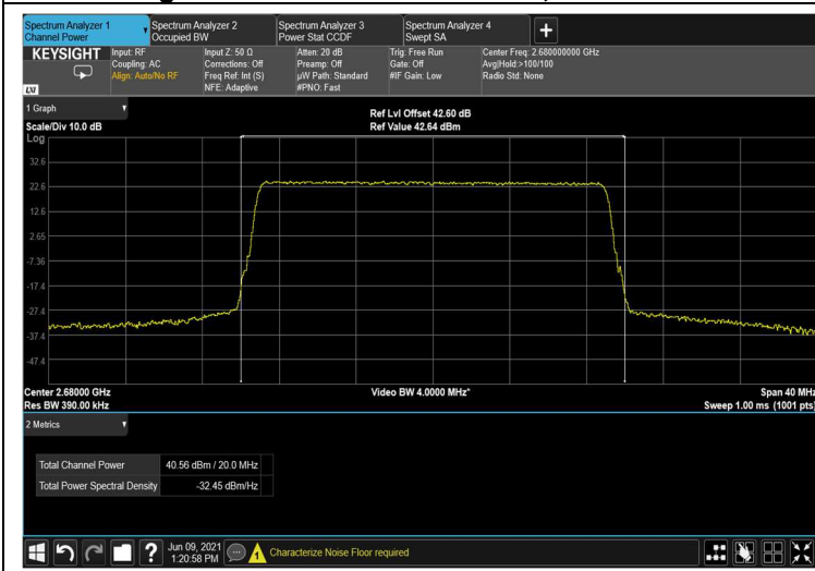
Figure 76: QPSK 20MHz B.W.; 2680.0MHz
