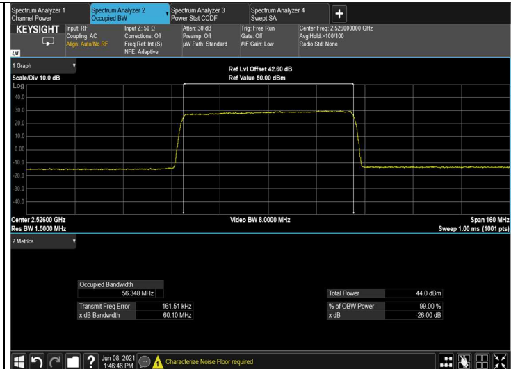
Figure 102: input 64QAM 60MHz B.W.; 2526.0MHz, 60kHz
