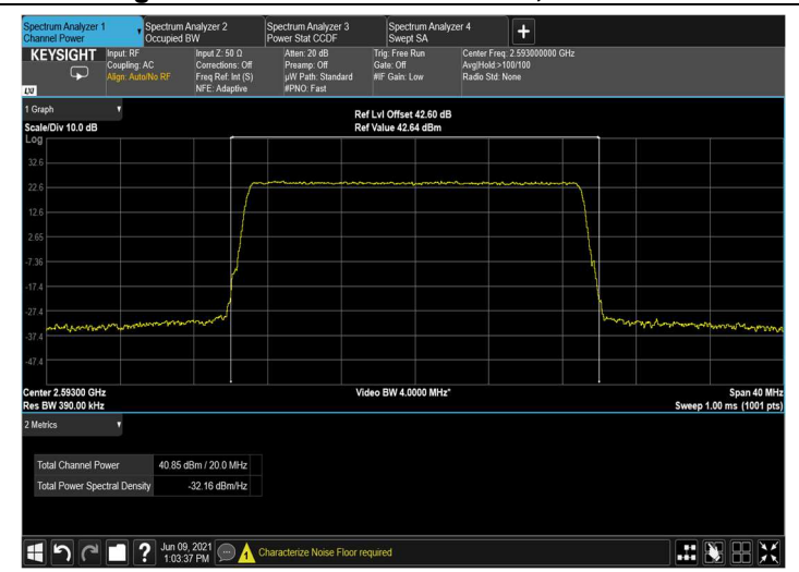
Figure 75: QPSK 20MHz B.W.; 2593.0MHz
