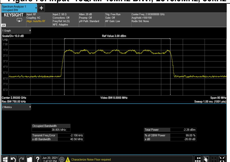
Figure 80: input 16QAM 40MHz B.W.; 2593.0MHz, 15kHz
