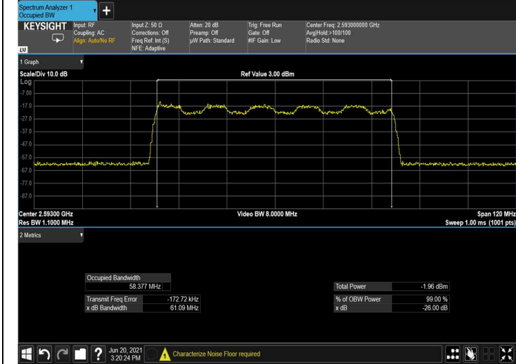
Figure 88: input 16QAM 60MHz B.W.; 2593.0MHz, 30kHz
