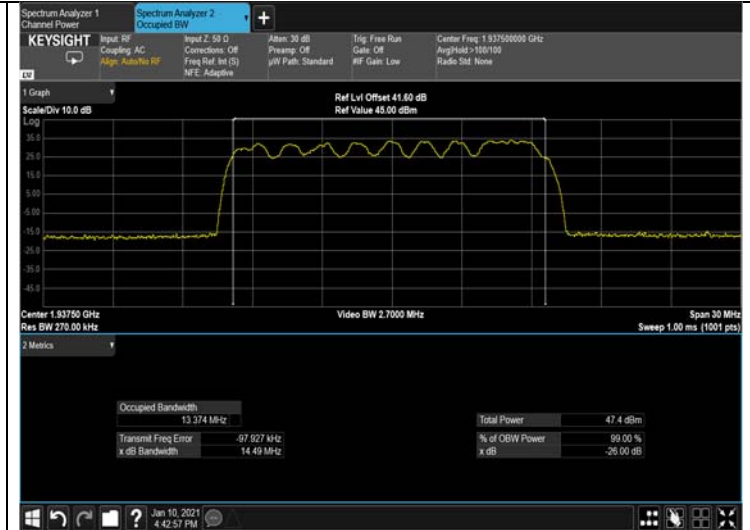
Figure 318: QPSK 15MHz B.W.; 1937.5MHz, 30kHz Output
