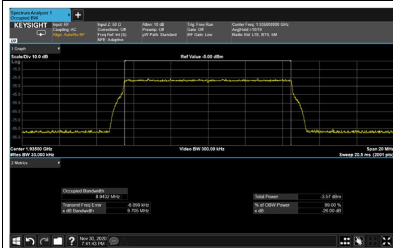
Figure 338: 64QAM 10MHz B.W.; 1935MHz Input – 4G
