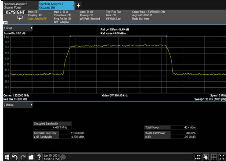
Figure 287: 256QAM 5MHz B.W.; 1932.5MHz, 15kHz Output
