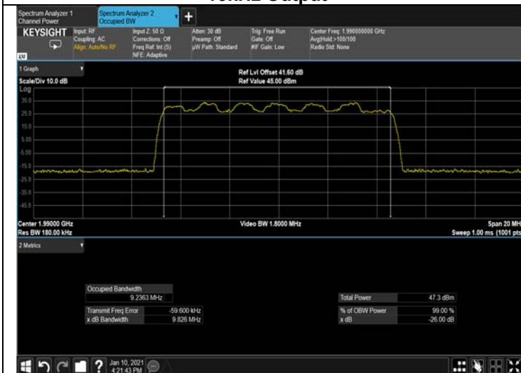
Figure 261: 16QAM 10MHz B.W.; 1990.0MHz, 15kHz Output
