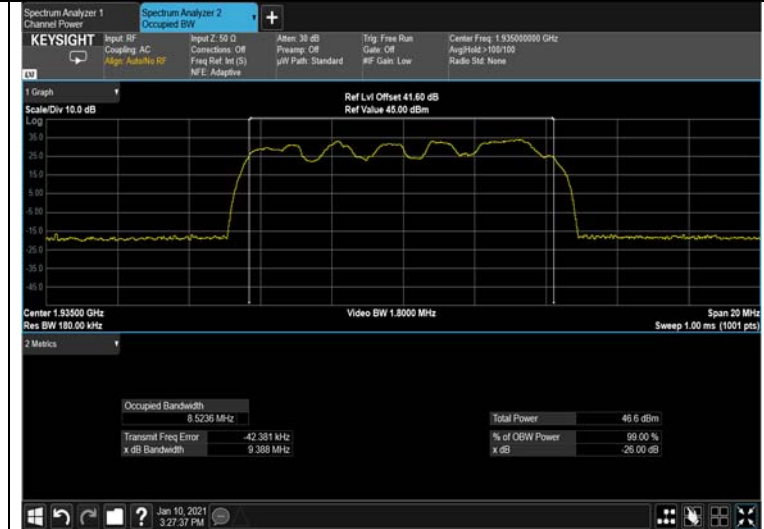
Figure 312: QPSK 10MHz B.W.; 1935.0MHz, 30kHz Output
