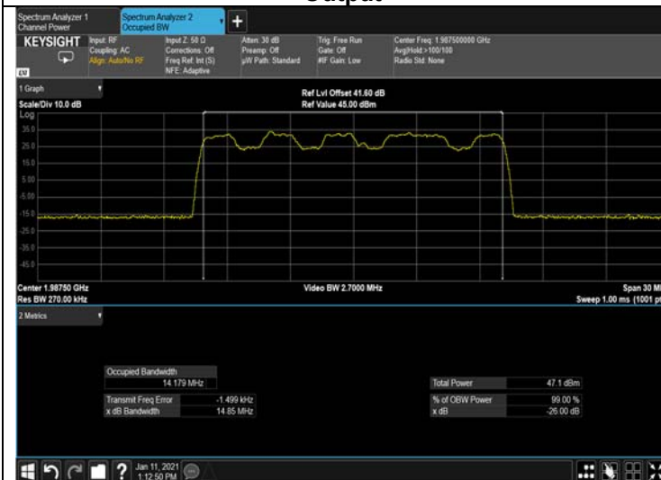
Figure 321: QPSK 15MHz B.W.; 1987.5MHz, 15kHz Output
