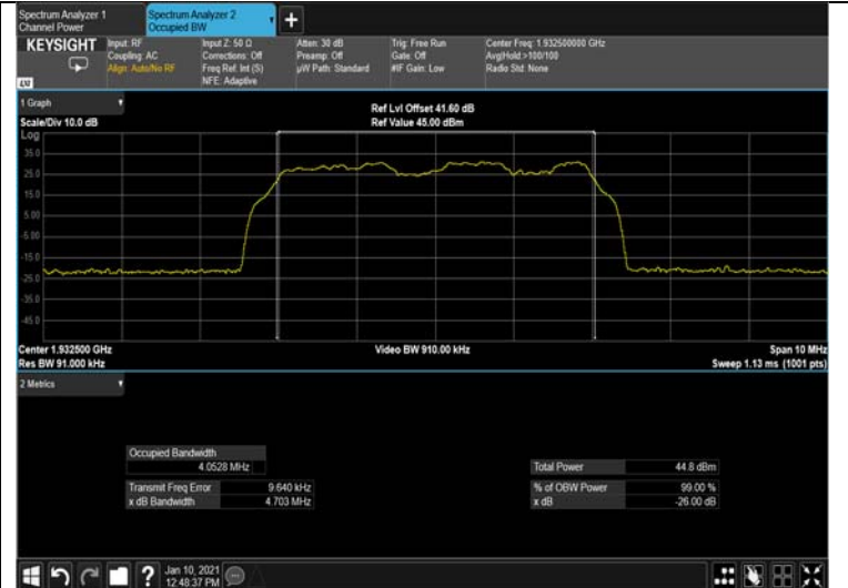
Figure 252: 16QAM 5MHz B.W.; 1932.5MHz, 30kHz Output
