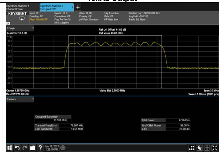
Figure 268: 16QAM 15MHz B.W.; 1990.0MHz, 30kHz Output
