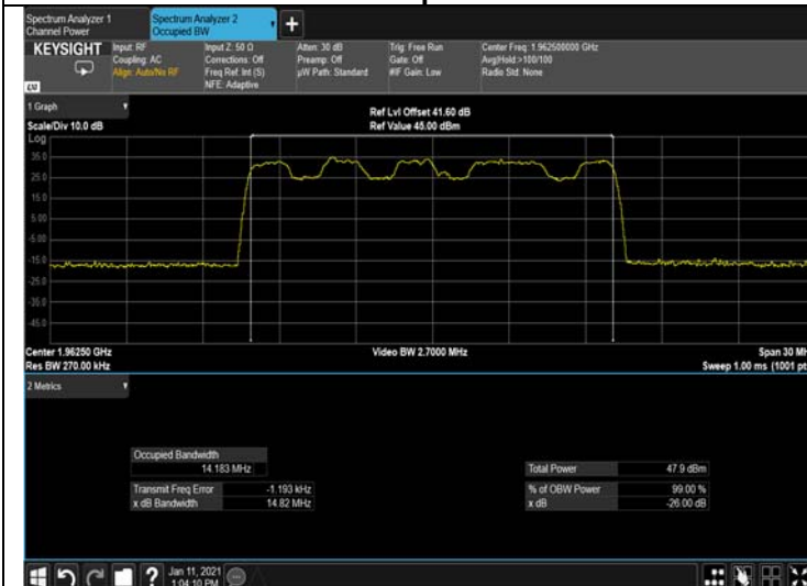
Figure 319: QPSK 15MHz B.W.; 1962.5MHz, 15kHz Output
