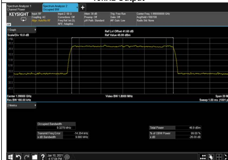
Figure 279: 64QAM 10MHz B.W.; 1990.0MHz, 15kHz Output
