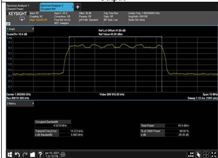
Figure 255: 16QAM 5MHz B.W.; 1992.5MHz, 15kHz Output
