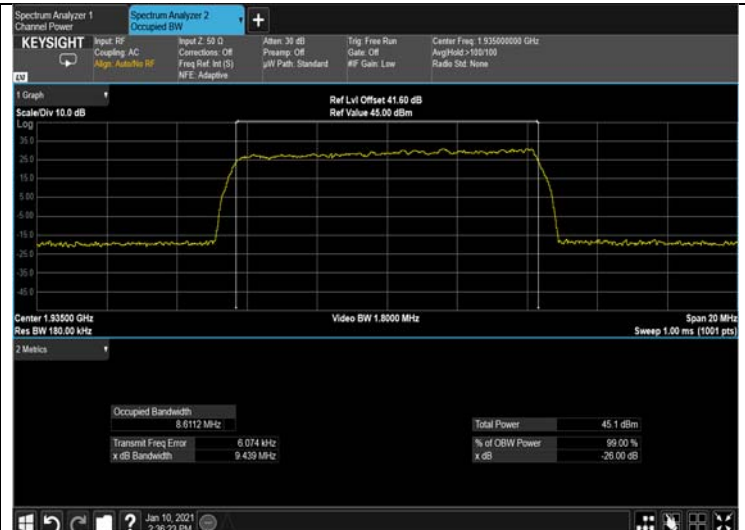
Figure 294: 256QAM 10MHz B.W.; 1935.0MHz, 30kHz Output
