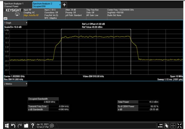
Figure 270: 64QAM 5MHz B.W.; 1937.5MHz, 30kHz Output
