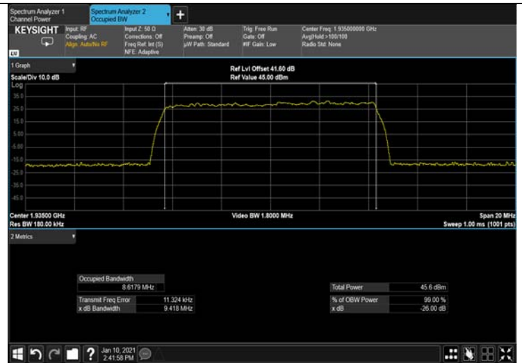
Figure 276: 64QAM 10MHz B.W.; 1935.0MHz, 30kHz Output
