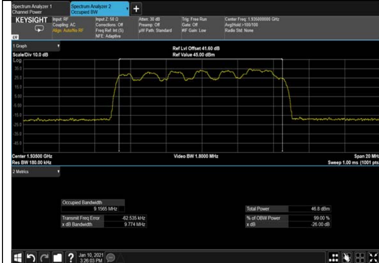
Figure 311: QPSK 10MHz B.W.; 1935.0MHz, 15kHz Output
