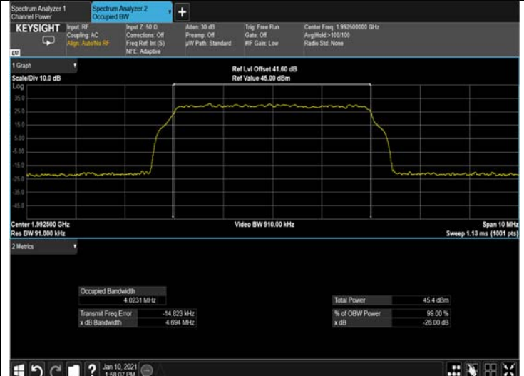
Figure 292: 256QAM 5MHz B.W.; 1992.5MHz, 30kHz Output
