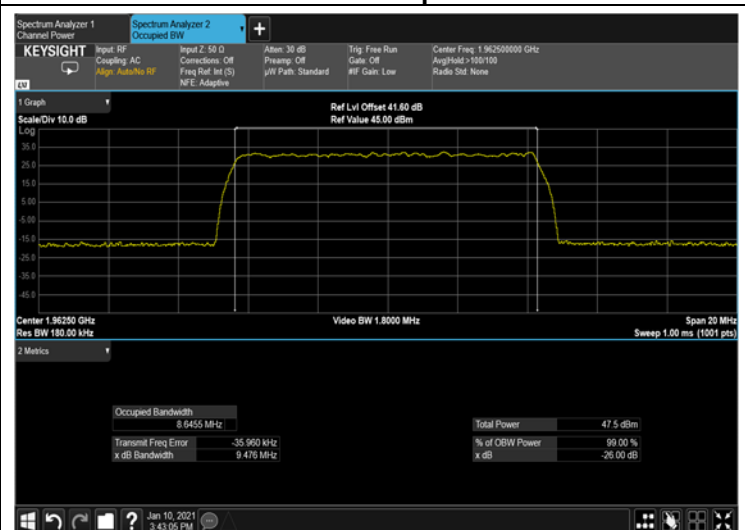
Figure 296: 256QAM 10MHz B.W.; 1962.5MHz, 30kHz Output
