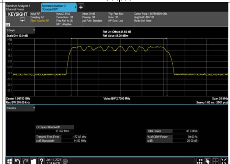
Figure 322: QPSK 15MHz B.W.; 1987.5MHz, 30kHz Output
