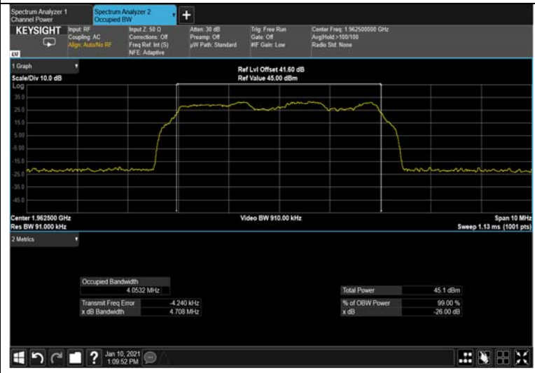
Figure 254: 16QAM 5MHz B.W.; 1962.5MHz, 30kHz Output
