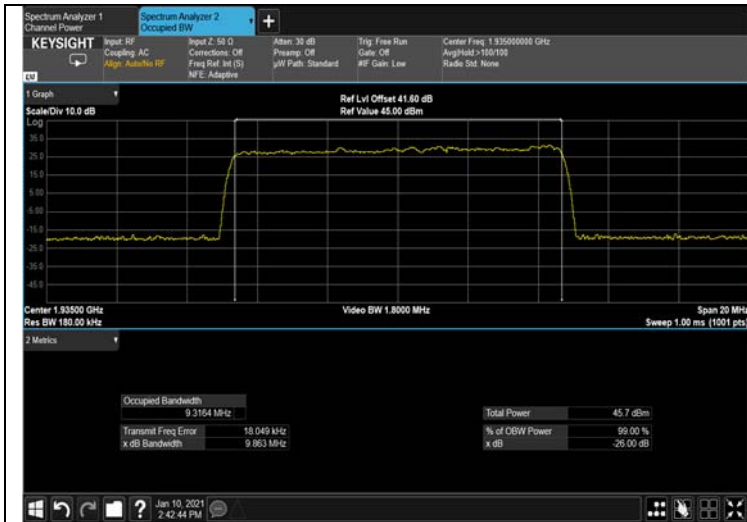
Figure 275: 64QAM 10MHz B.W.; 1935.0MHz, 15kHz Output
