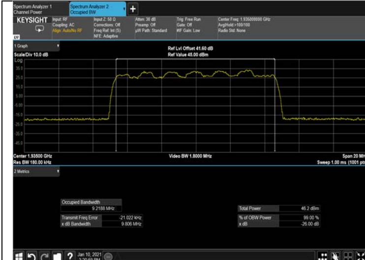
Figure 257: 16QAM 10MHz B.W.; 1935.0MHz, 15kHz Output
