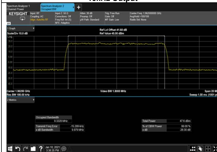
Figure 277: 64QAM 10MHz B.W.; 1962.5MHz, 15kHz Output
