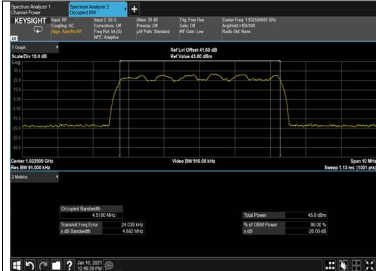
Figure 251: 16QAM 5MHz B.W.; 1932.5MHz, 15kHz Output
