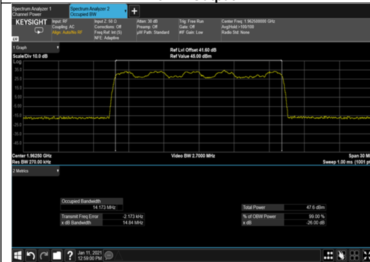
Figure 265: 16QAM 15MHz B.W.; 1962.5MHz, 60kHz Output
