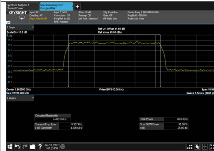
Figure 271: 64QAM 5MHz B.W.; 1962.5MHz, 15kHz Output
