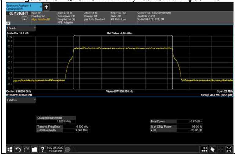
Figure 348: QPSK 10MHz B.W.; 1962.5MHz Input – 4G
