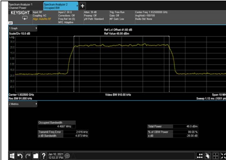
Figure 269: 64QAM 5MHz B.W.; 1937.5MHz, 15kHz Output
