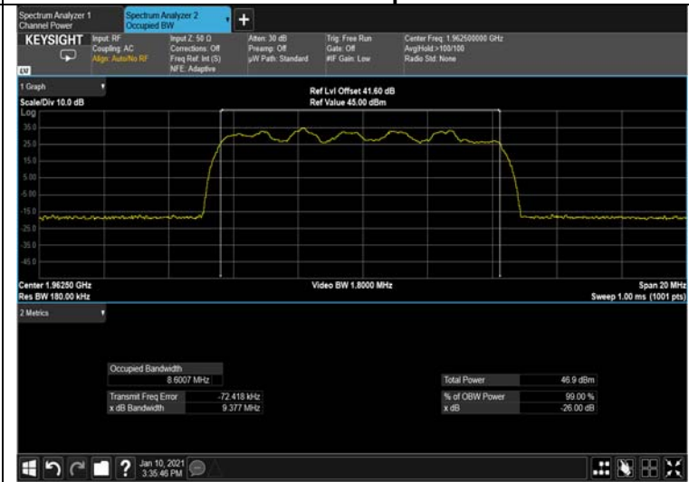
Figure 260: 16QAM 10MHz B.W.; 1962.5MHz, 30kHz Output
