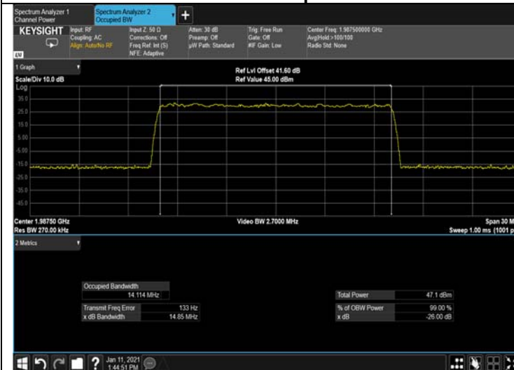
Figure 303: 256QAM 15MHz B.W.; 1987.5MHz, 15kHz Output
