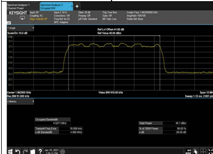
Figure 253: 16QAM 5MHz B.W.; 1962.5MHz, 15kHz Output
