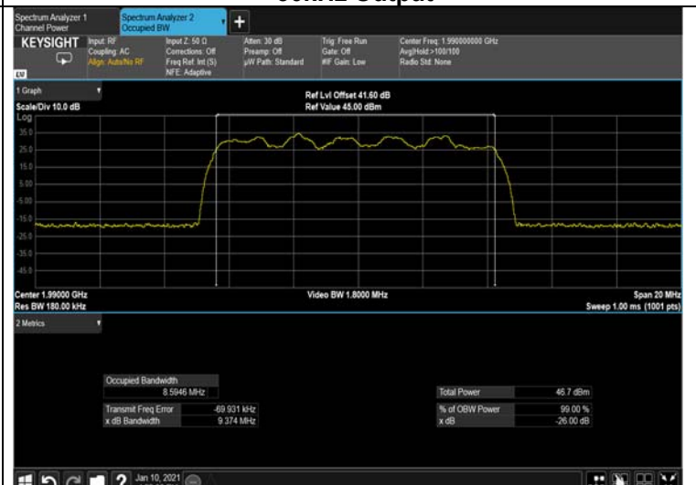
Figure 262: 16QAM 10MHz B.W.; 1990.0MHz, 30kHz Output
