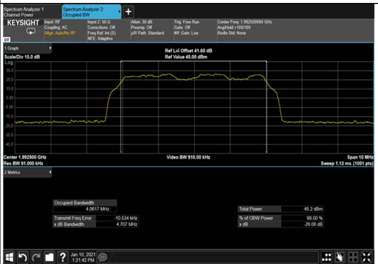
Figure 256: 16QAM 5MHz B.W.; 1992.5MHz, 30kHz Output
