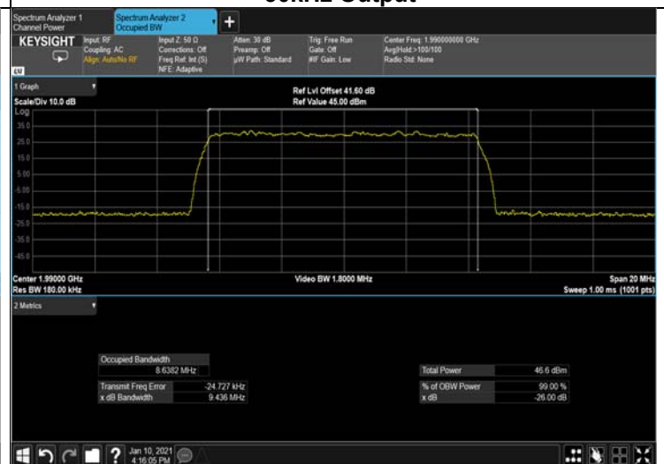
Figure 280: 64QAM 10MHz B.W.; 1990.0MHz, 30kHz Output
