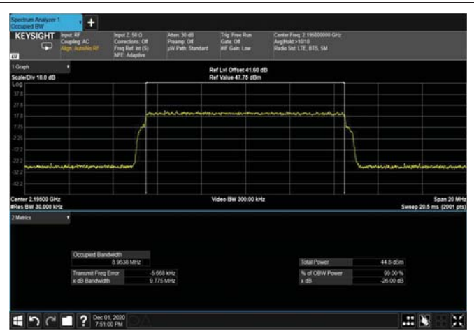
Figure 377: QPSK 10MHz; 2195MHz – 4G OUTPUT
