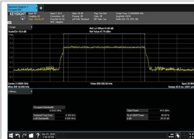
Figure 376: QPSK 10MHz; 2155MHz – 4G OUTPUT
