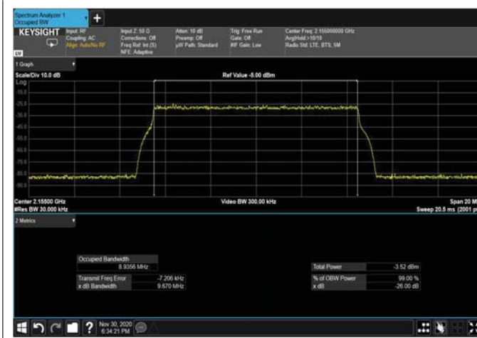
Figure 346: QPSK 10MHz; 2155MHz – 4G INPUT
