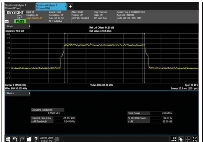
Figure 274: 64QAM 10MHz B.W; 2115.0MHz, 30kHz OUTPUT
