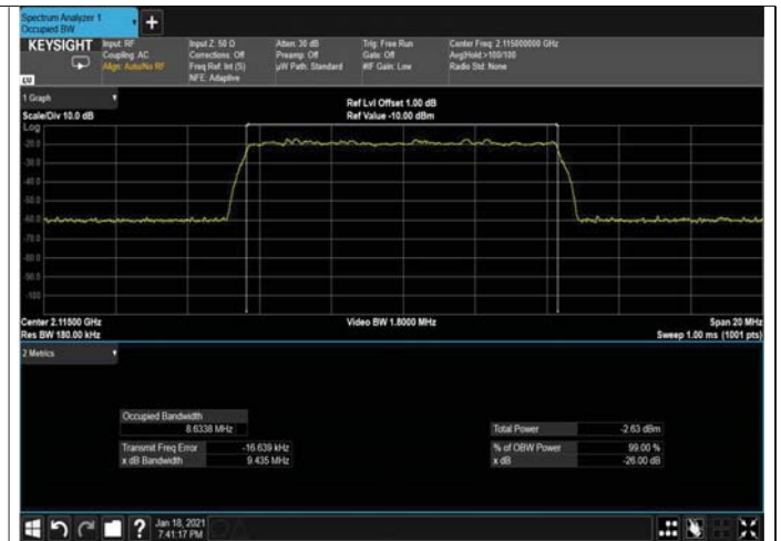
Figure 202: 64QAM 10MHz B.W; 2115.0MHz, 30kHz INPUT
