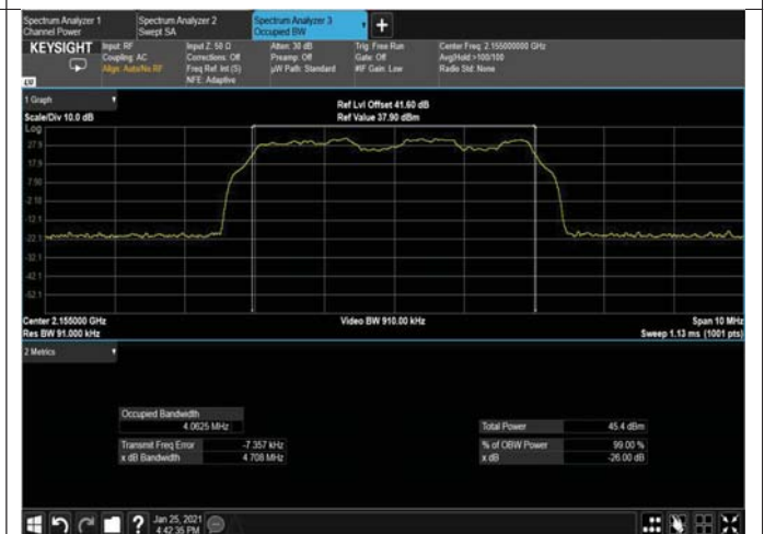
Figure 252: 16QAM 5MHz B.W; 2155.0MHz, 30kHz OUTPUT
