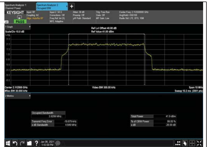
Figure 268: 64QAM 5MHz B.W; 2112.5MHz, 30kHz OUTPUT
