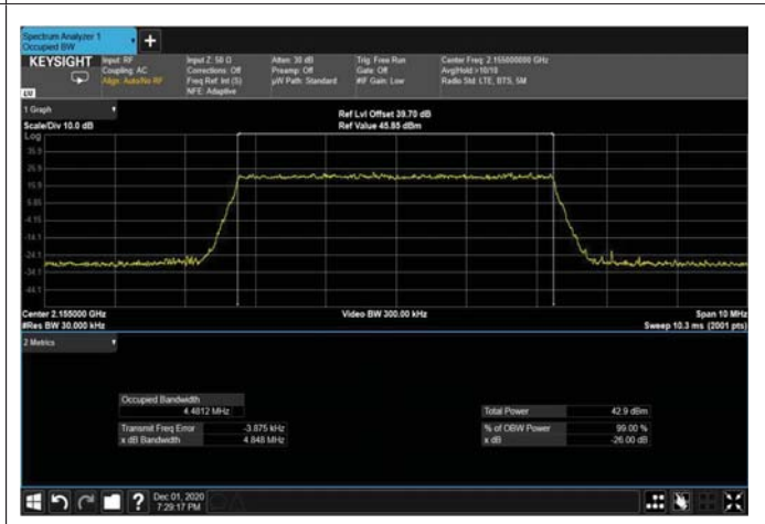
Figure 373: QPSK 5MHz B.W; 2155MHz – 4G OUTPUT
