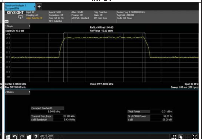
Figure 224: 256QAM 10MHz B.W; 2195.0MHz, 30kHz INPUT
