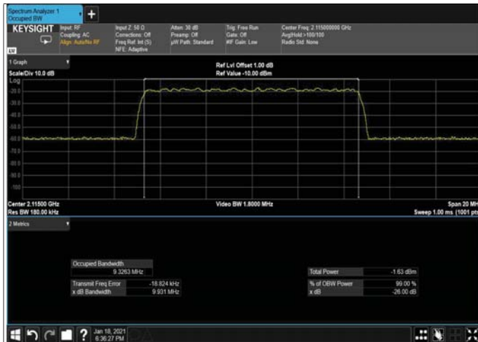
Figure 219: 256QAM 10MHz B.W; 2115.0MHz, 15kHz INPUT
