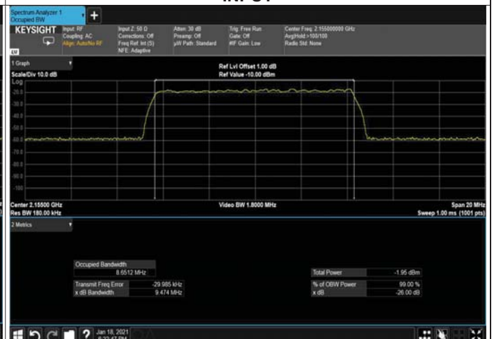
Figure 222: 256QAM 10MHz B.W; 2155.0MHz, 30kHz INPUT
