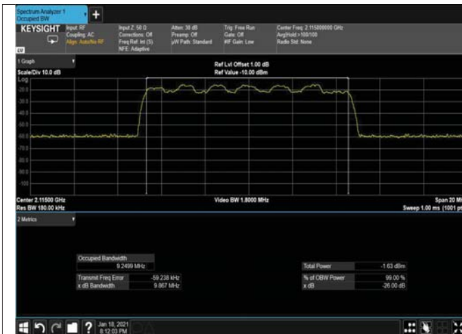
Figure 183: 16QAM 10MHz B.W; 2115.0MHz, 15kHz INPUT
