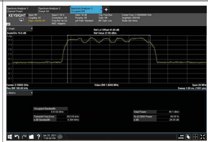
Figure 312: QPSK 10MHz B.W; 2155MHz, 30kHz OUTPUT
