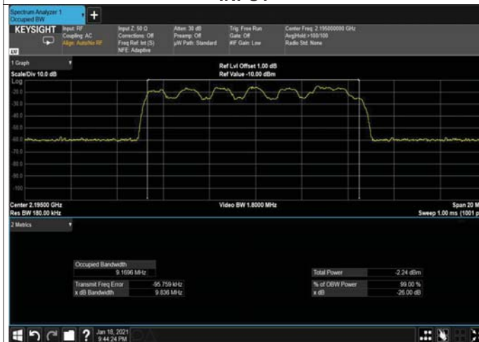
Figure 241: QPSK 10MHz B.W; 2192.5.0MHz, 15kHz INPUT
