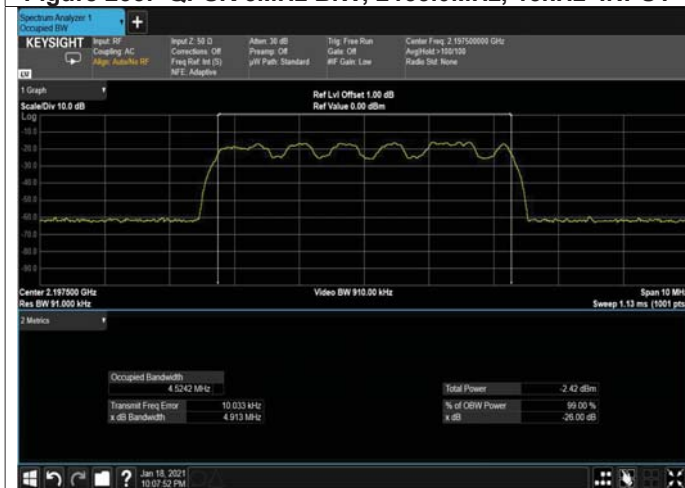
Figure 235: QPSK 5MHz B.W; 2197.5MHz, 15kHz INPUT
