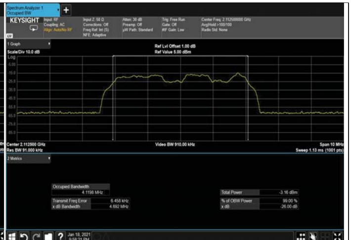
Figure 232: QPSK 5MHz B.W; 2112.5MHz, 30kHz INPUT
