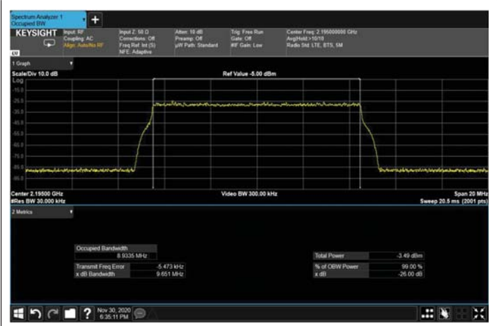
Figure 347: QPSK 10MHz; 2195MHz – 4G INPUT
