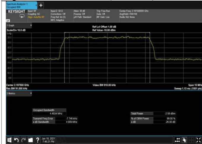
Figure 199: 64QAM 5MHz B.W; 878.0MHz, 15kHz INPUT
