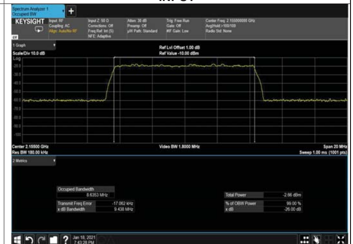
Figure 204: 64QAM 10MHz B.W; 2155.0MHz, 30kHz INPUT
