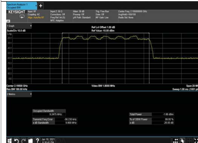
Figure 187: 16QAM 10MHz B.W; 2195.0MHz, 15kHz INPUT
