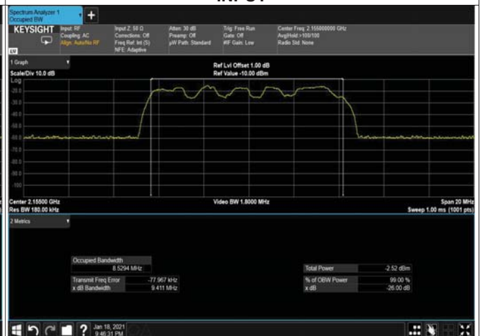
Figure 240: QPSK 10MHz B.W; 2155.0MHz, 30kHz INPUT
