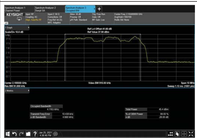
Figure 306: QPSK 5MHz B.W; 2155MHz, 30kHz OUTPUT
