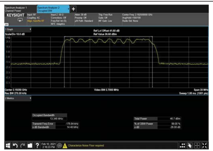
Figure 320: QPSK 15MHz B.W; 2192.5MHz, 30kHz OUTPUT
