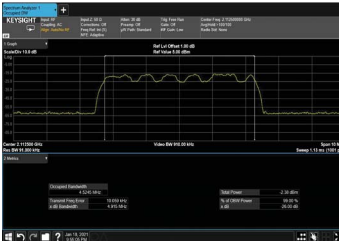
Figure 231: QPSK 5MHz B.W; 2112.5MHz, 15kHz INPUT
