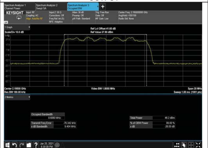
Figure 260: 16QAM 10MHz B.W; 2195.0MHz, 30kHz OUTPUT
