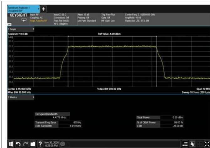
Figure 342: QPSK 5MHz B.W; 2112.5MHz – 4G INPUT
