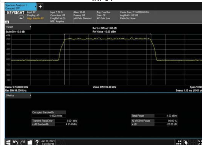
Figure 215: 256QAM 5MHz; 2155.0MHz B.W, 15kHz INPUT
