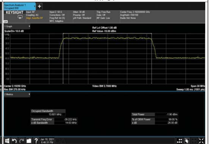
Figure 230: 256QAM 15MHz B.W; 2192.5MHz, 30kHz INPUT
