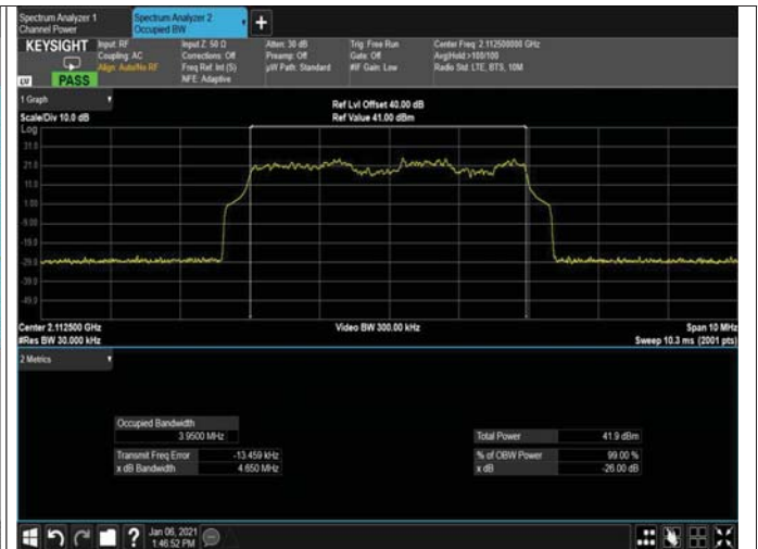
Figure 250: 16QAM 5MHz B.W; 2112.5MHz, 30kHz OUTPUT
