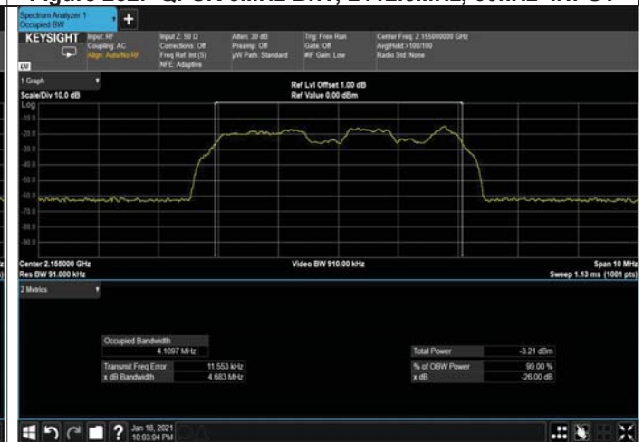
Figure 234: QPSK 5MHz B.W; 2155.0MHz, 30kHz INPUT
