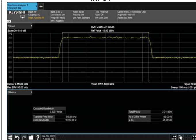
Figure 203: 64QAM 10MHz B.W; 2155.0MHz, 15kHz INPUT
