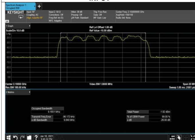
Figure 239: QPSK 10MHz B.W; 2155.0MHz, 15kHz INPUT
