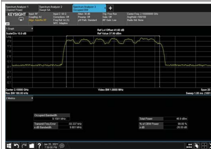
Figure 311: QPSK 10MHz B.W; 2155MHz, 15kHz OUTPUT
