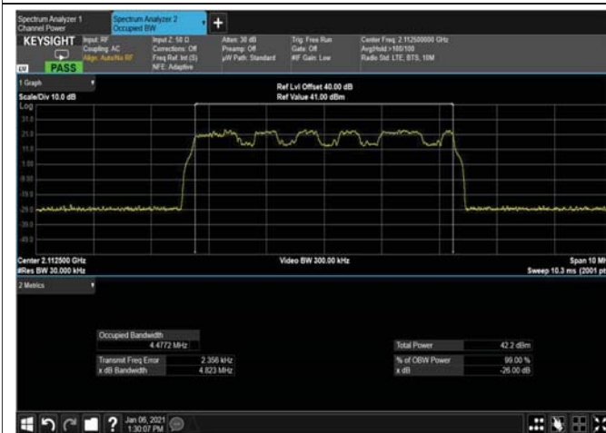
Figure 303: QPSK 5MHz B.W; 2112.5MHz, 15kHz OUTPUT
