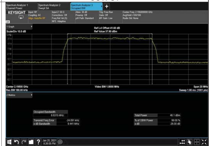
Figure 278: 64QAM 10MHz B.W; 2195.0MHz, 30kHz OUTPUT
