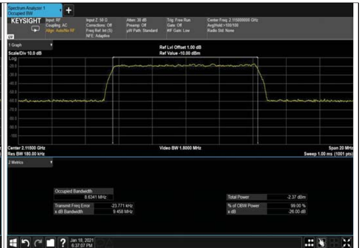
Figure 220: 256QAM 10MHz B.W; 2115.0MHz, 30kHz INPUT
