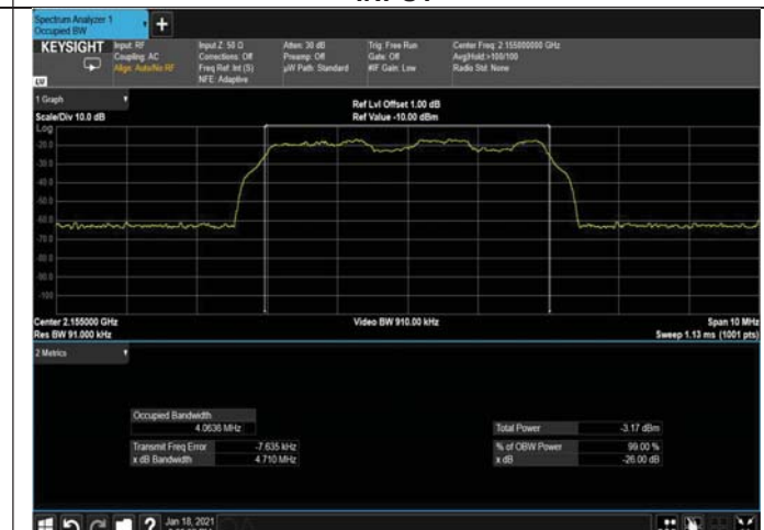
Figure 180: 16QAM 5MHz B.W; 2155.0MHz, 30kHz INPUT
