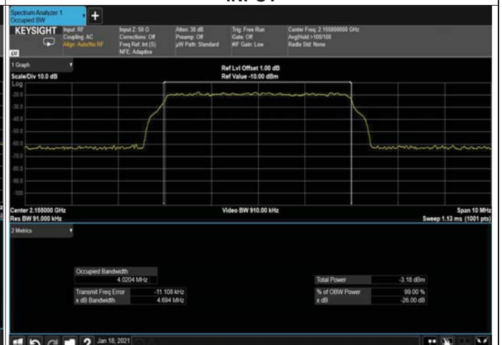
Figure 216: 256QAM 5MHz; 2155.0MHz B.W, 30kHz INPUT
