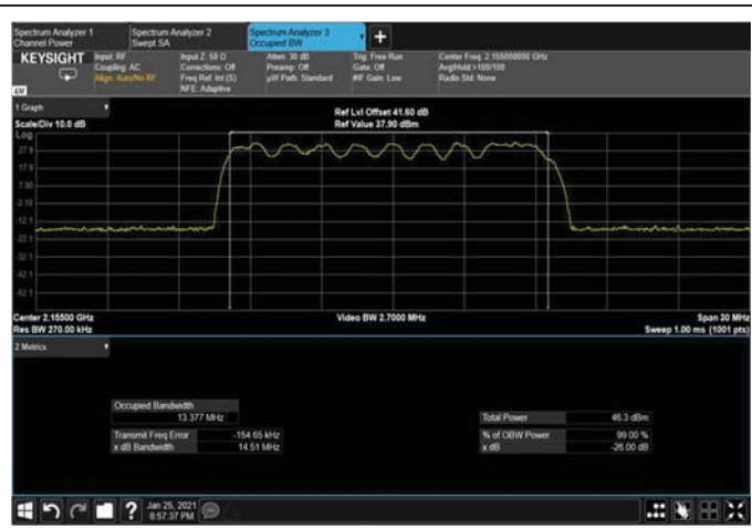
Figure 318: QPSK 15MHz B.W; 2155MHz, 30kHz OUTPUT
