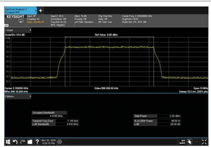
Figure 343: QPSK 5MHz B.W; 2155MHz – 4G INPUT
