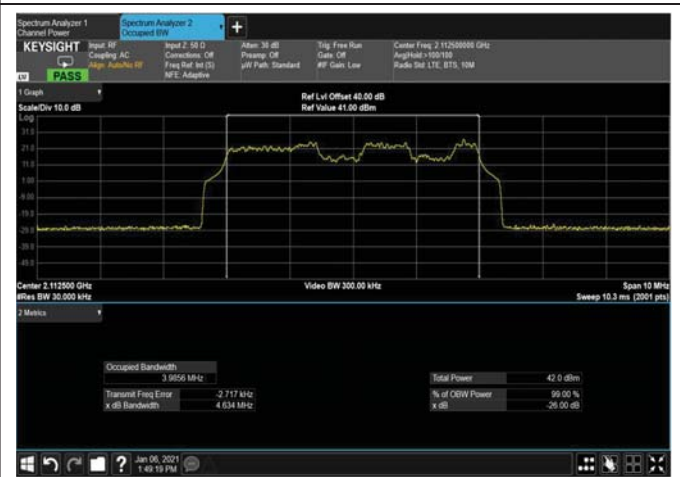
Figure 304: QPSK 5MHz B.W; 2112.5MHz, 30kHz OUTPUT
