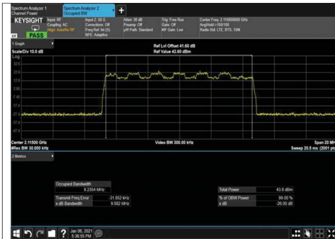
Figure 255: 16QAM 10MHz B.W; 2115.0MHz, 15kHz OUTPUT
