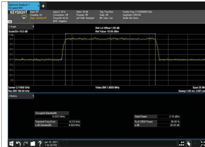
Figure 201: 64QAM 10MHz B.W; 2115.0MHz, 15kHz INPUT
