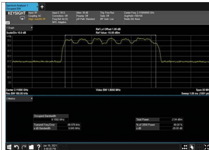
Figure 237: QPSK 10MHz B.W; 2115.0MHz, 15kHz INPUT
