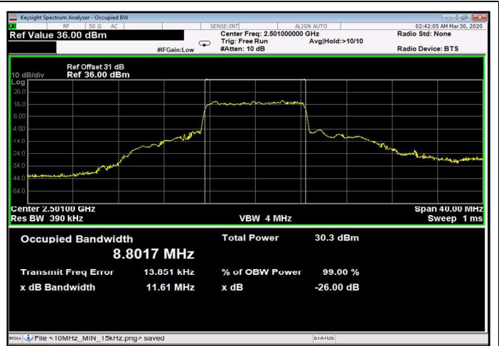
Figure 352: 64QAM 10MHz B.W.; 2501.0MHz, 30kHz Output
