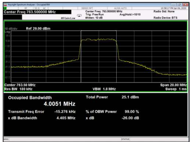
Figure 176: 64QAM 5MHz B.W.; 763.5MHz, 30kHz Output
