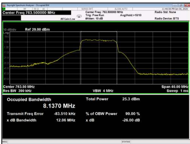
Figure 215: QPSK 10MHz B.W.; 763.5MHz, 60kHz Output
