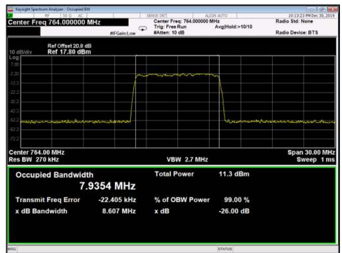
Figure 126: 64QAM 10MHz B.W.; 764.0MHz, 60kHz Input
