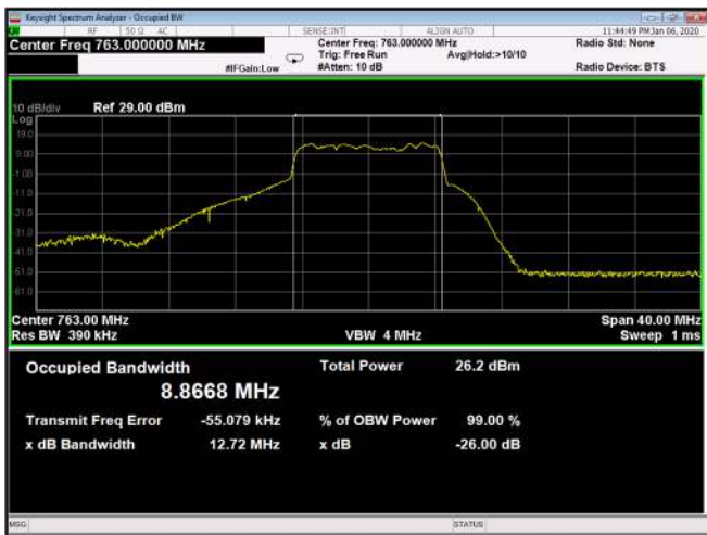
Figure 211: QPSK 10MHz B.W.; 763.0MHz, 30kHz Output
