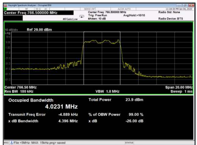
Figure 162: 16QAM 5MHz C.S.; 766.5MHz, 30kHz Output
