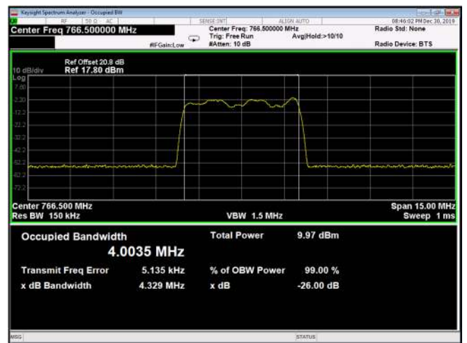
Figure 102: 16QAM 5MHz C.S.; 766.5MHz, 30kHz Input
