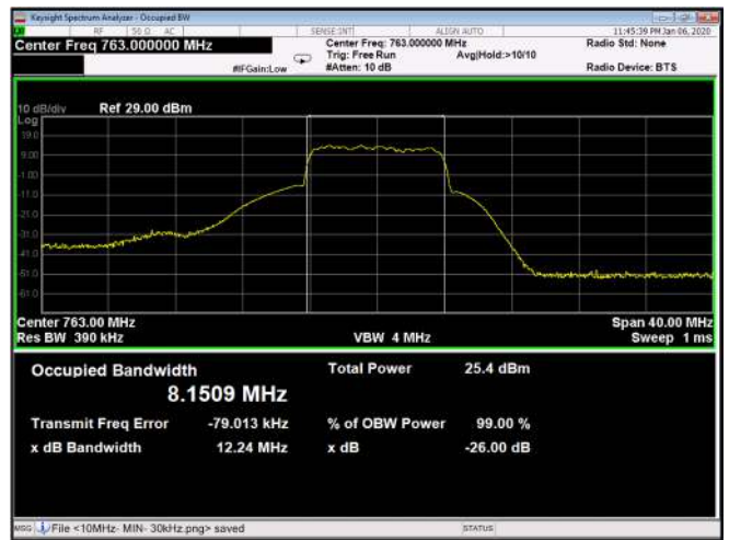
Figure 214: QPSK 10MHz B.W.; 763.0MHz, 60kHz Output
