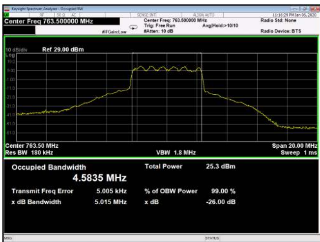
Figure 161: 16QAM 5MHz B.W.; 763.5MHz, 30kHz Output
