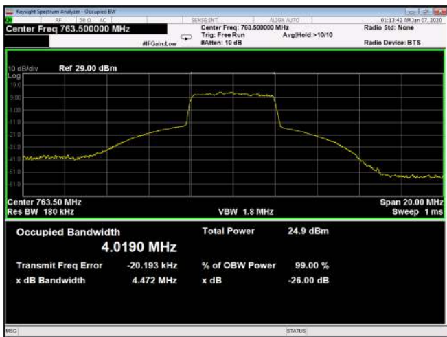
Figure 191: 256QAM 5MHz B.W.; 763.5MHz, 30kHz Output
