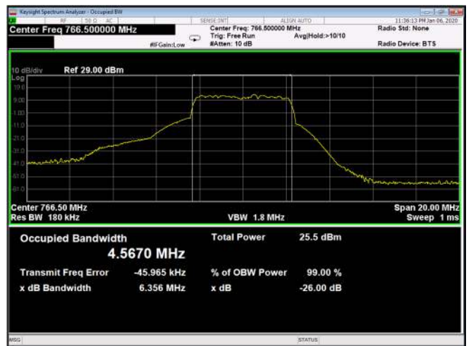
Figure 204: QPSK 5MHz B.W.; 766.5MHz, 15kHz Output
