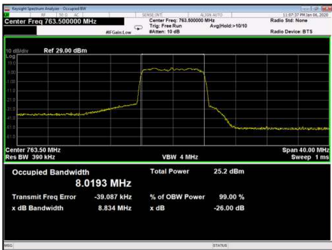
Figure 185: 64QAM 10MHz B.W.; 763.5MHz, 60kHz Output
