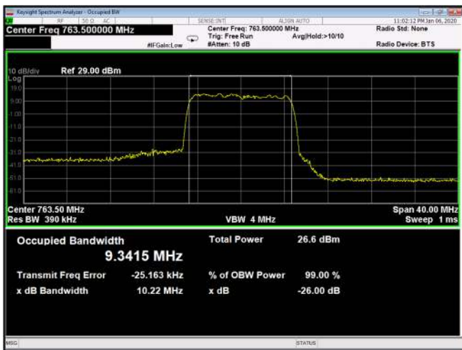
Figure 179: 64QAM 10MHz B.W.; 763.5MHz, 15kHz Output
