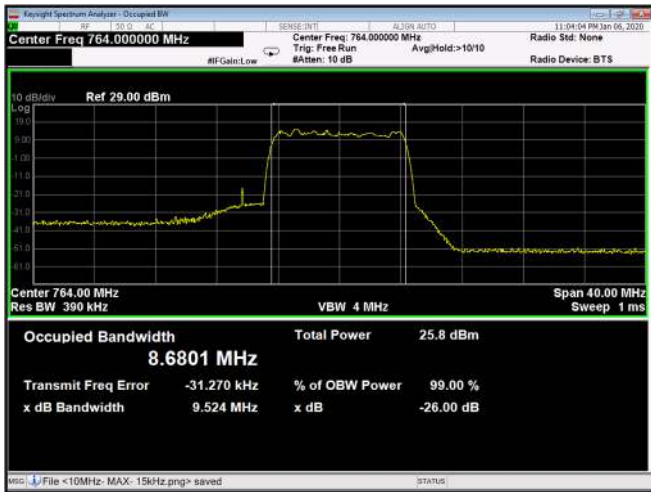
Figure 183: 64QAM 10MHz B.W.; 764.0MHz, 30kHz Output
