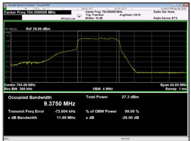
Figure 210: QPSK 10MHz B.W.; 764.0MHz, 15kHz Output
