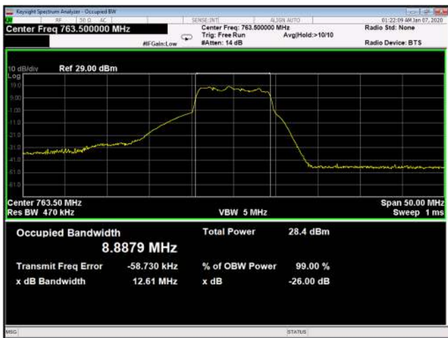
Figure 197: 256QAM 10MHz B.W.; 763.5MHz, 30kHz Output
