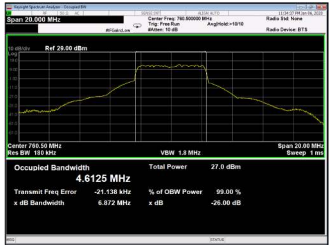
Figure 202: QPSK 5MHz B.W.; 760.5MHz, 15kHz Output
