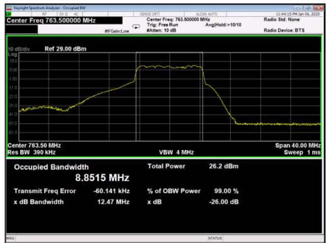
Figure 212: QPSK 10MHz B.W.; 763.5MHz, 30kHz Output
