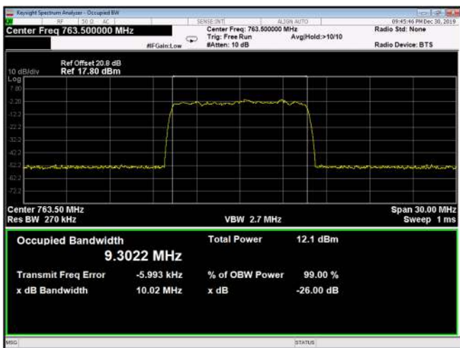
Figure 149: QPSK 10MHz B.W.; 763.5MHz, 15kHz Input
