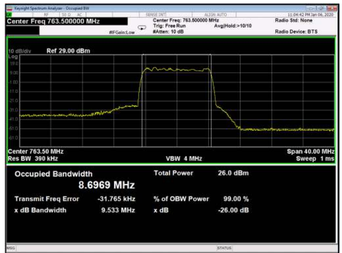
Figure 182: 64QAM 10MHz B.W.; 763.5MHz, 30kHz Output
