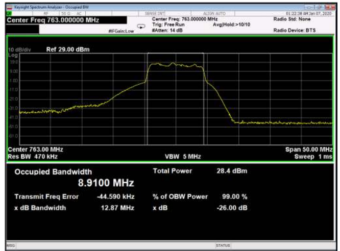
Figure 196: 256QAM 10MHz B.W.; 763.0MHz, 30kHz Output
