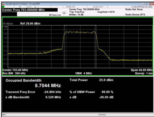
Figure 181: 64QAM 10MHz B.W.; 763.0MHz, 30kHz Output
