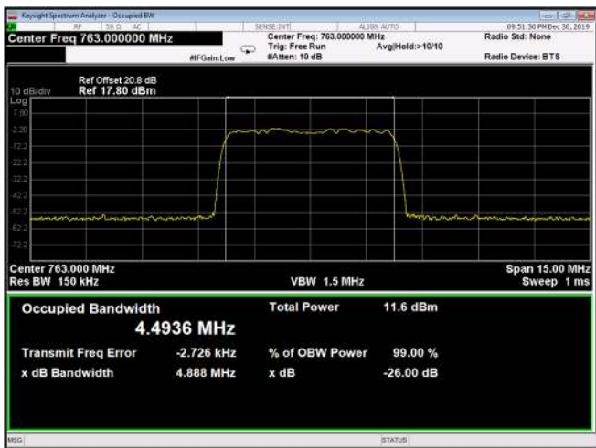
Figure 143: QPSK 5MHz B.W.; 763.0MHz, 15kHz Input
