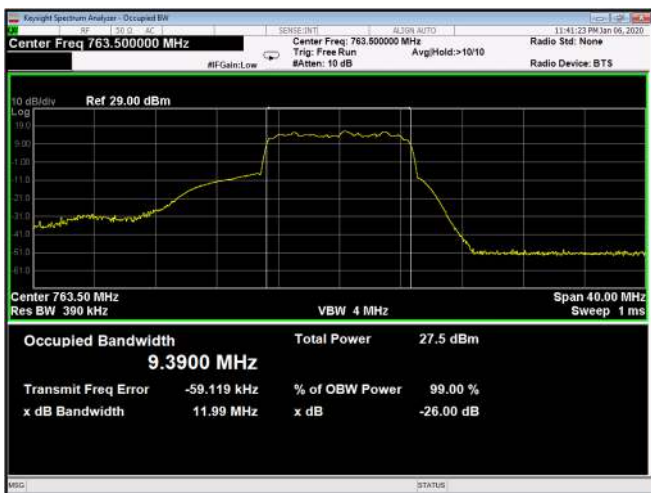
Figure 209: QPSK 10MHz B.W.; 763.5MHz, 15kHz Output
