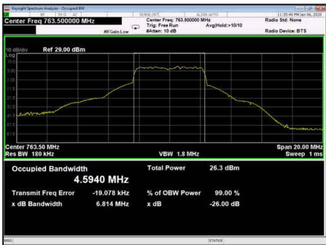
Figure 203: QPSK 5MHz B.W.; 763.5MHz, 15kHz Output
