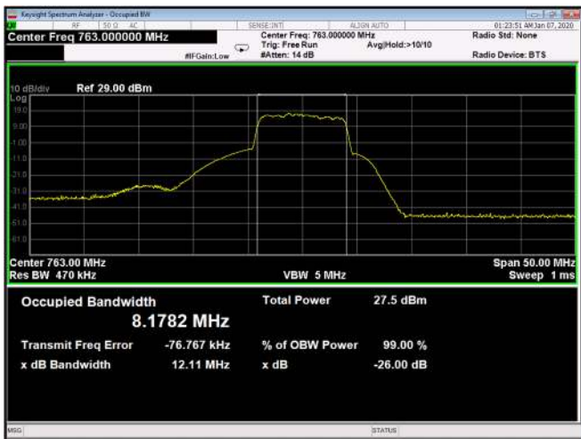
Figure 199: 256QAM 10MHz B.W.; 763.0MHz, 60kHz Output
