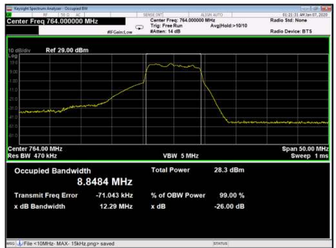
Figure 198: 256QAM 10MHz B.W.; 764.0MHz, 30kHz Output
