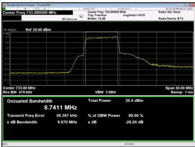
Figure 529: 64QAM 10MHz B.W.; 733.0MHz, 60kHz Output
