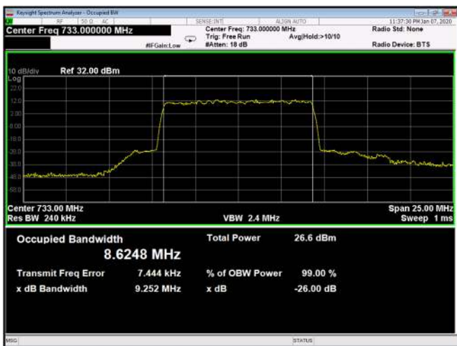
Figure 595: QPSK 10MHz B.W.; 733MHz, 30kHz Output
