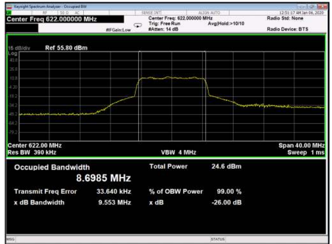
Figure 564: 256QAM 10MHz B.W; 622.0MHz, 30kHz Output
