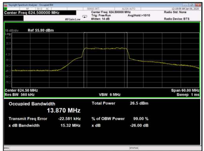
Figure 606: QPSK 15MHz B.W; 624.5MHz, 30kHz Output
