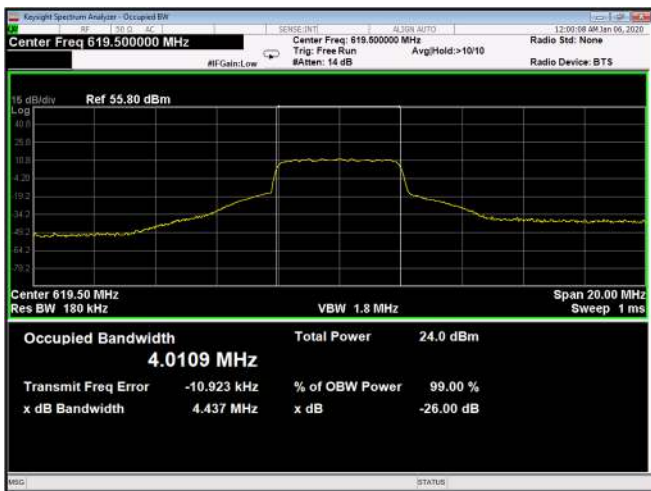
Figure 591: QPSK 5MHz B.W; 619.5MHz, 30kHz Output
