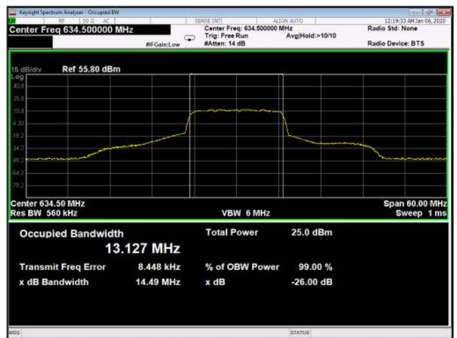
Figure 610: QPSK 15MHz B.W; 634.5MHz, 60kHz Output
