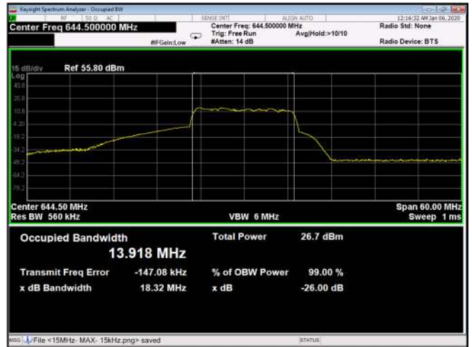
Figure 612: QPSK 15MHz B.W; 644.5MHz, 30kHz Output
