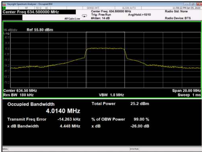
Figure 593: QPSK 5MHz B.W; 634.5MHz, 30kHz Output
