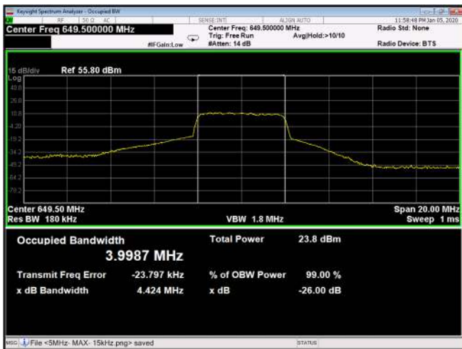
Figure 595: QPSK 5MHz B.W; 649.5MHz, 30kHz Output
