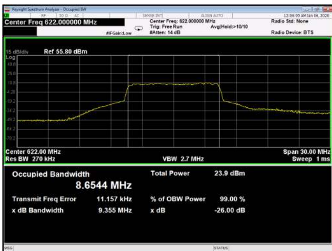
Figure 597: QPSK 10MHz B.W; 622.0MHz, 30kHz Output
