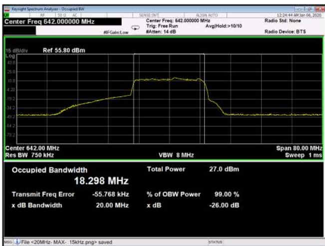
Figure 621: QPSK 20MHz B.W; 642.0MHz, 30kHz Output
