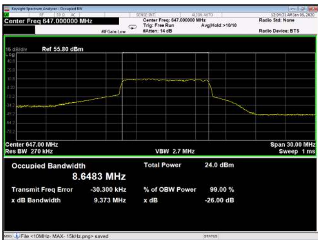
Figure 603: QPSK 10MHz B.W; 647.0MHz, 30kHz Output
