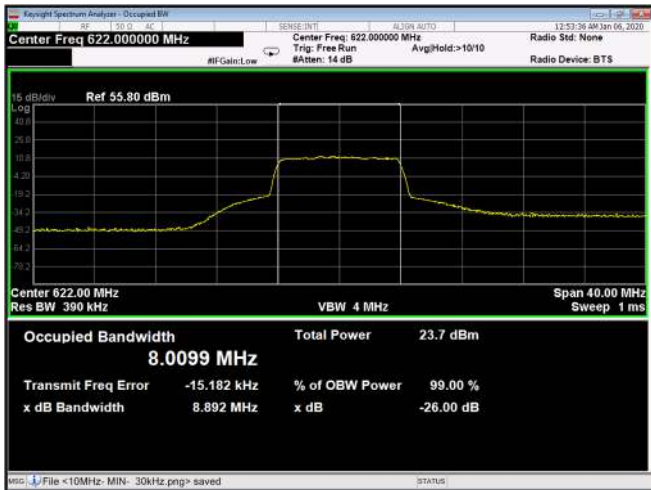
Figure 565: 256QAM 10MHz B.W; 622.0MHz, 60kHz Output
