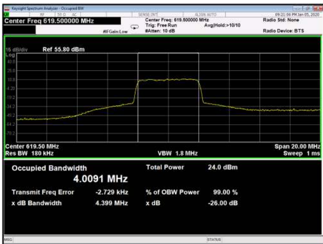
Figure 525: 64QAM 5MHz B.W; 619.5MHz, 30kHz Output
