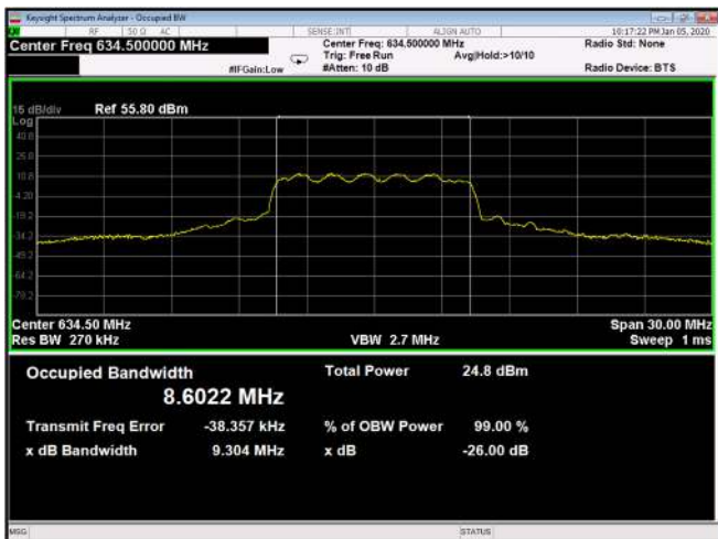
Figure 501: 16QAM 10MHz B.W; 634.5MHz, 30kHz Output
