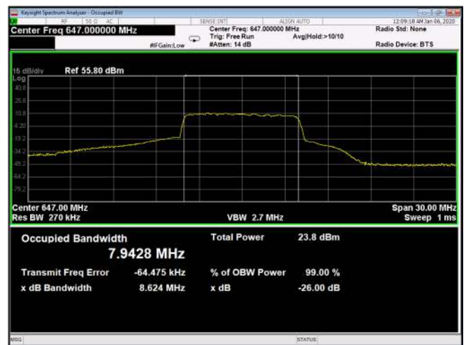
Figure 604: QPSK 10MHz B.W; 647.0MHz, 60kHz Output
