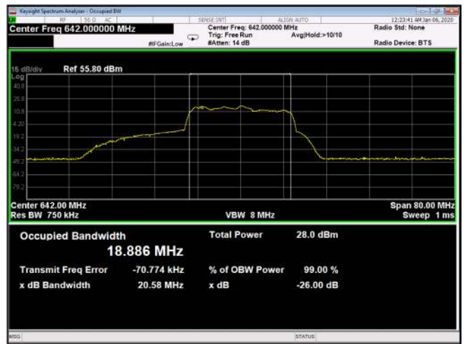
Figure 620: QPSK 20MHz B.W; 642.0MHz, 15kHz Output
