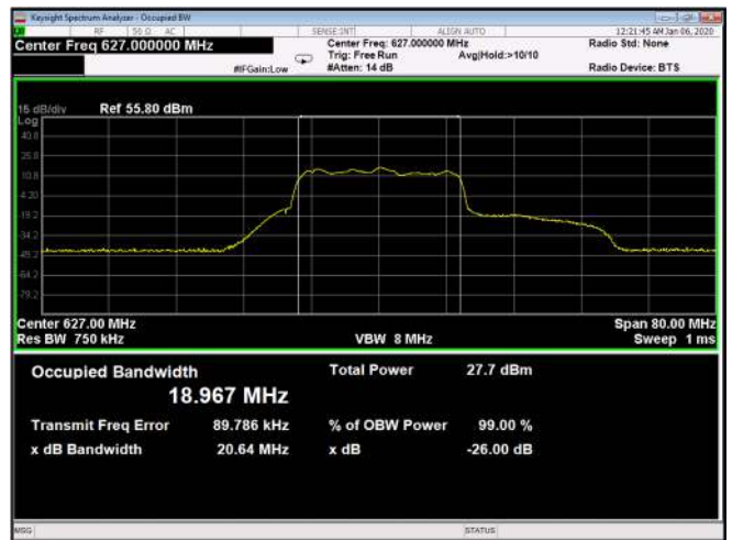
Figure 614: QPSK 20MHz B.W; 627.0MHz, 15kHz Output
