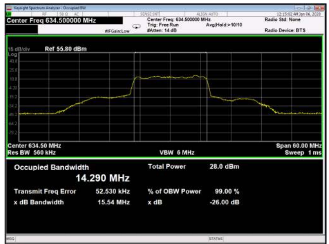
Figure 608: QPSK 15MHz B.W; 634.5MHz, 15kHz Output
