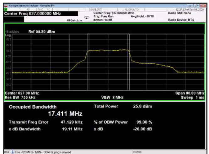
Figure 616: QPSK 20MHz B.W; 627.0MHz, 60kHz Output
