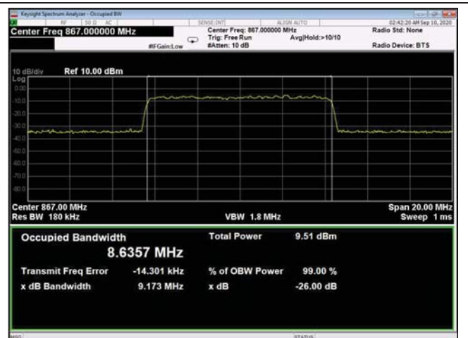
Figure 267: 256QAM 10MHz B.W.; 867.0MHz, 30kHz - Input
