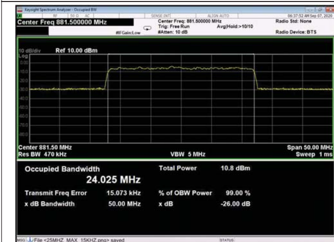
Figure 258: 64QAM 25MHz B.W.; 881.5MHz, 30kHz - Input
