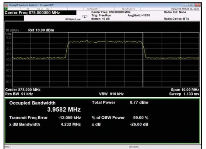
Figure 263: 256QAM 5MHz B.W.; 878.0MHz, 30kHz - Input
