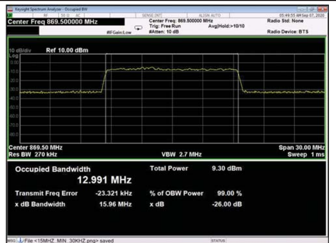
Figure 235: 64QAM 15MHz B.W.; 869.5MHz, 60kHz - Input
