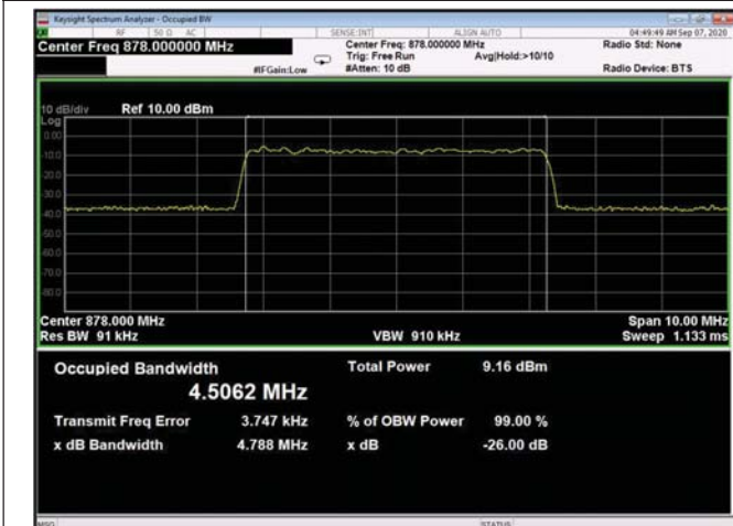
Figure 220: 64QAM 5MHz B.W.; 878.0MHz, 15kHz - Input
