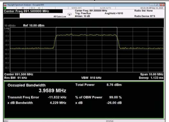
Figure 265: 256QAM 5MHz B.W.; 891.5MHz, 30kHz - Input
