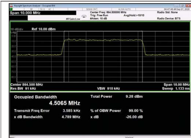
Figure 218: 64QAM 5MHz B.W.; 864.5MHz, 15kHz - Input
