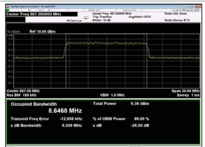
Figure 309: QPSK 10MHz B.W.; 867.0MHz, 30kHz - Input
