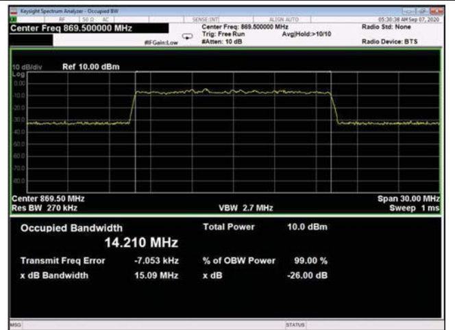
Figure 233: 64QAM 15MHz B.W.; 869.5MHz, 15kHz- Input
