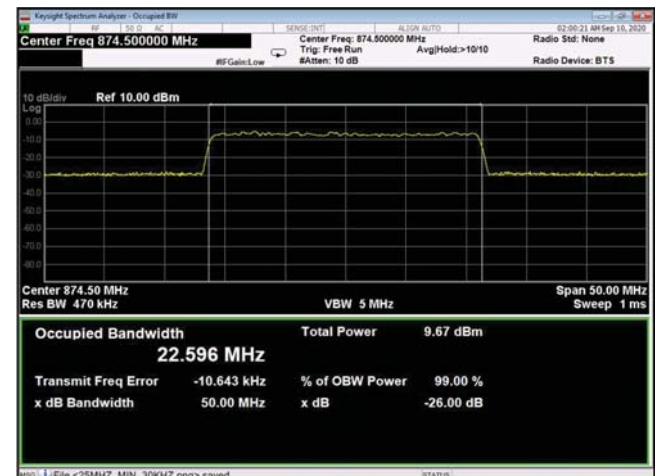
Figure 337: QPSK 25MHz B.W.; 874.5MHz, 60kHz - Input
