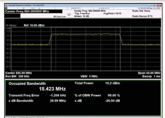
Figure 333: QPSK 20MHz B.W.; 884.0MHz, 30kHz - Input
