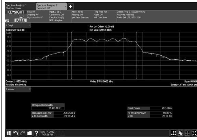
Figure 233: 16QAM 20MHz B.W.; 2155.0MHz, 60kHz Output
