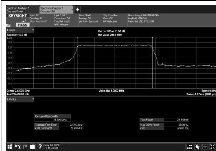
Figure 301: 256QAM 20MHz B.W.; 2190.0MHz, 30kHz Output
