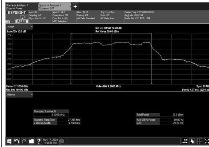
Figure 213: 16QAM 10MHz B.W.; 2115.0MHz, 60kHz Output
