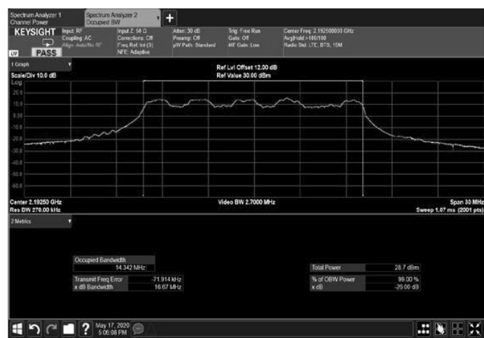
Figure 226: 16QAM 15MHz B.W.; 2192.5MHz, 15kHz Output
