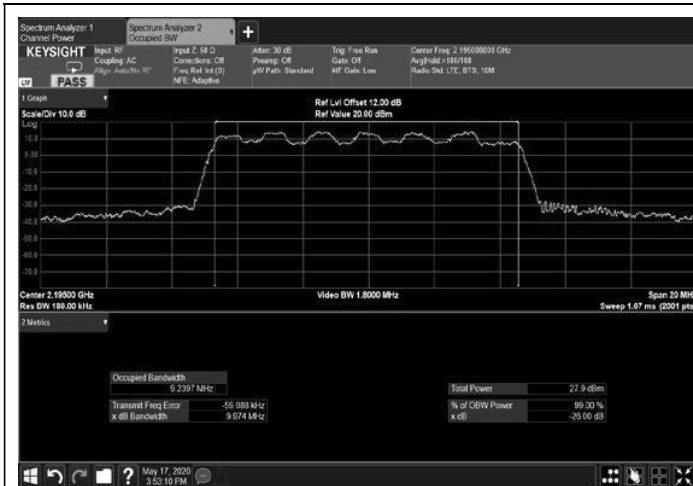
Figure 217: 16QAM 10MHz B.W.; 2195.0MHz, 15kHz Output
