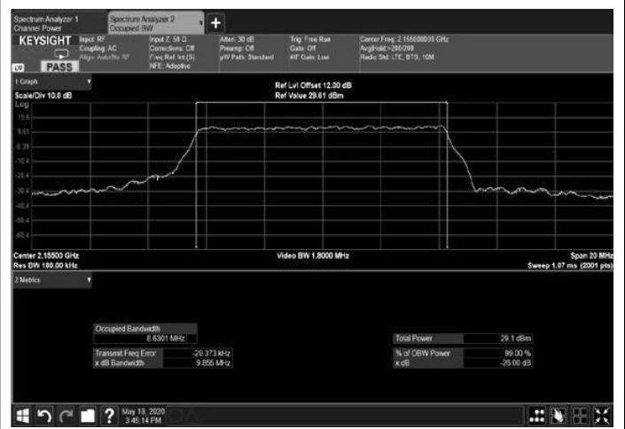
Figure 280: 256QAM 10MHz B.W.; 2155.0MHz, 30kHz Output
