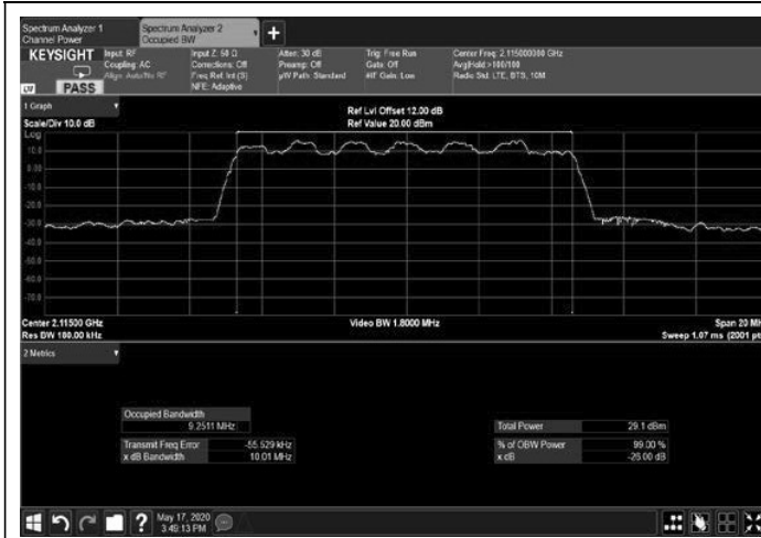
Figure 211: 16QAM 10MHz B.W.; 2115.0MHz, 15kHz Output
