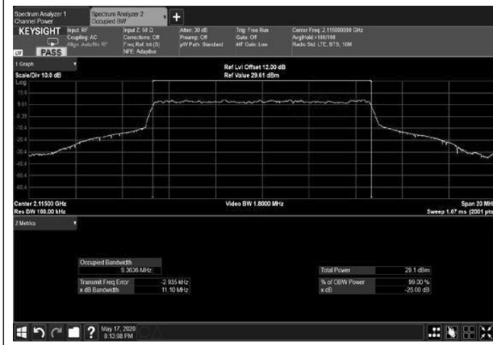
Figure 243: 64QAM 10MHz B.W.; 2115.0MHz, 15kHz Output
