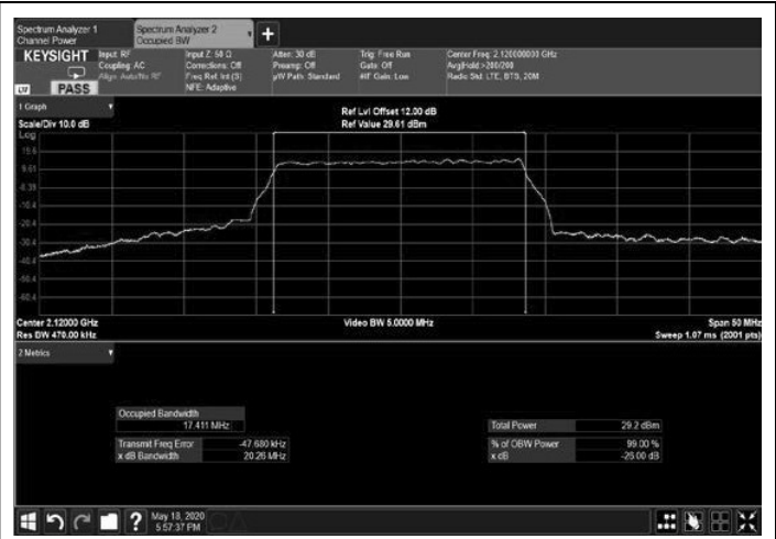
Figure 296: 256QAM 20MHz B.W.; 2120.0MHz, 60kHz Output
