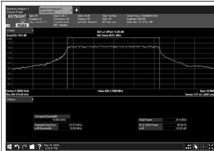
Figure 289: 256QAM 15MHz B.W.; 2155.0MHz, 30kHz Output
