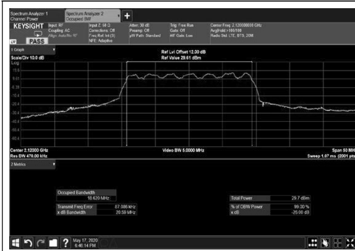
Figure 229: 16QAM 20MHz B.W.; 2120.0MHz, 30kHz Output
