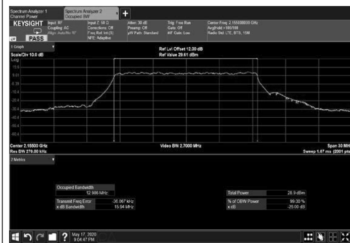
Figure 257: 64QAM 15MHz B.W.; 2155.0MHz, 60kHz Output
