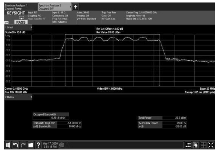
Figure 214: 16QAM 10MHz B.W.; 2155.0MHz, 15kHz Output
