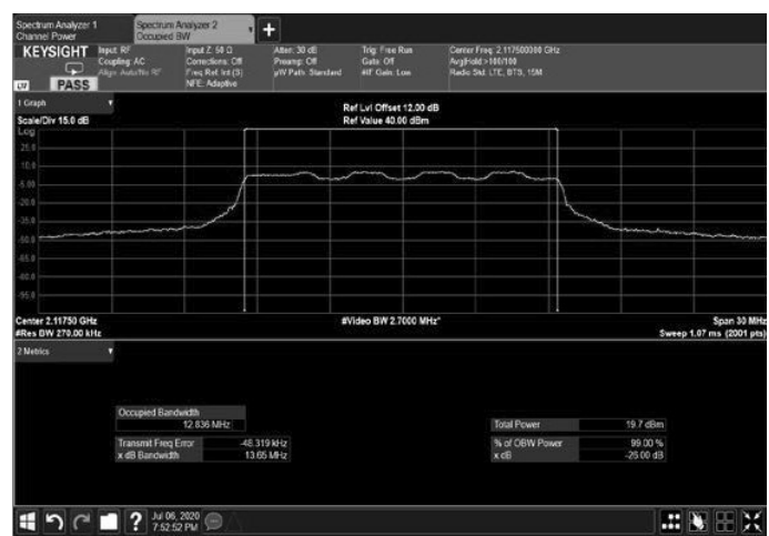
Figure 222: 16QAM 15MHz B.W.; 2117.5MHz, 60kHz Output
