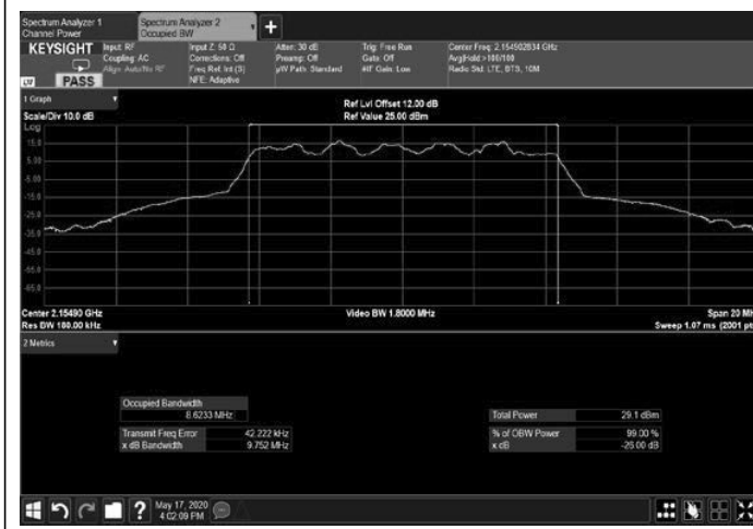
Figure 215: 16QAM 10MHz B.W.; 2155.0MHz, 30kHz Output
