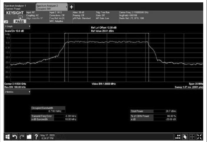
Figure 244: 64QAM 10MHz B.W.; 2115.0MHz, 30kHz Output
