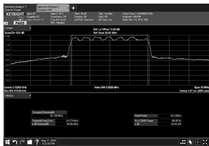
Figure 228: 16QAM 20MHz B.W.; 2120.0MHz, 15kHz Output
