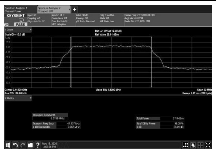
Figure 278: 256QAM 10MHz B.W.; 2115.0MHz, 60kHz Output
