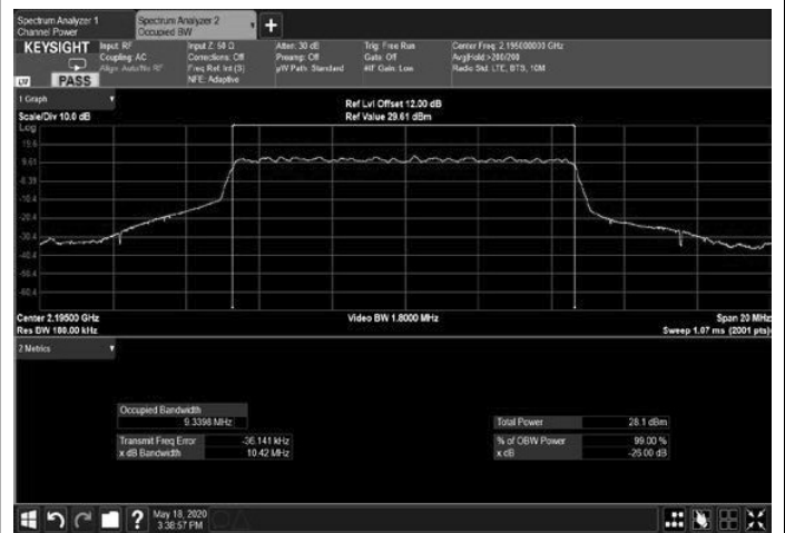
Figure 282: 256QAM 10MHz B.W.; 2195.0MHz, 15kHz Output
