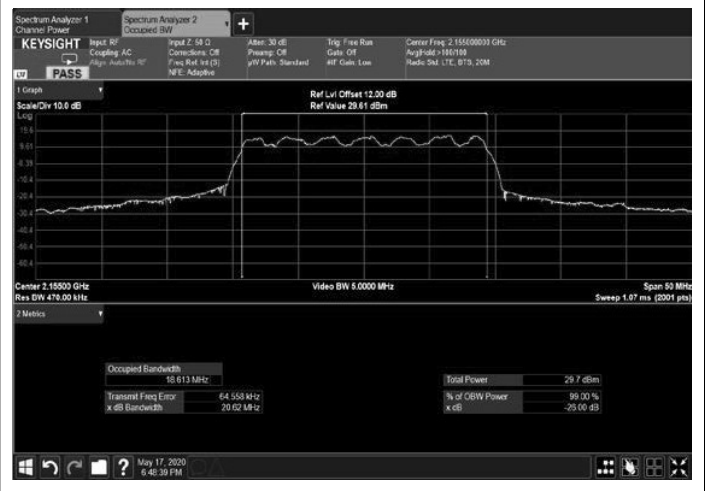
Figure 232: 16QAM 20MHz B.W.; 2155.0MHz, 30kHz Output
