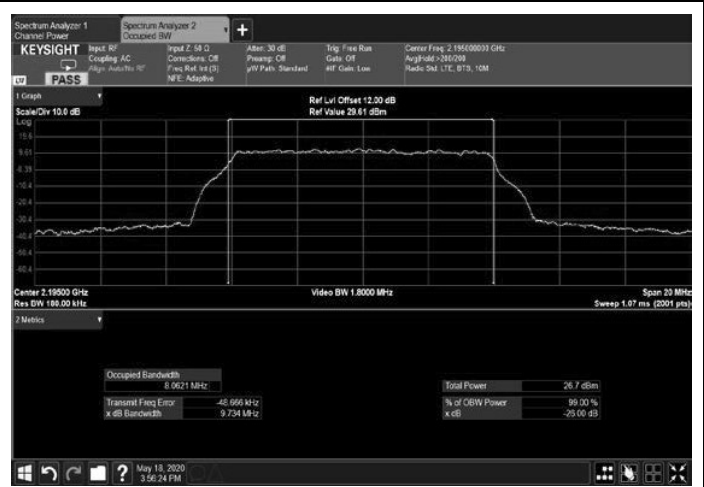
Figure 284: 256QAM 10MHz B.W.; 2195.0MHz, 60kHz Output
