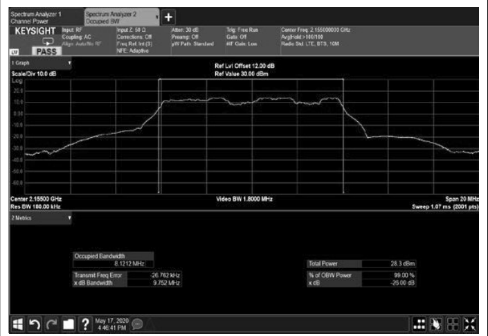
Figure 216: 16QAM 10MHz B.W.; 2155.0MHz, 60kHz Output
