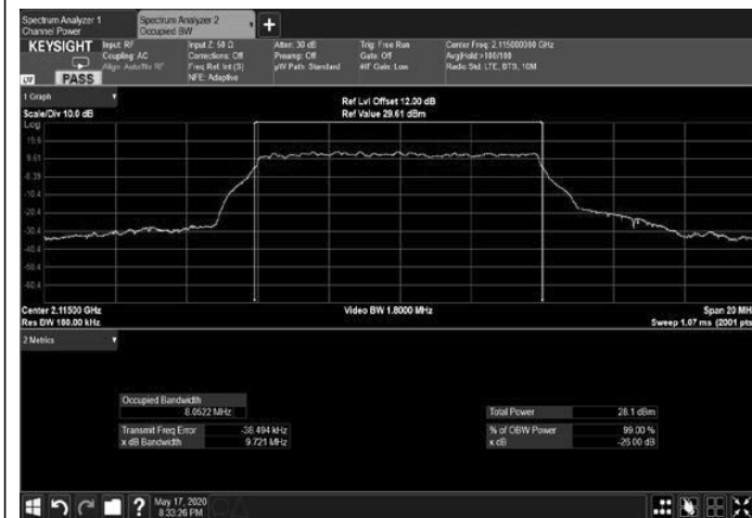
Figure 245: 64QAM 10MHz B.W.; 2115.0MHz, 60kHz Output
