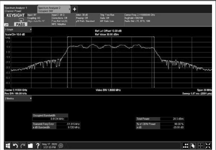
Figure 212: 16QAM 10MHz B.W.; 2115.0MHz, 30kHz Output
