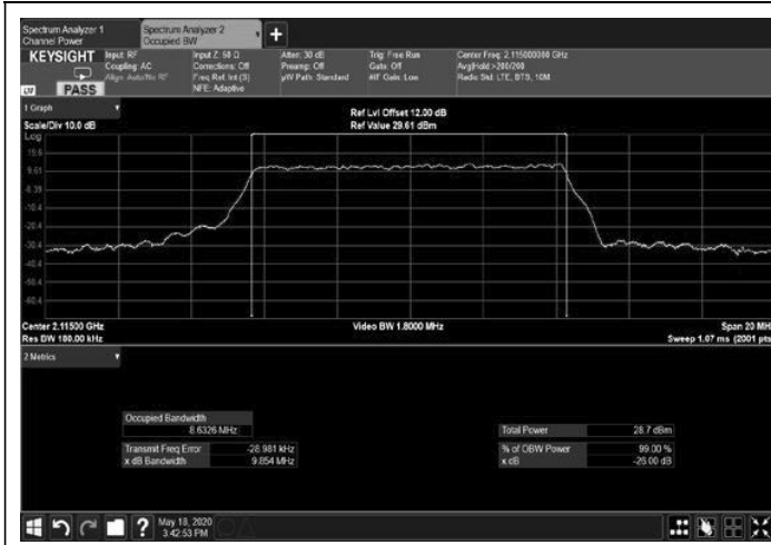
Figure 277: 256QAM 10MHz B.W.; 2115.0MHz, 30kHz Output
