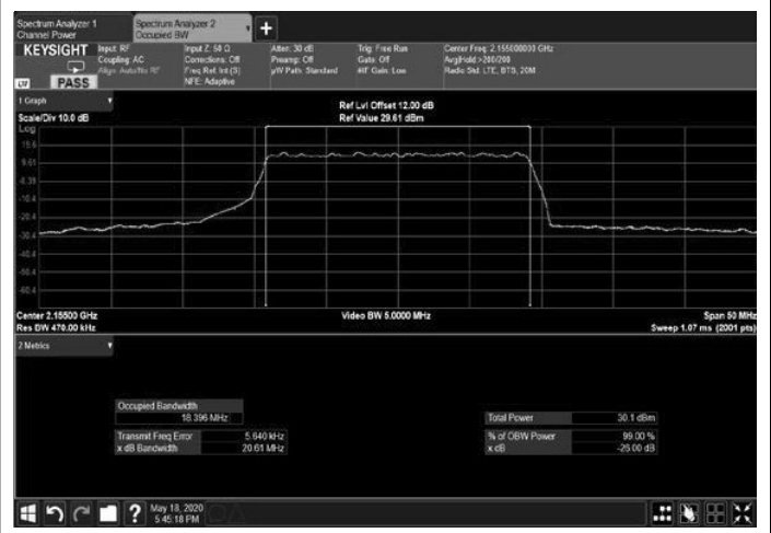
Figure 298: 256QAM 20MHz B.W.; 2155.0MHz, 30kHz Output
