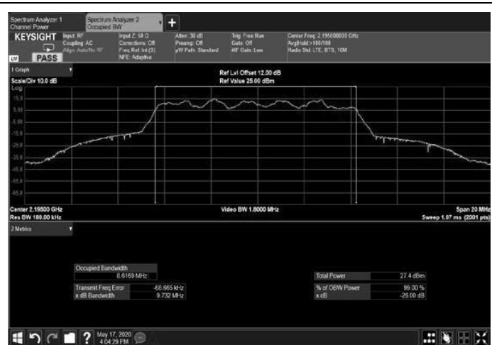
Figure 218: 16QAM 10MHz B.W.; 2195.0MHz, 30kHz Output
