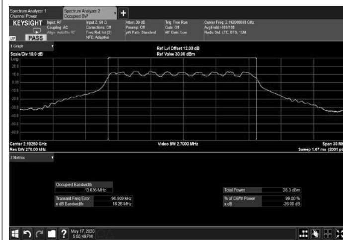
Figure 227: 16QAM 15MHz B.W.; 2192.5MHz, 30kHz Output
