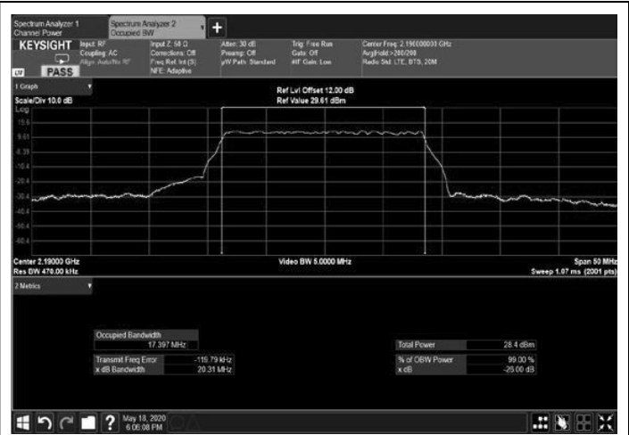
Figure 302: 256QAM 20MHz B.W.; 2190.0MHz, 60kHz Output
