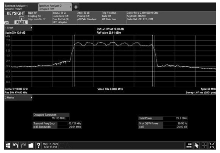
Figure 234: 16QAM 20MHz B.W.; 2190.0MHz, 15kHz Output
