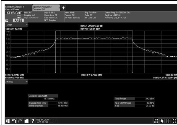
Figure 253: 64QAM 15MHz B.W.; 2117.5MHz, 30kHz Output
