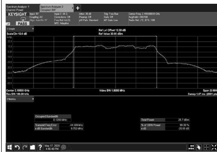
Figure 219: 16QAM 10MHz B.W.; 2195.0MHz, 60kHz Output
