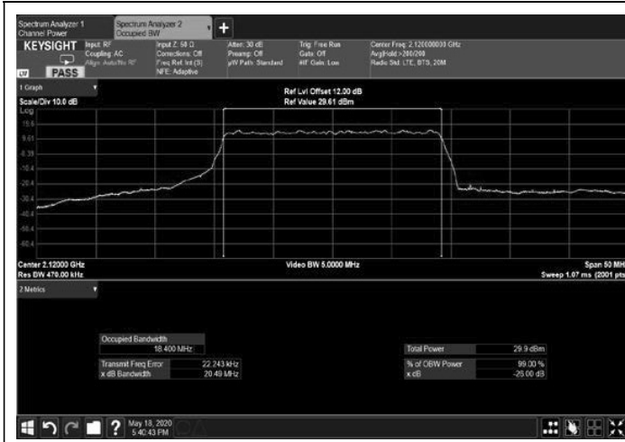
Figure 295: 256QAM 20MHz B.W.; 2120.0MHz, 30kHz Output
