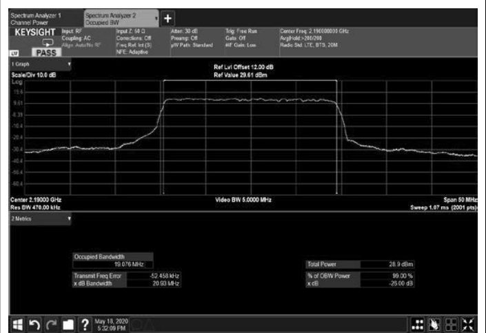
Figure 300: 256QAM 20MHz B.W.; 2190.0MHz, 15kHz Output
