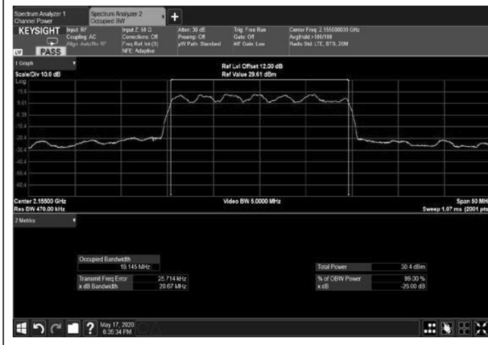
Figure 231: 16QAM 20MHz B.W.; 2155.0MHz, 15kHz Output
