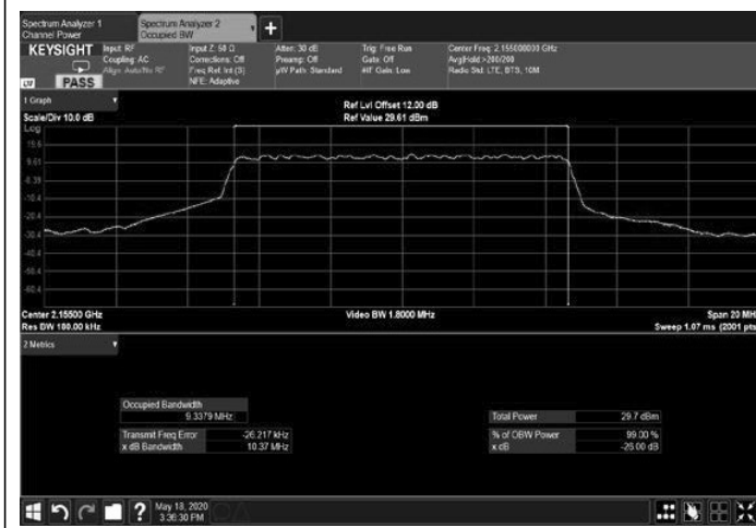
Figure 279: 256QAM 10MHz B.W.; 2155.0MHz, 15kHz Output
