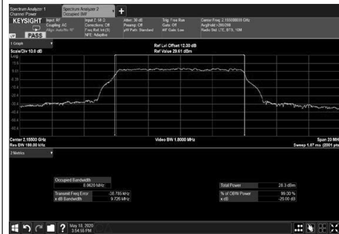
Figure 281: 256QAM 10MHz B.W.; 2155.0MHz, 60kHz Output
