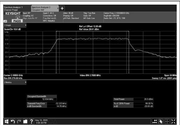
Figure 290: 256QAM 15MHz B.W.; 2155.0MHz, 60kHz Output
