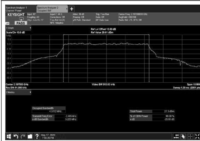
Figure 241: 64QAM 5MHz B.W.; 2197.5MHz, 15kHz Output
