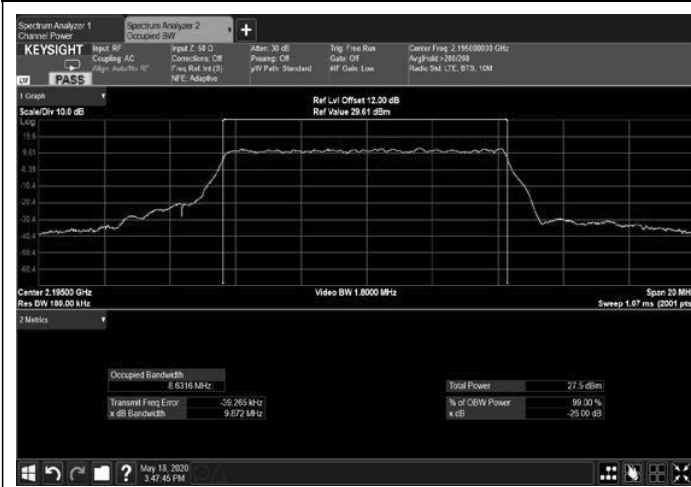
Figure 283: 256QAM 10MHz B.W.; 2195.0MHz, 30kHz Output
