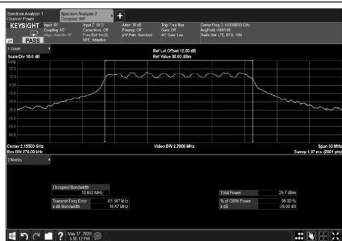
Figure 224: 16QAM 15MHz B.W.; 2155.0MHz, 30kHz Output
