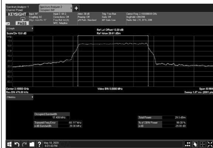
Figure 299: 256QAM 20MHz B.W.; 2155.0MHz, 60kHz Output
