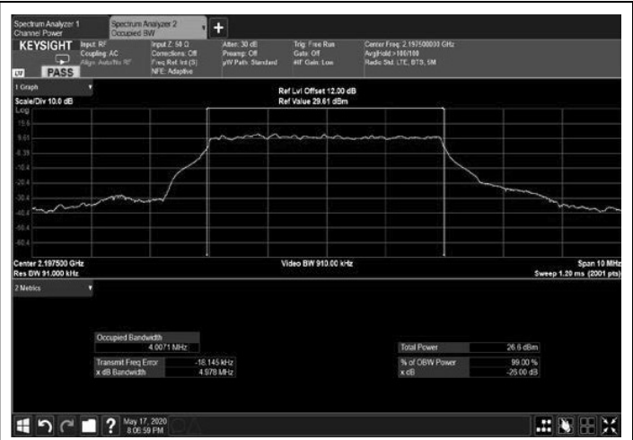
Figure 242: 64QAM 5MHz B.W.; 2197.5MHz, 15kHz Output
