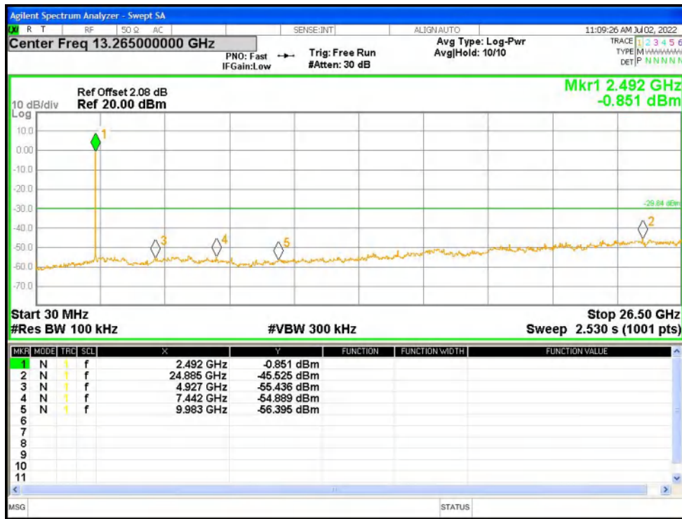
Tx. Spurious NVNT BLE 2M 2402MHz Ant1 Ref
