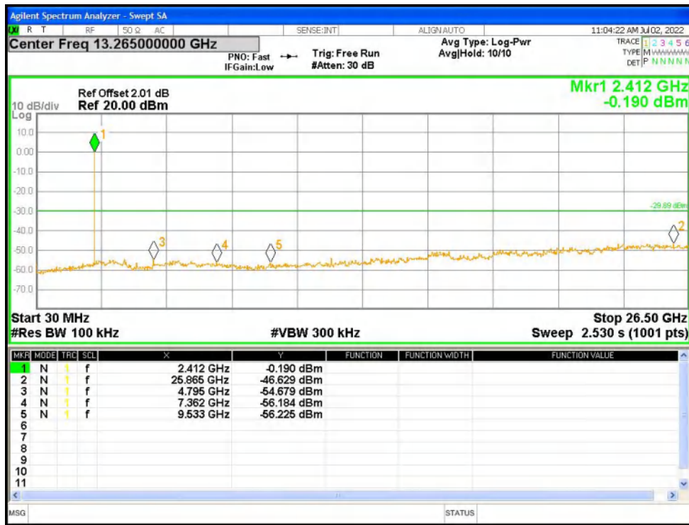
Tx. Spurious NVNT BLE 1M 2442MHz Ant1 Ref
