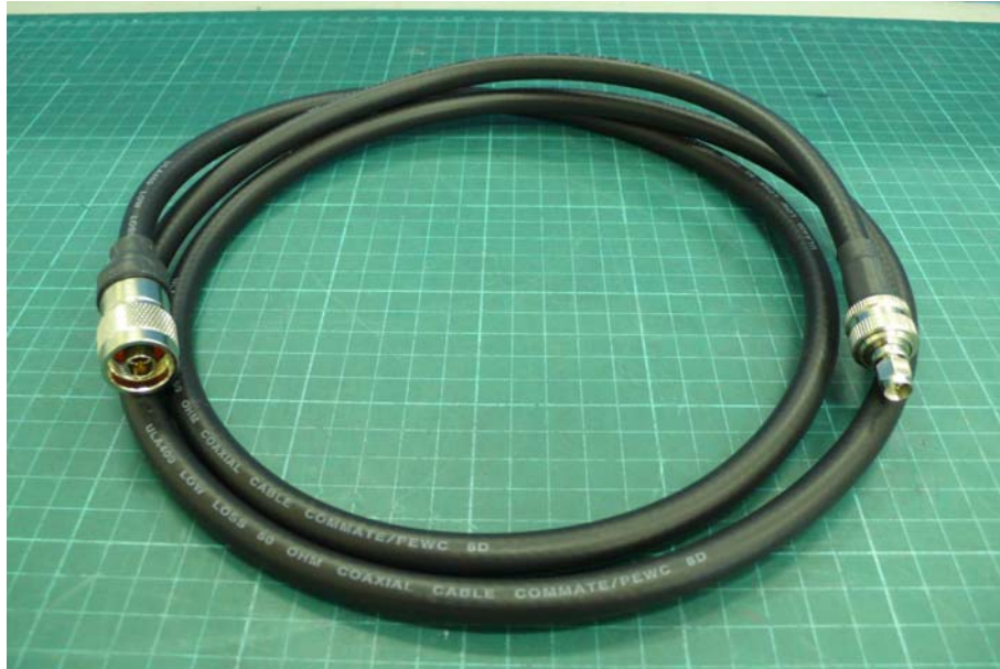
Antenna cable A (3CWE580)
