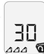
Si fueran varias las personas enterradas o hubiera interferencias en la zona, el dispositivo podría llegar a sufrir una sobrecarga de datos. En tal caso, deberá alejarse de la zona específica y, a continuación, volver a la misma dirigiéndose a una dirección diferente.
