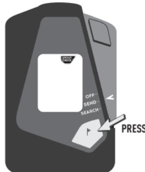
Sedan kan du testa de anda enheterna en efter en genom att placera din enhet 1m bort från enhet du ska kontrollera.
