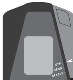
Per accendere il dispositivo, spostare il selettore OFF/SEND/SEARCH (collocato sulla parte superiore destra del dispositivo) verso il basso fin quando il pulsante non si blocca (la punta bianca deve puntare verso "SEND").
