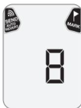
**Achtung:** Wenn die Suche nach weiteren Verschütteten noch läuft, ist darauf zu achten, dass das Gerät nicht in den Sendemodus schaltet, da dies zu Störungen bei der Suche nach anderen Verschütteten führen würde. Denken Sie daran, die Markierungstaste zu drücken, damit Ihr Gerät im Suchmodus bleibt, wenn Sie nicht von einer Nachlawine erfasst wurden.
