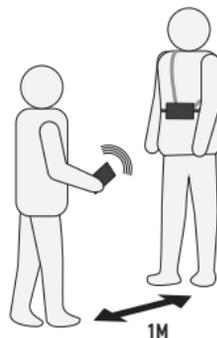
En mode GROUP CHECK, l'EVO5 analyse tout d'abord la fréquence d'émission, si celle-ci n'est pas conforme aux exigences en vigueur, le message "no" apparaît signifiant que l'appareil contrôlé est défectueux et doit donc passer en service après-vente. Si la fréquence est conforme, une distance s'affichera à l'écran et il vous appartient ensuite de contrôler la puissance d'émission :
