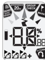
Al encenderse, el dispositivo mostrará la versión de software instalada y la duración restante de la pila. Le recomendamos que reemplace la pila en cuanto la capacidad de esta sea menor al 50% del total. Si mantiene pulsado el botón de marcado mientras el dispositivo está en modo transmisión, podrá visualizar el estado de la pila en cualquier momento.
