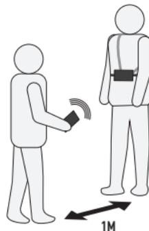
Im GROUP CHECK Modus überprüft das EV05 zunächst die Sendefrequenz. Wenn diese nicht mit den geltenden Anforderungen übereinstimmt, erscheint die Meldung „no“, was bedeutet, dass das kontrollierte Gerät einen Defekt hat und repariert werden muss. Wenn die Frequenz korrekt ist, wird im Display eine Entfernung angezeigt und Sie können dann die Sendeleistung prüfen:
