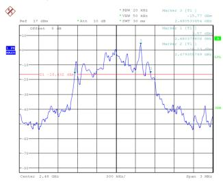
Fig.78 20dB Bandwidth: π/4 DQPSK, Ch78
