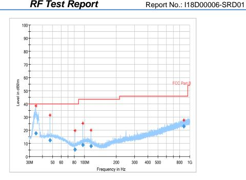
Fig.45 Radiated emission:  $\pi/4$  DQPSK, Ch0, 30MHz~1GHz
