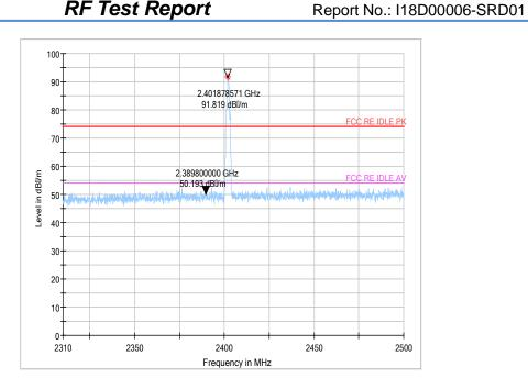
Fig.48 Radiated emission (Power):  $\pi/4$  DQPSK, low channel
