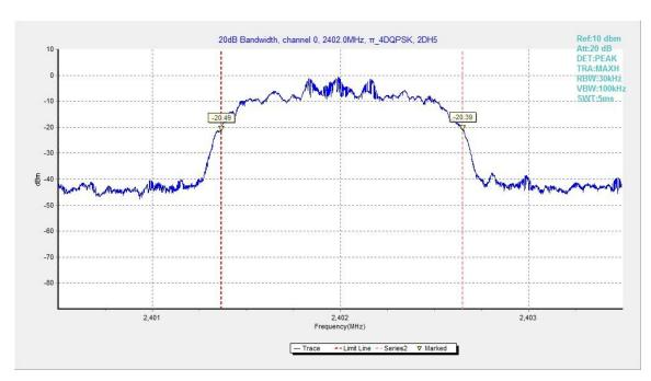
Fig.85. 20dB Bandwidth:  $\pi/4$  DQPSK, Channel 0
