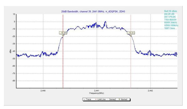
Fig.86. 20dB Bandwidth:  $\pi/4$  DQPSK, Channel 39
