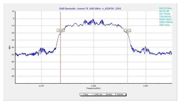
Fig.87. 20dB Bandwidth:  $\pi/4$  DQPSK, Channel 78
