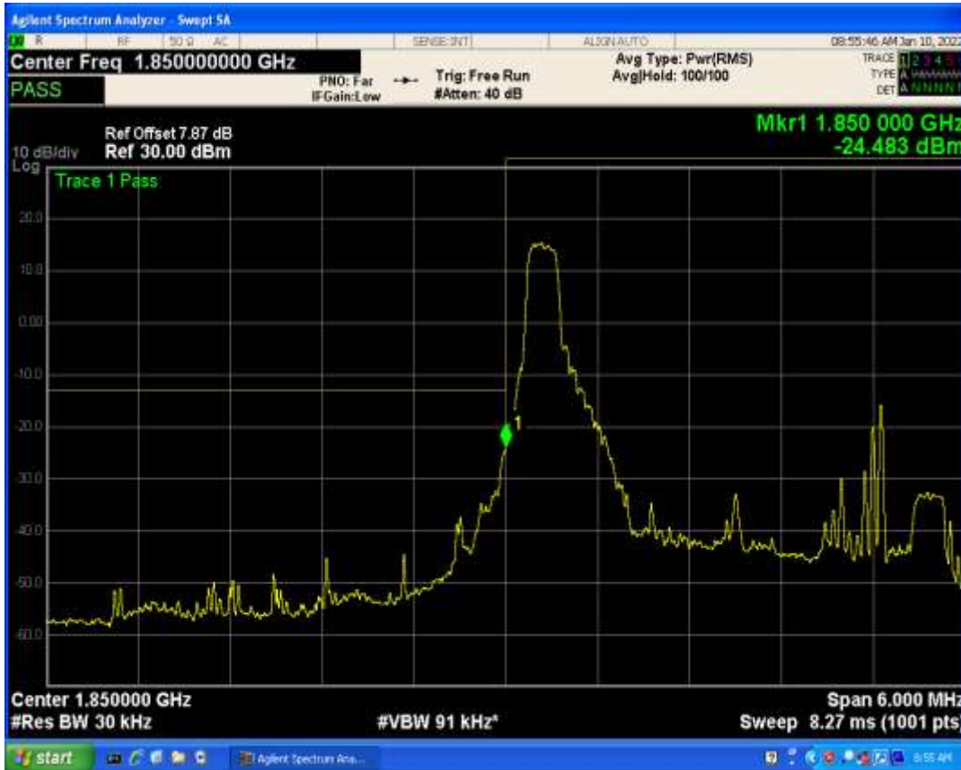
Band2 QPSK BW=20MHz Channel=18700 RB Size=100 Position=#0
