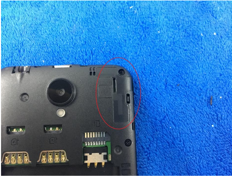
BT/WIFI/BLE/GPS - Antenna View
