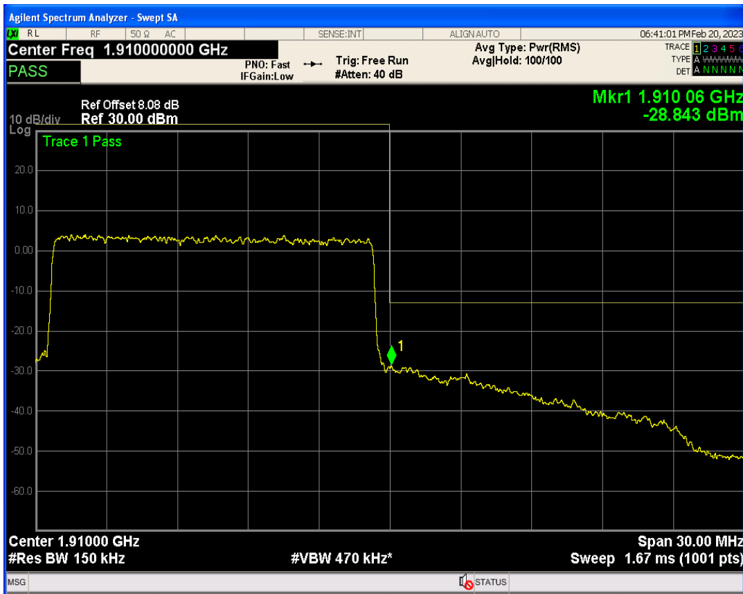
Band2 QPSK BW=20MHz Channel=18700 RB Size=1 Position=#0
