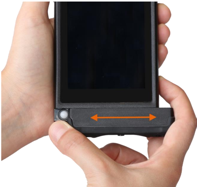
Fig. 50 : Fixation et retrait du module enfichable inférieur
