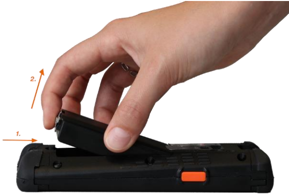
Fig. 34 : Retrait de la batterie rechargeable
