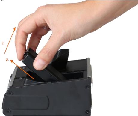
Fig. 45 : Retrait de la batterie rechargeable de remplacement de la station d'accueil
