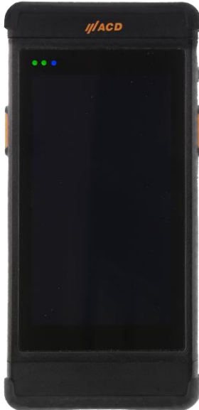
Fig. 42: Status LEDs of the M2Smart ® SE
