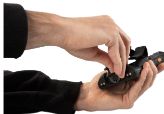
Fig. 37 : Détachement de l'œillet de la dragonne
