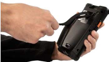
Fig. 36 : Ouverture de la fermeture Velcro de la dragonne
