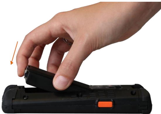
Fig. 35 : Insertion de la batterie rechargeable
