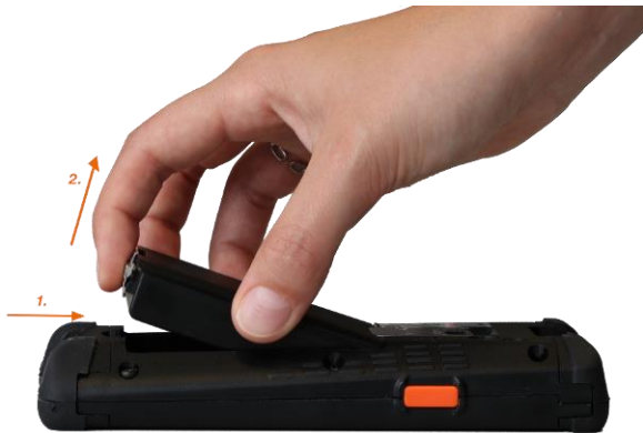
Fig. 34 : Retrait de la batterie rechargeable
