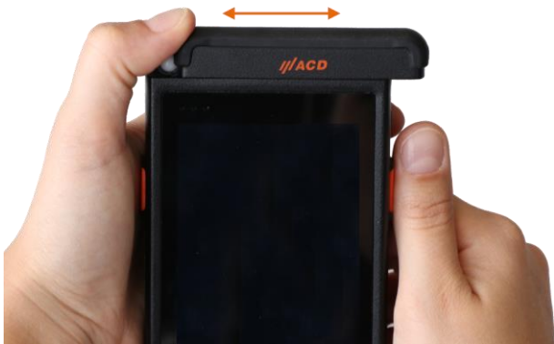
Fig. 49 : Fixation et retrait du module enfichable supérieur
