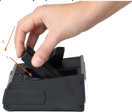
Fig. 44 : Insertion d'une batterie rechargeable de remplacement dans la station d'accueil
