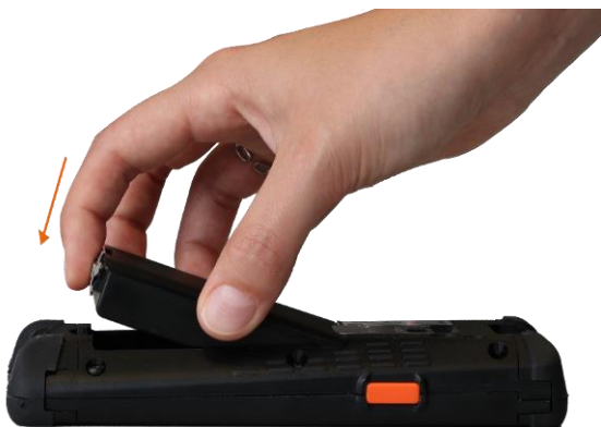
Fig. 35 : Insertion de la batterie rechargeable
