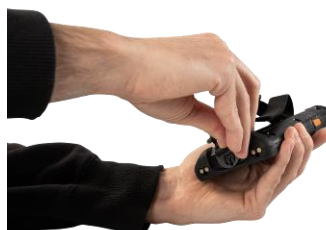
Fig. 37 : Détachement de l'œillet de la dragonne
