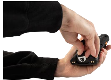
Fig. 40 : Fixation de l'œillet de la dragonne
