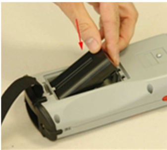
Figura 12: inserción de la batería
