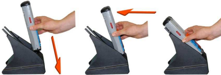
Figura 13: inserción del M210SE en la DS210
