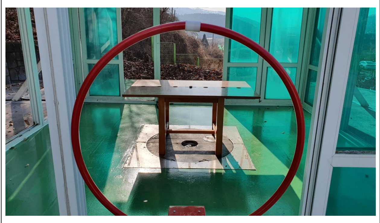
Test distance : 3 m, height of table : 0.8 m
