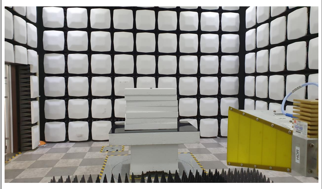
Test distance : 3 m, height of table : 1.5 m
