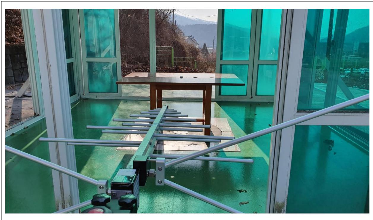
Test distance : 3 m, height of table : 0.8 m
