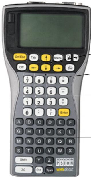
Steuertasten: Kontrast; Displaybeleuchtung; Ein-/Aus; Cursortasten
