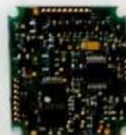
13.56MHz RFID module Type: HID OEM75
