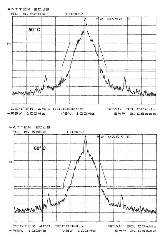
MASK: E, 1W SPECTRUM FOR EMISSION 3K42F1D **OUTPUT POWER: 1 Watts** 4800 bps
