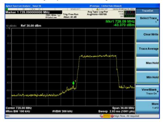
700MHz- LTE-64QAM one signal input down link-Upper Edge
