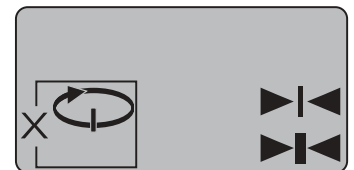
Laser de mise d'aplomb, mode de rotation, détecteur laser désactivé
