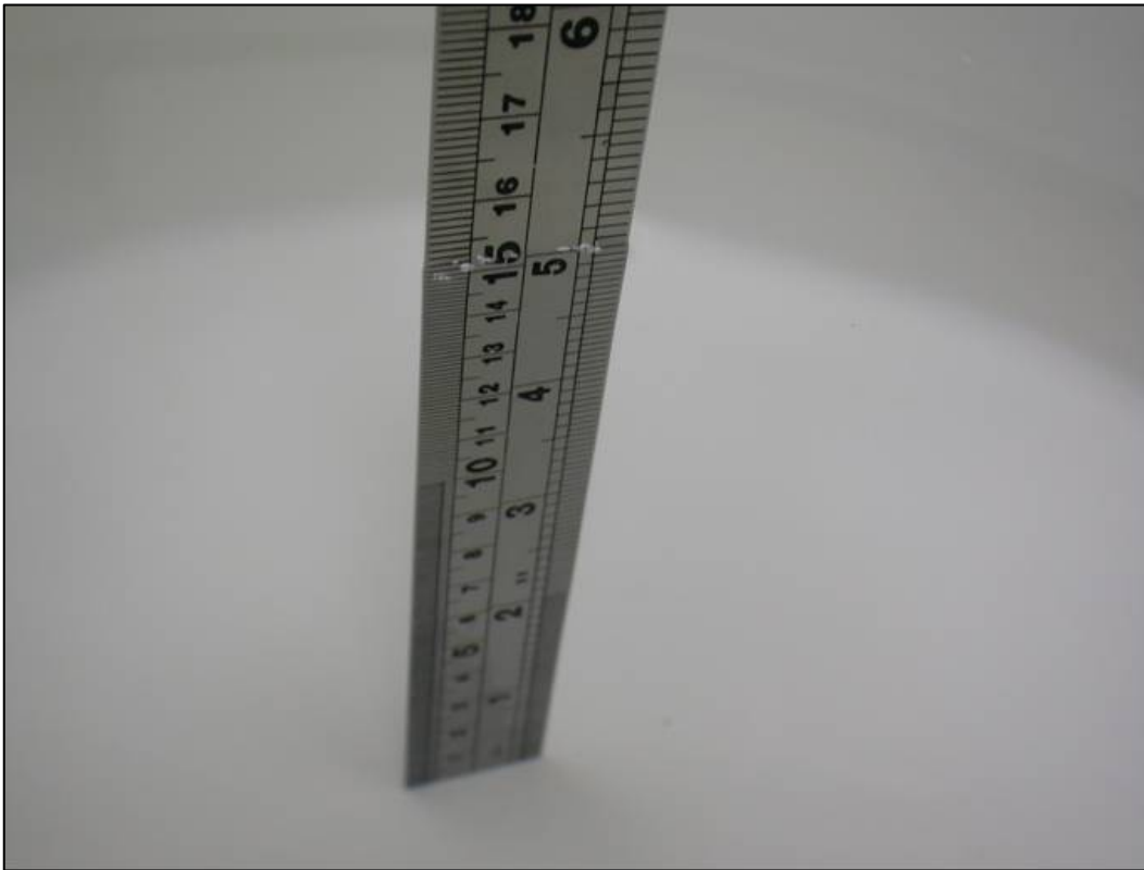
HSL 2450MHz D=152mm(WLAN)
