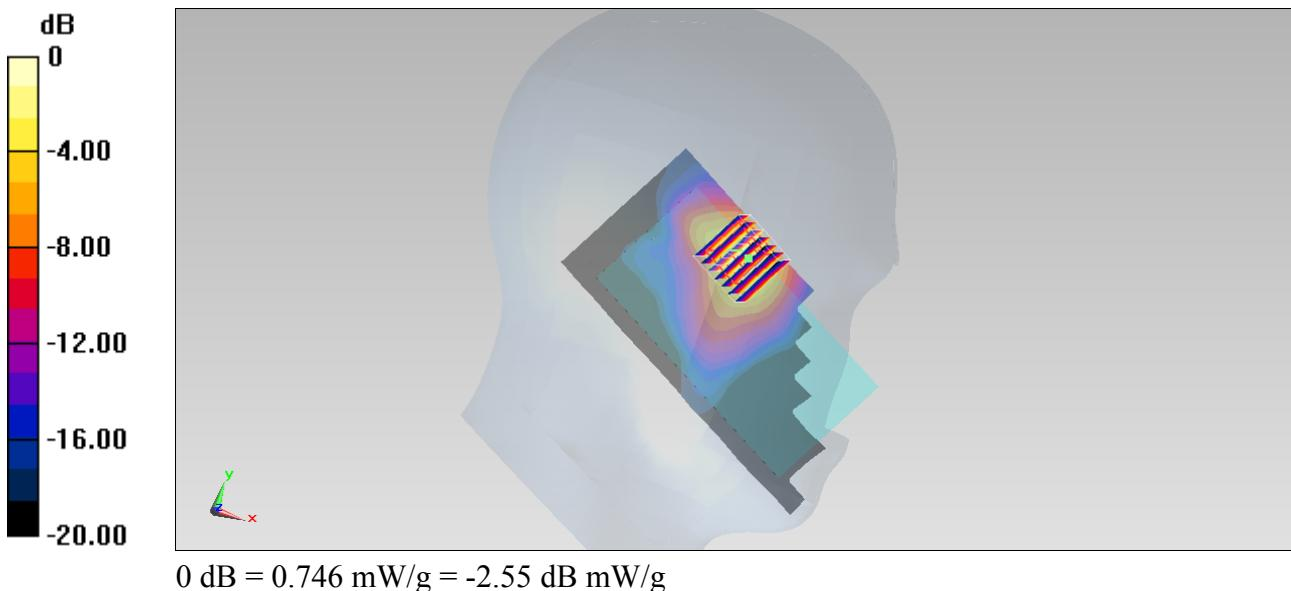
**#82\_WLAN2.4GHz\_802.11b 1Mbps\_Left Tilted\_Ch6****DUT: 370213**
