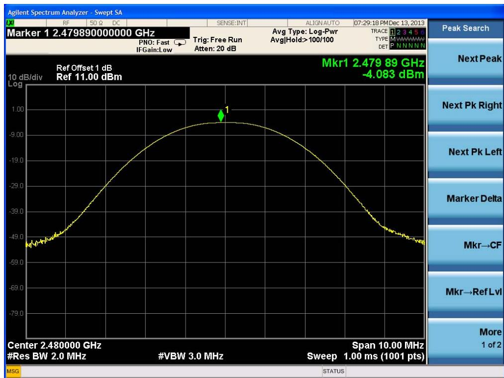
Remark : 1:RBW=2MHz VBW=3MHz PK detector for 8DPSK
