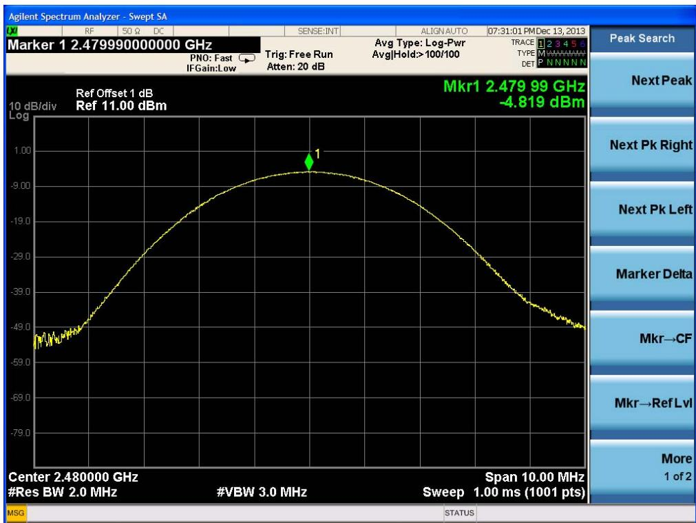
Remark : 1:RBW=2MHz VBW=3MHz PK detector for  $\pi/4$  DQPSK
