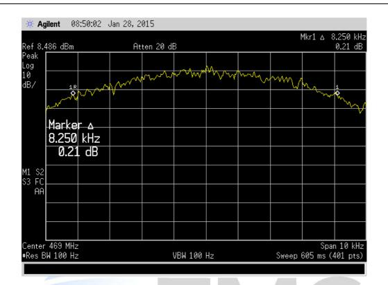
469.000 MHz F1D - 25.0 KHz spacing
