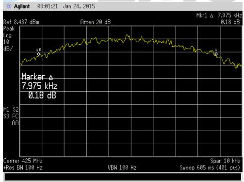
425.000 MHz F1D - 25.0 KHz spacing
