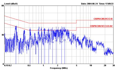
Site : CO04-HY Condition : CISPR/CNS/VCCI-B 2003 2001/004 LINE 0cm 0deg EUT : 802.11b IP Phone POWER: 110V/60Hz MODEL :未定 MEMO :
