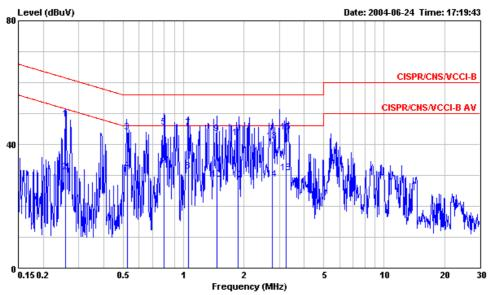
Site : CO04-HY Condition : CISPR/CNS/VCCI-B 2003 2001/004 NEUTRAL 0cm 0deg EUT : 802.11b IP Phone POWER: 110V/60Hz MODEL : 未定 MEMO :
