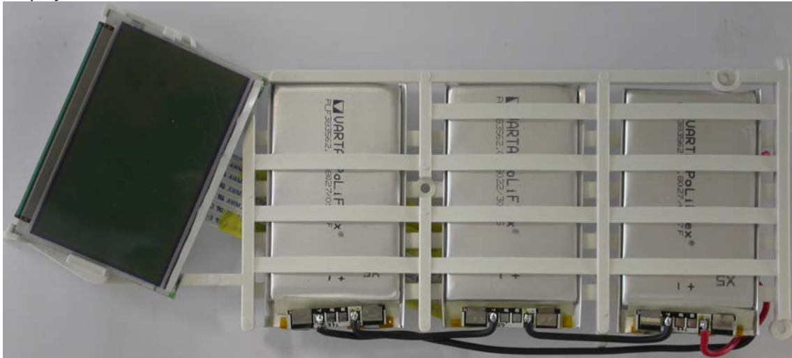
Battery & Display module:
