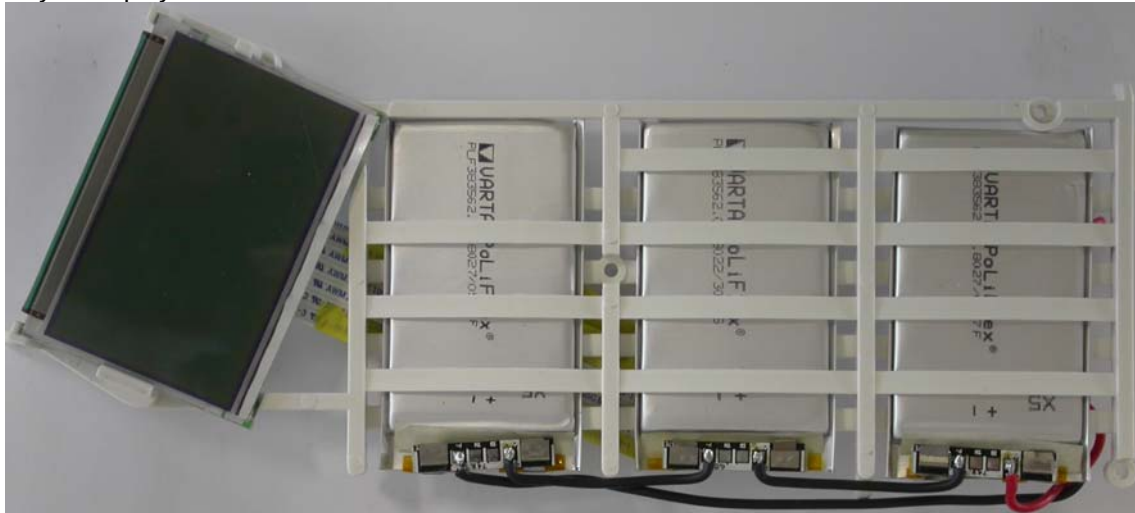
Battery & Display module:
