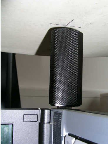
Fig. 4.7: Orientation 5 (Distance DUT «» phantom \leq 5\text{mm} )
