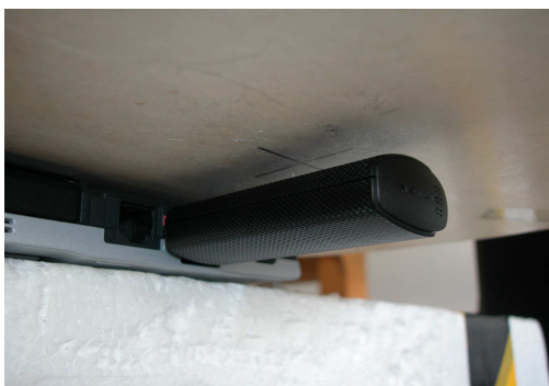
Fig. 4.3: Orientation 1 (Distance DUT «» phantom \leq 5\text{mm} )
