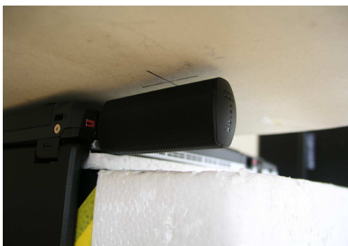
Fig. 4.5: Orientation 3 (Distance DUT «» phantom \leq 5\text{mm} )
