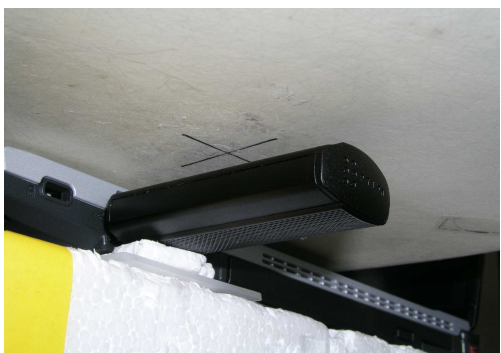
Fig. 4.4: Orientation 2 (Distance DUT «» phantom \leq 5\text{mm} )
