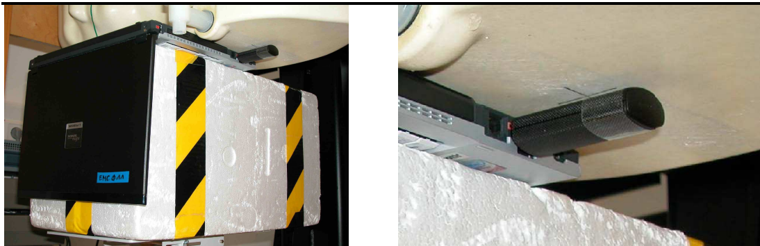
Fig. 4.3: Orientation 1 (Distance DUT «» phantom = 5mm)
