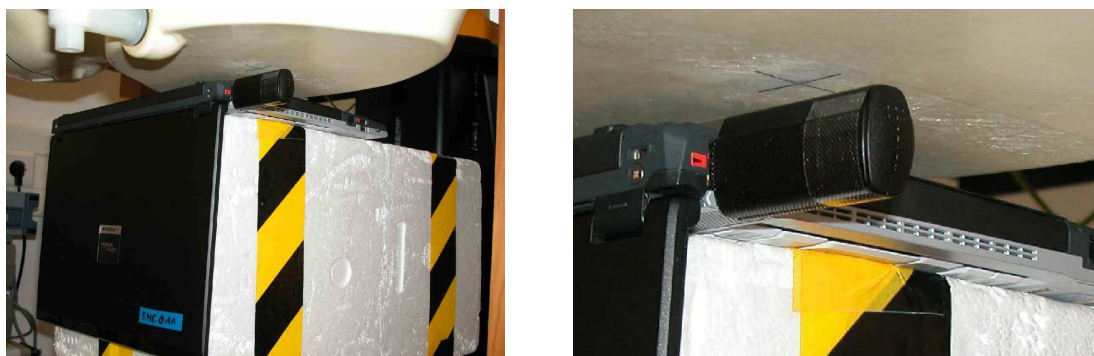
Fig. 4.5: Orientation 3 (Distance DUT «» phantom = 5mm)
