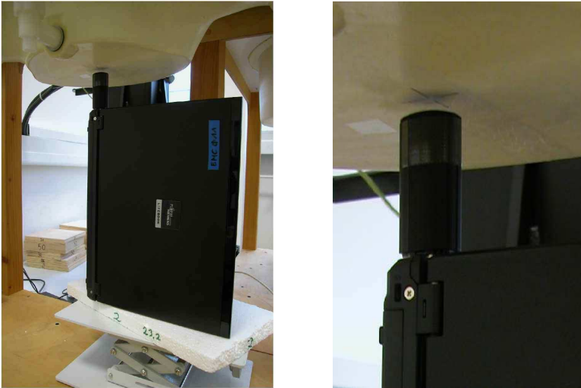
Fig. 4.7: Orientation 5 (Distance DUT «» phantom = 5mm)
