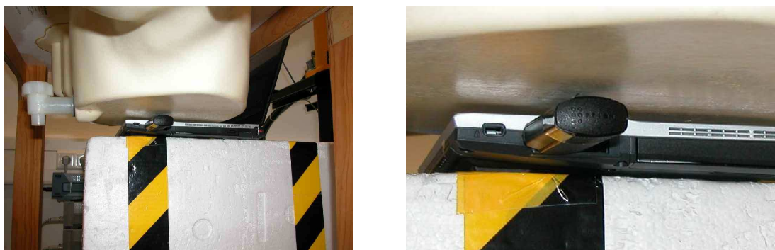
Fig. 4.4: Orientation 2 (Distance DUT «» phantom = 5mm)
