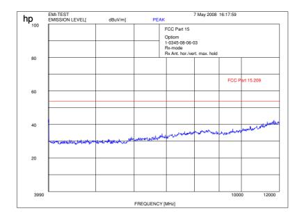
f < 1 GHz : RBW/VBW : 100 kHz  $f \ge 1 \text{GHz} : \text{RBW / VBW 1 MHz}$
