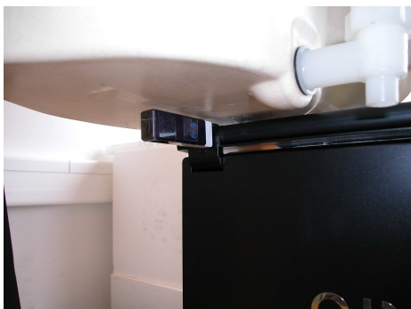
Fig. 4.5: Orientation 3 (Distance DUT «» phantom = 5mm)
