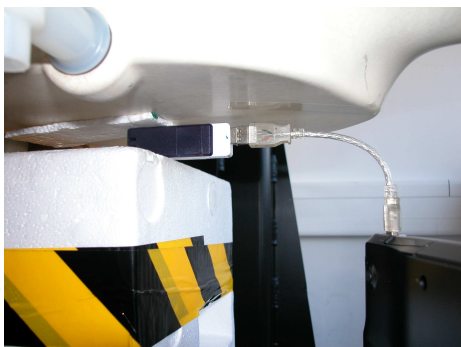
Fig. 4.6: Orientation 4 (Distance DUT «» phantom = 5mm)
