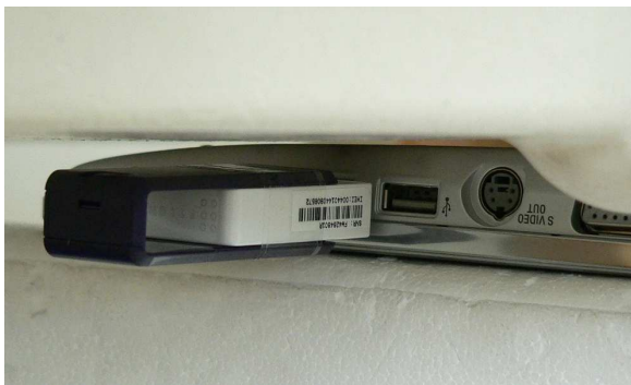
Fig. 4.3: Orientation 1 (Distance DUT «» phantom = 5mm)
