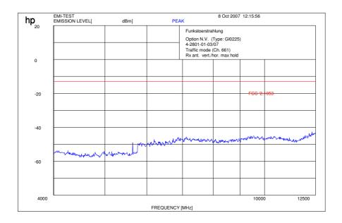
f < 1 GHz : RBW/VBW: 100 kHz  $f \ge 1GHz : RBW / VBW 1 \text{ MHz}$
