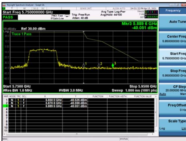
U-NII-3 ,Plot 1,Band Edge-802.11ac(40 MHz),5795MHz,Ant1
