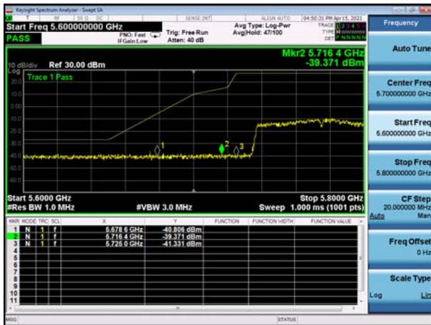
U-NII-3 ,Plot 1,Band Edge-802.11ac(40 MHz),5795MHz,Ant1
