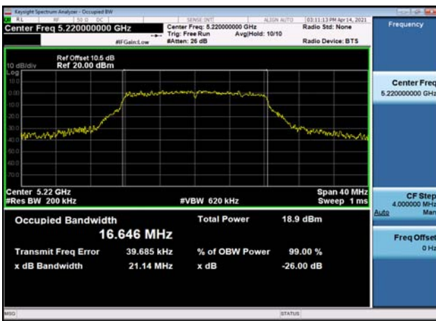
U-NII-1 26dB Bandwidth-802.11ac(20MHz) ,5180MHz,Ant1
