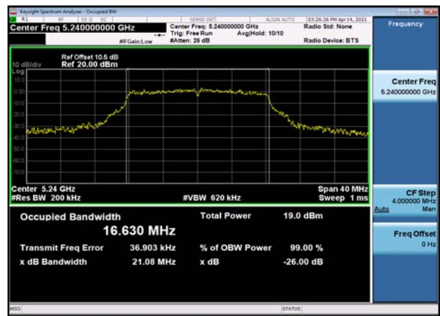
U-NII-1 26dB Bandwidth-802.11ac(20MHz) ,5220MHz,Ant1
