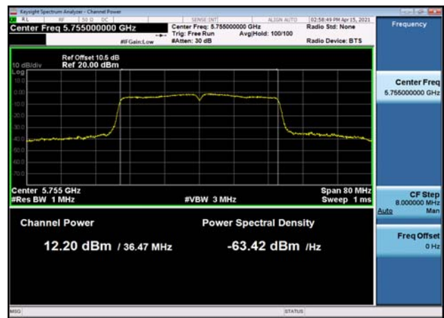
U-NII-3 Output Power-802.11n(40MHz) ,5755MHz,Ant1
