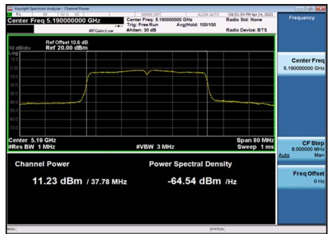
U-NII-1 Output Power-802.11ac(40MHz) ,5190MHz,Ant1
