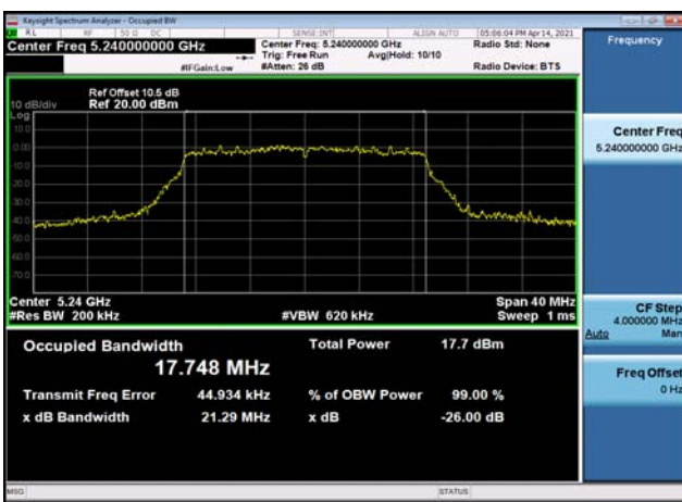
U-NII-1 26dB Bandwidth-802.11ac(20MHz) ,5240MHz,Ant1
