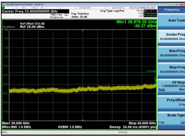
U-NII-1 ,Plot 2,26000MHz~40000MHz-802 .11ac(80MHz),5210MHz
