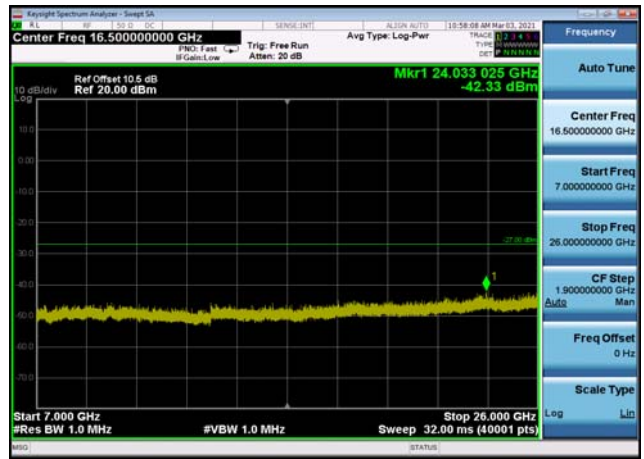
U-NII-1 ,Plot 4,7000MHz~26000MHz-802. 11ac(40MHz),5190MHz
