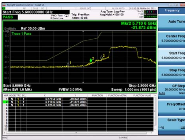
U-NII-3 ,Plot 1,Band Edge-802.11ac(80 MHz),5775MHz Left Side
